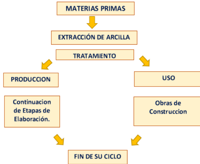
Figura 3. Procedimiento de elaboración de ladrillo tradicional
