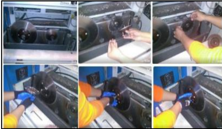
Figura 18. Cambio de cuchillas y calibración.
