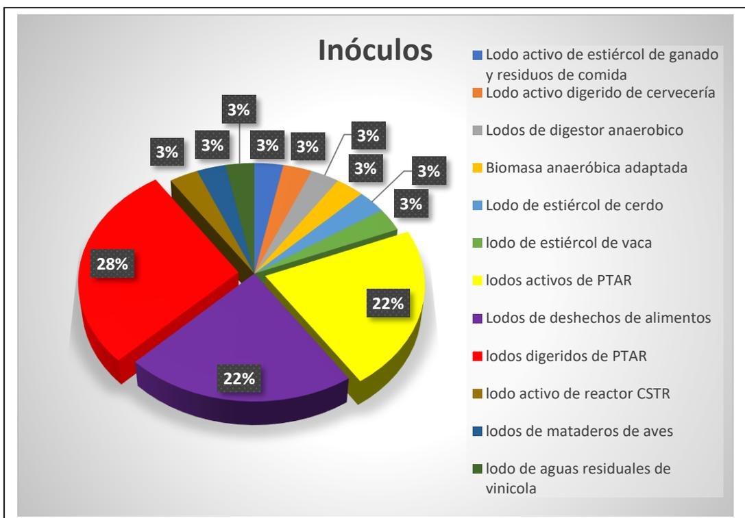
**Figura 13:** Tipos de inóculos que se usan con mayor frecuencia en co-digestión anaeróbica.
