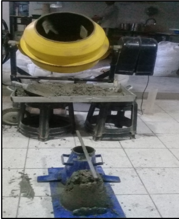
Figura: Prueba de slump para realizar la prueba de asentamiento
