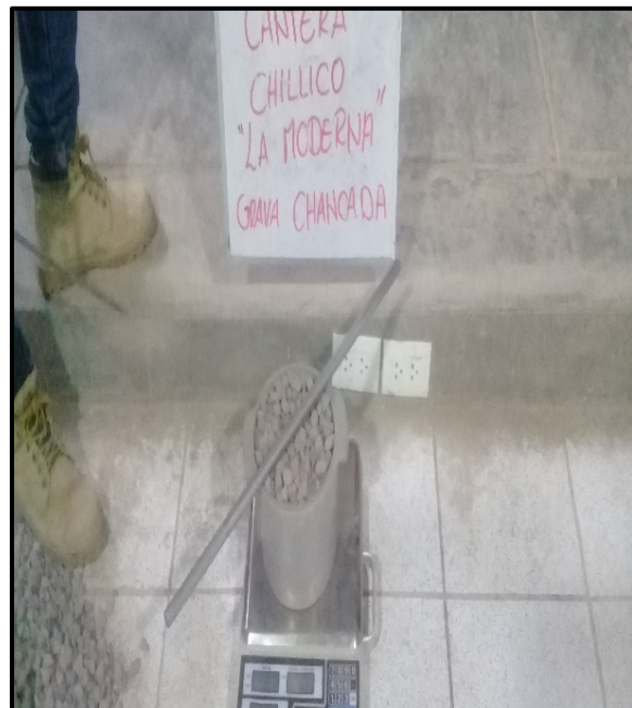
Figura: Ensayo de PUSC y PUCS del agregado grueso
