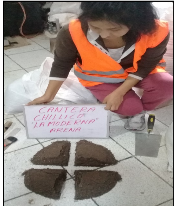
Figura: Ensayo de cuarteo del agregado grueso y del agregado fino
