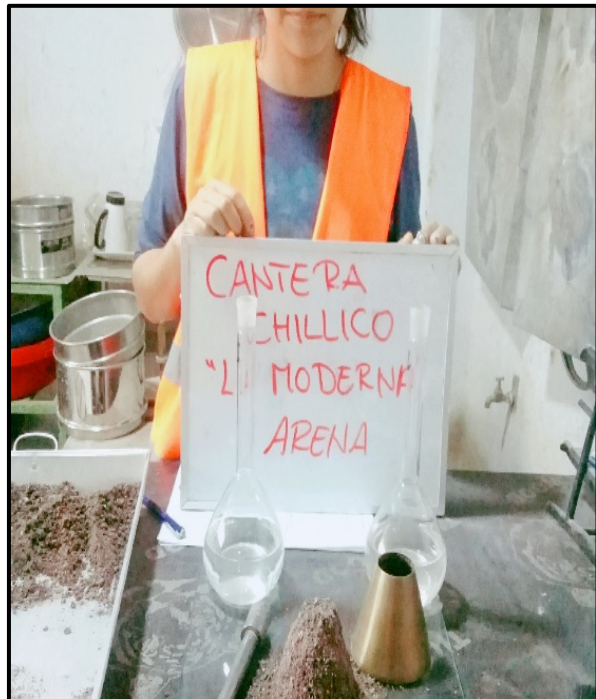
Figura: Ensayo del peso específico del agregado fino
