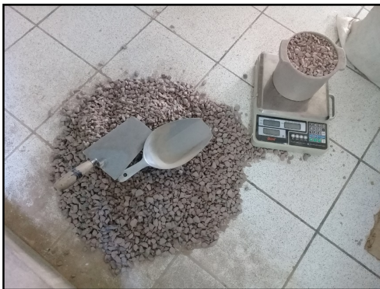
Figura 7: Ensayo del P.U.S.S del agregado grueso.
