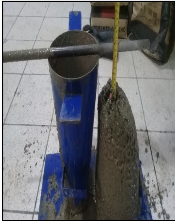
Figura: Prueba de slump para realizar la prueba de asentamiento
