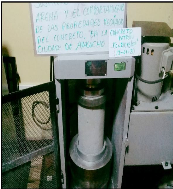
Figura: Rotura de probeta a los 7, 14, 21 y 28 días para determinar la compresión axial
