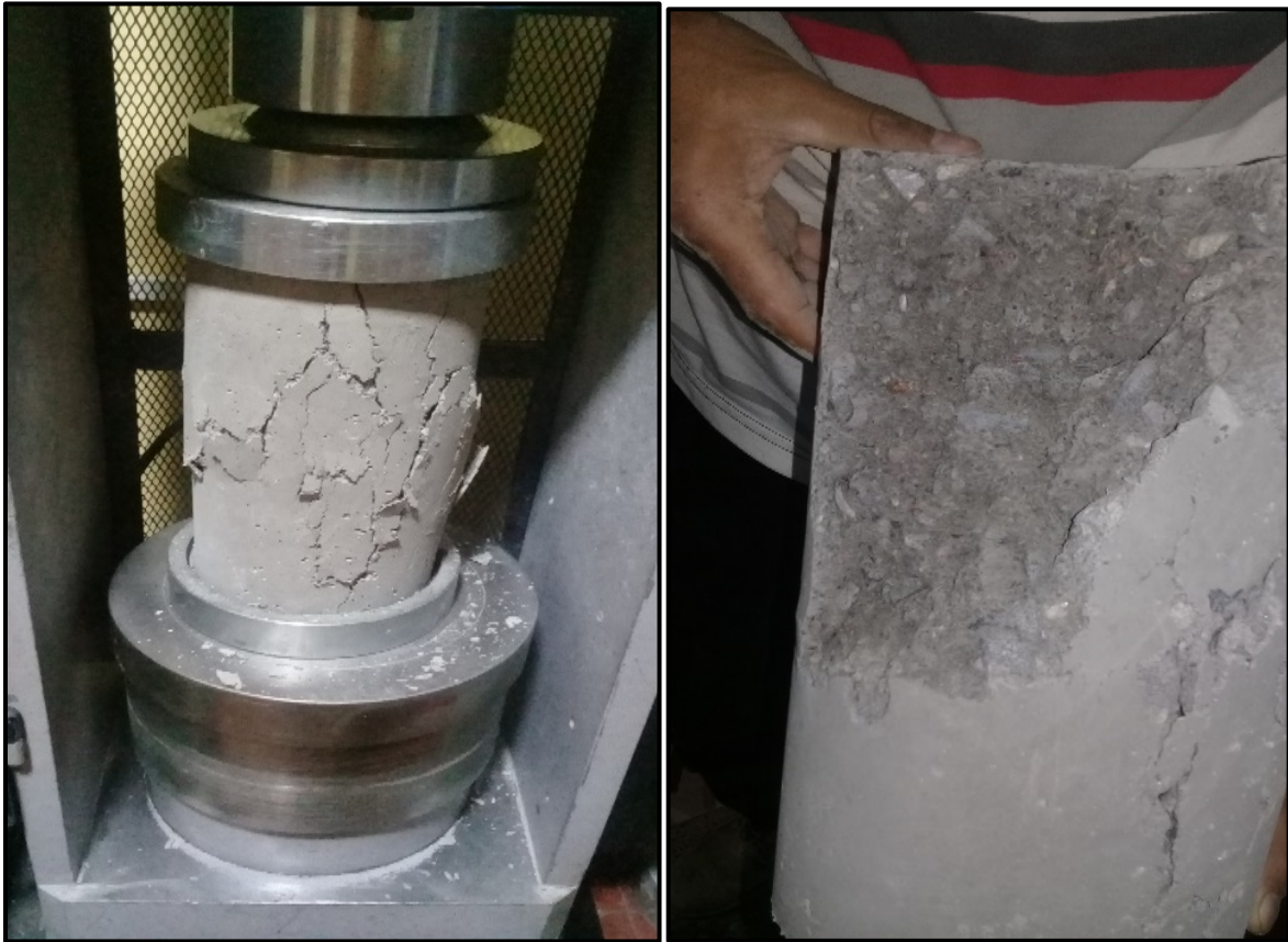
Figura: Probetas después de la rotura.
