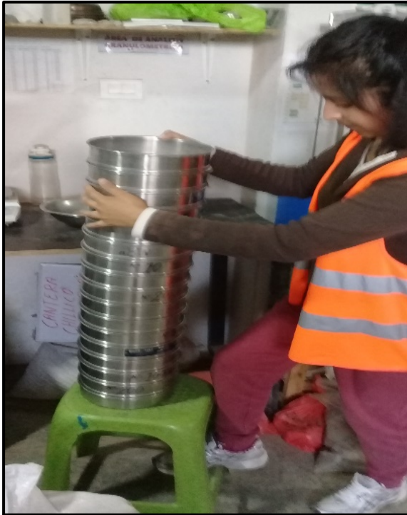
Figura: Ensayo de granulometría de los agregados
