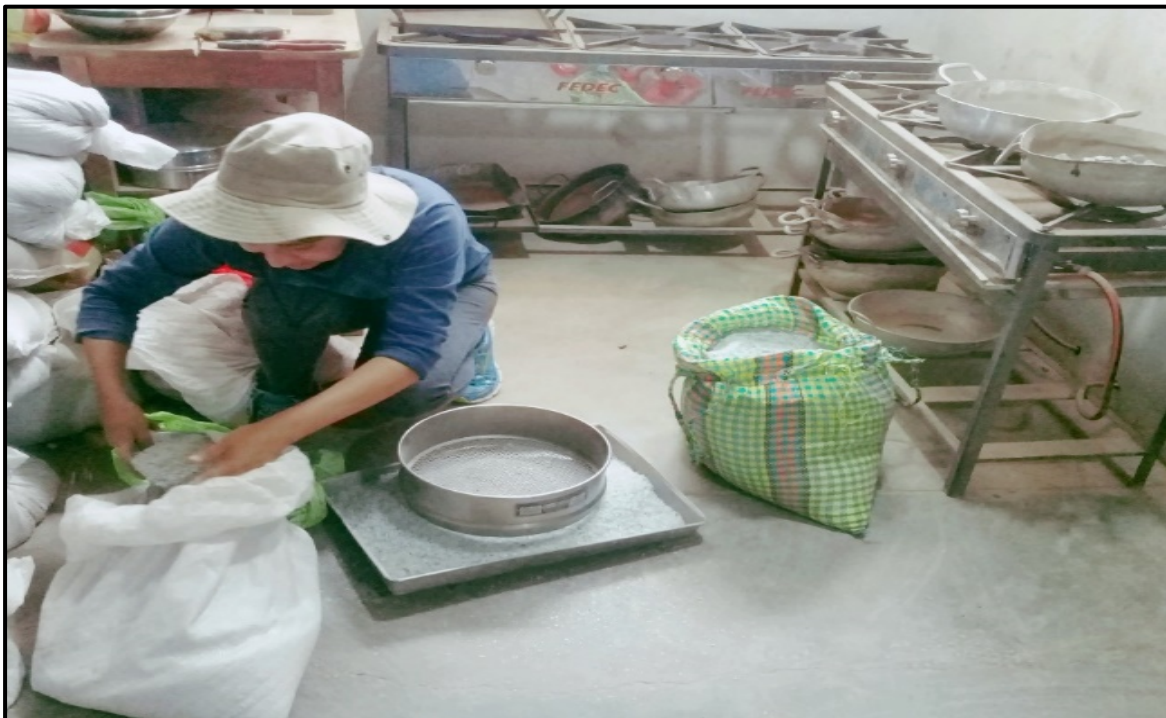
Figura: Tamizado del plástico PET reciclado
