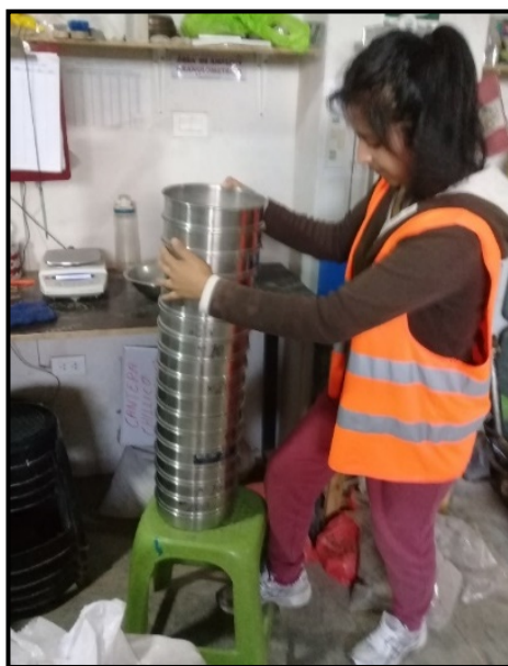
Figura 8: Ensayo granulométrico del A.F.
