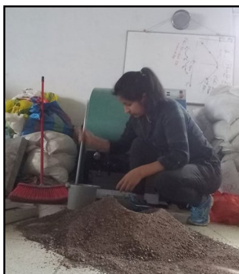
Figura 11: Ensayo del P.U.C.S del agregado fino.
