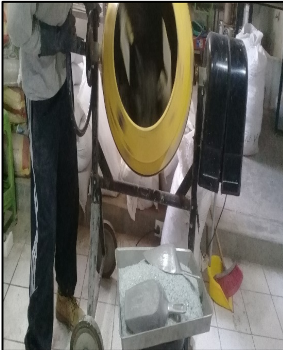
Figura: Preparación del concreto f'c=210 \text{ kg/cm}^2
