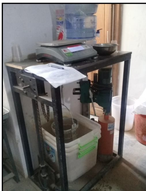
Figura 6: Ensayo del peso específico del A.G.
