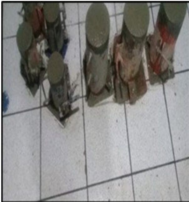
Figura: Concreto en estado fresco f'c=210 \text{ kg/cm}^2
