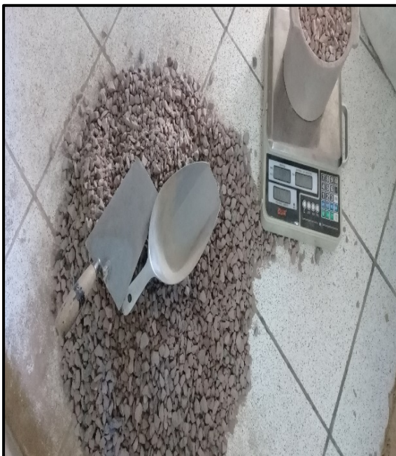
Figura: Ensayo de PUSC y PUCS del agregado grueso
