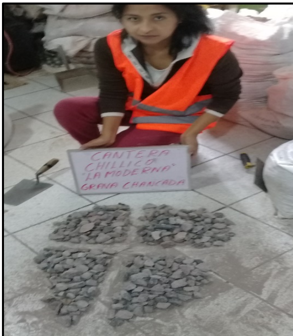
Figura: Ensayo de cuarteo del agregado grueso y del agregado fino
