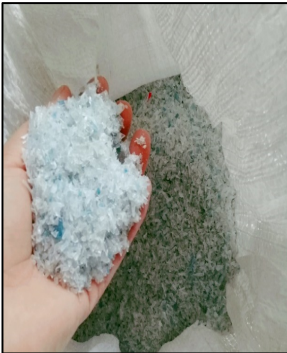
Figura: Muestra de plástico PET reciclado triturado Fuente: Elaboración propia – 2021
