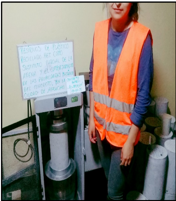
Figura: Rotura de probeta a los 7, 14, 21 y 28 días para determinar la compresión axial
