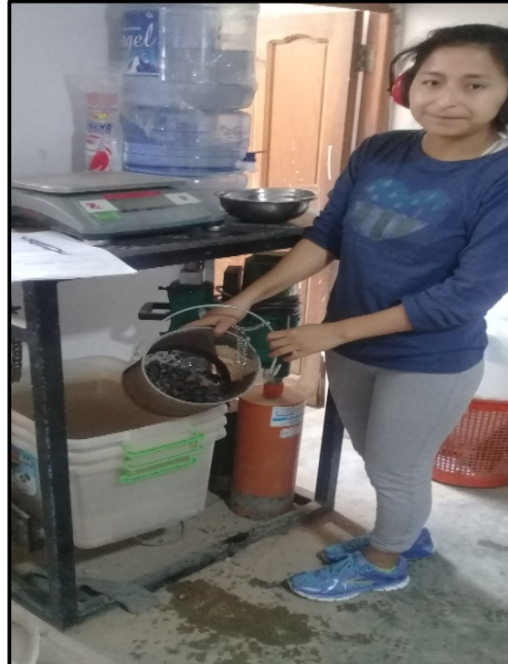
Figura: Ensayo del peso específico del agregado grueso
