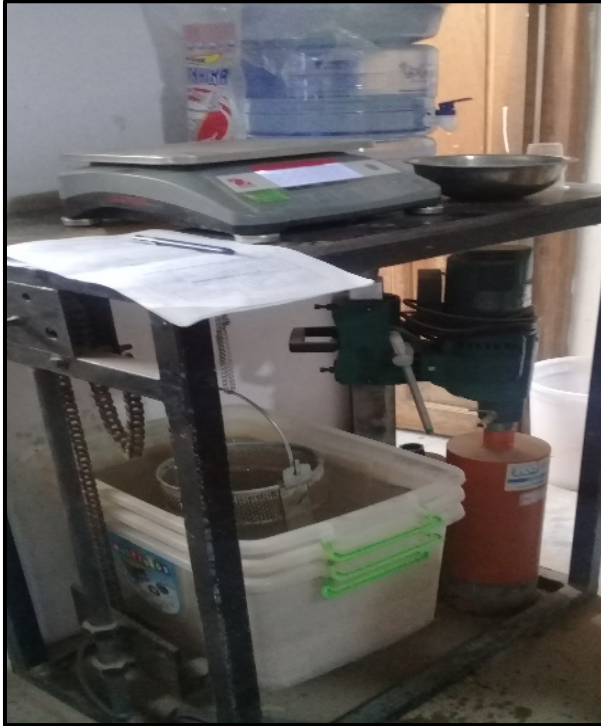
Figura: Ensayo del peso específico del agregado grueso
