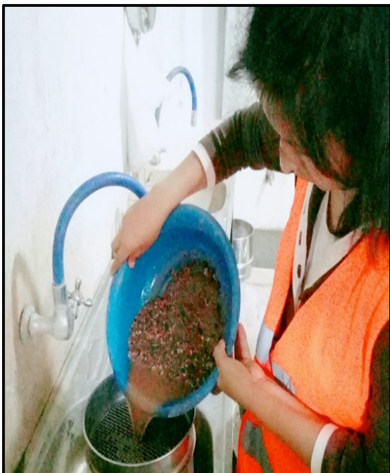
Figura: Lavado y secado del agregado grueso y fino
