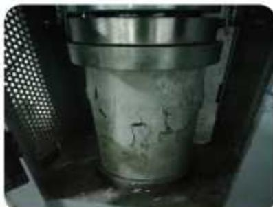
Ruptura del 3er día de Edad son Seis Testigos y de las que todas muestran fisuras grandes pero buen porcentaje de resistencia en ambas canteras.
