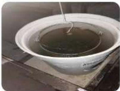
Cada Material se Satura y pesa con la balanza donde se muestra en la imagen para así obtener los materiales gruesos saturados.
