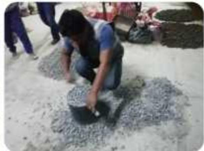
Varillado y compactado con 25 golpes de la varilla por cada 3 capas del molde por cada cantera en 3 pruebas (Dos de Mayo).
