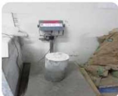
Se saca del agua y se pone a secar por 7 a 14 horas y medimos sus áreas y diámetro del cilindro y procedemos a pesar en la balanza cada uno. Este procedimiento es para
