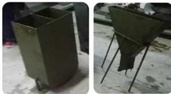
Se puede mostrar la Caja en U y el Embudo V, para su respectivo ensayo.
