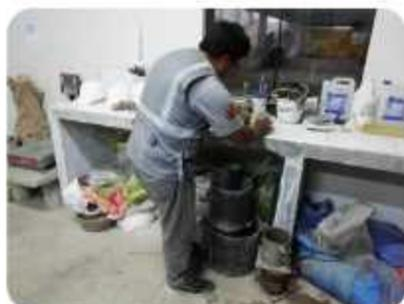
Examinamos la absorción que se obtuvo y pesamos cada muestra del agregado fino para ambas canteras Recuay y Dos de mayo.
