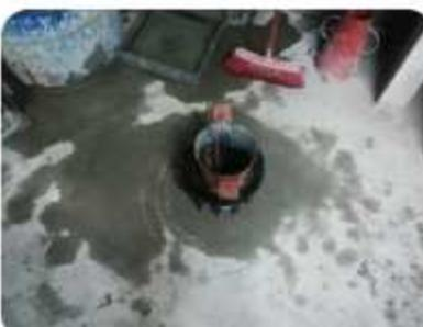
Ensayo con el Aro Japonés buscando la expansión de la mezcla por cada una de las canteras, para verificar se muestra un trazo en el piso.
