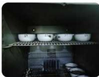
6. Se muestra las cuatro muestras de Agregado Grueso y Fino en horno para análisis contenido de Humedad por cantera.
