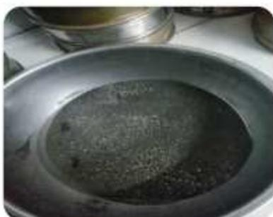
En cuanto al Agregado Fino para ambas canteras se lava el material antes de ser tamizado y debe de estar bien seco para la Granulometría.
