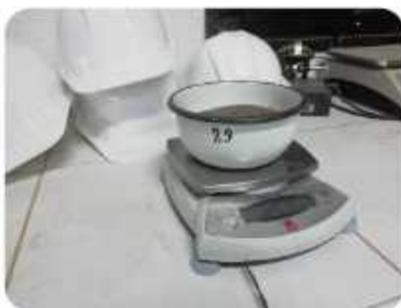
7. Una vez secado el material se pesa para sacar el contenido de Humedad que hubo en cada material por cada cantera.
