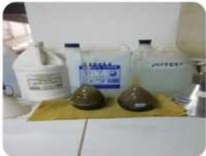
Una vez realizada el proceso de soporte se llena la arena en la fiola sumergiendo el material en agua por 24 horas para ambas canteras.
