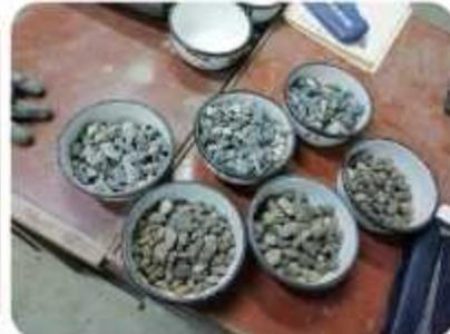
Una vez saturado el material se pone al horno durante 24 horas y así poder pesarlo así conociendo la Absorción del Material grueso.
