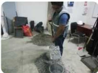
Se procede realizar el ensayo de Peso Unitario en esta imagen el Peso Suelto de Agregado fino y Grueso de cantera Recuay y Dos de mayo.
