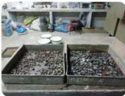
Para sacar el peso específico y la absorción tenemos materiales pesados en diferentes recipientes y lavados. Esto deberían secarse por totalidad al aire.
