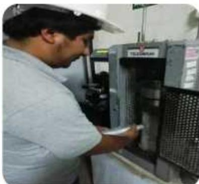
El día 28 en su edad se hizo la ruptura correspondiente y se muestra con un equipo adicional el Esclerómetro comparando la resistencia.
