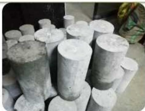
Las rupturas de los 28 días se presentan sin fisura alguna en ninguna de las probetas, en la resistencia de Recuay es menor que la de Dos de Mayo.
