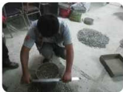
Llenado, varillado y Limpieza de molde con una regla arrastrando el pasante, de cada cantera así como se muestra en la imagen. (Recuav)
