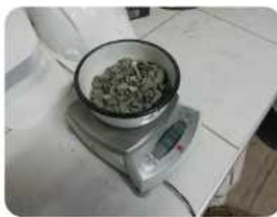
5. Separación de material en recipiente para muestra de contenido de Humedad primera imagen Agregado Fino de Recuay y la siguiente Agregado Grueso de Dos de Mayo.
