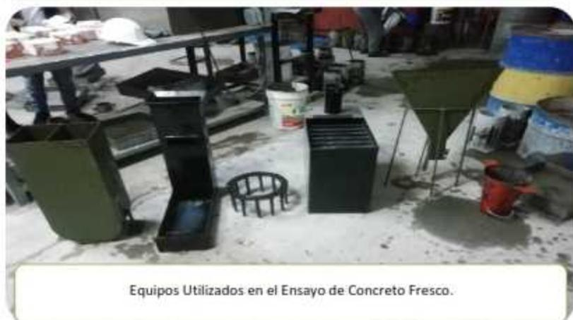
Equipos Utilizados en el Ensayo de Concreto Fresco.
