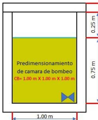
Figura 39. Predimensionamiento de Cámara de Bombeo de Desagüe.
