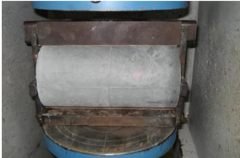
Figura 7. Ensayo de Compresión Diametral
