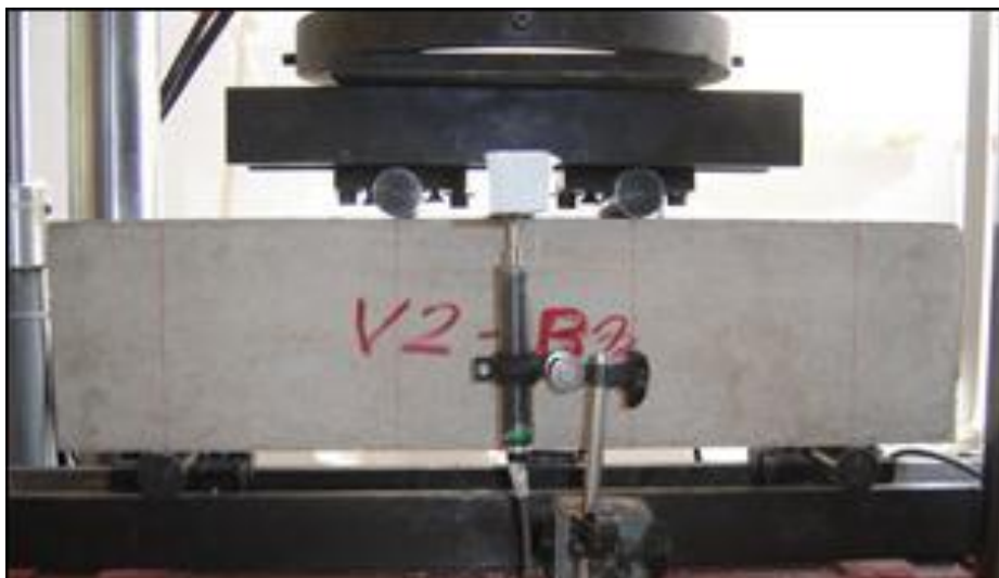
Figura 8. Ensayo de Flexión en vigas
