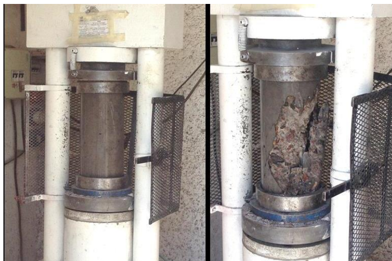
Figura 6. Ensayo de Compresión Axial
