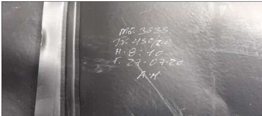
Figura 48: Codificación de soldadura por termofusión
