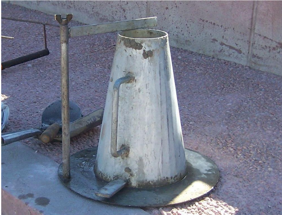
Figura 3. Cono de Abrams con todos sus elementos: el molde troncocónico, un asa y la plancha de sujeción.
