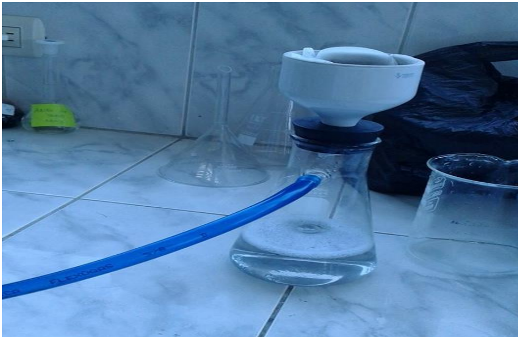
Fotografía e Imagen 10: Filtrado de muestra de INVERSIONES HAROD S.A.C
