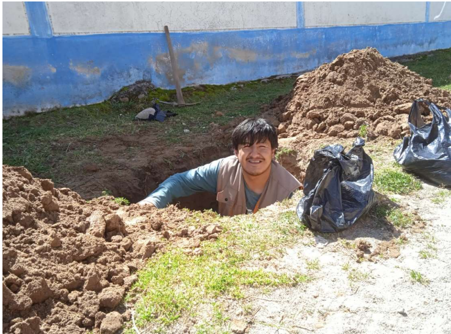
Figura 22. Extracción de muestras en calicatas
