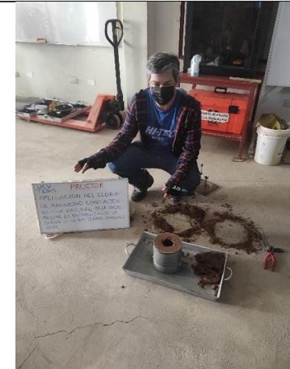
Retirando la parte central del molde para determinar la densidad húmeda
