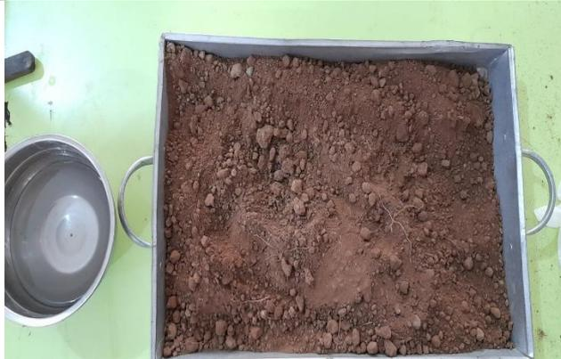
Cloruro de magnesio disuelto en agua para agregarle a la muestra para el ensayo de CBR
