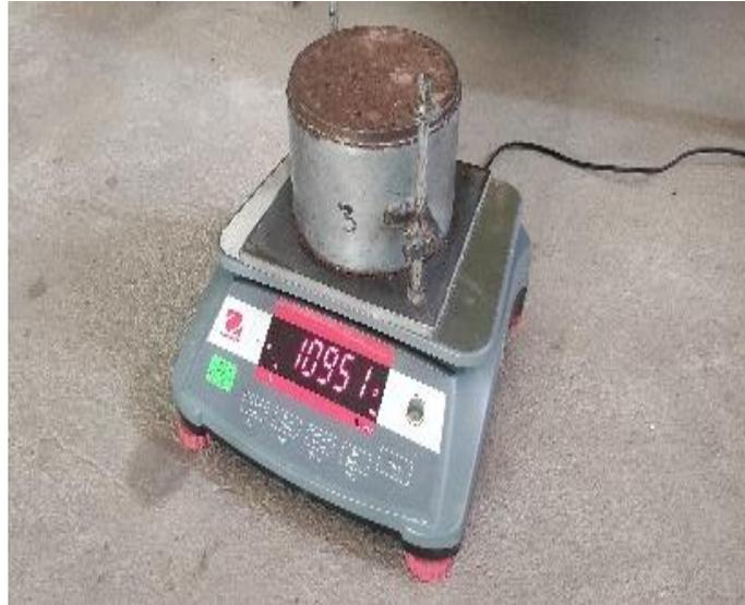
Figura 26. Peso del molde + material compactado
