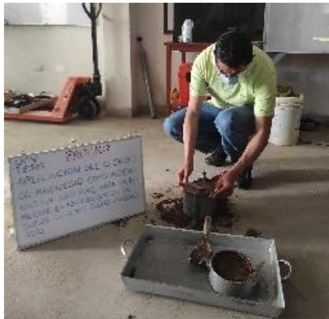
Figura 27. Extracción del material compactado
