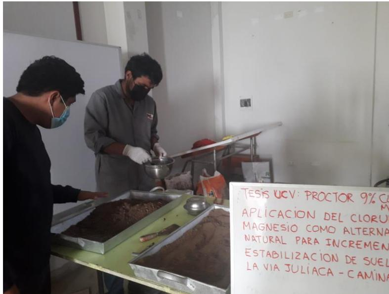
*Figura 28.* Moldeado de la muestra para el ensayo de CBR
