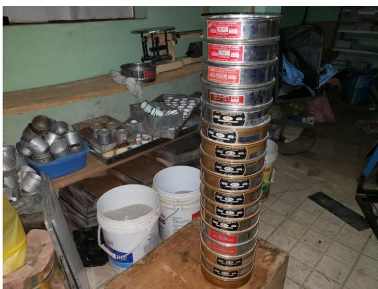
*Figura 13.* Tamices para el ensayo de granulometría
