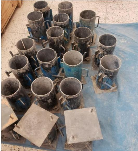
*Figura 25. Moldes de briquetas*
