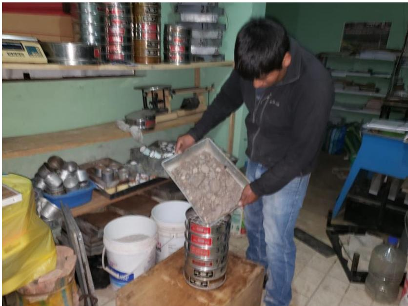
*Figura 15.* Ensayo de granulometría partículas finas.
