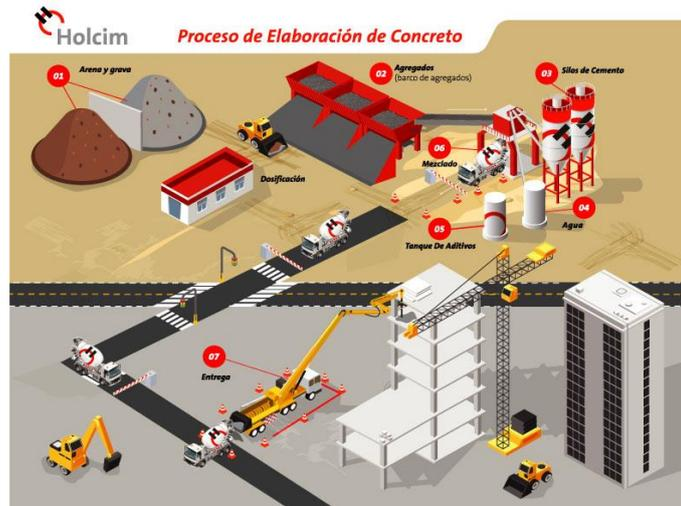
*Figura 5. Proceso de elaboración del concreto*
