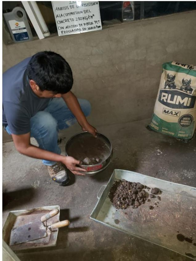
Figura 17. Ensayo de granulometría partículas gruesas.
