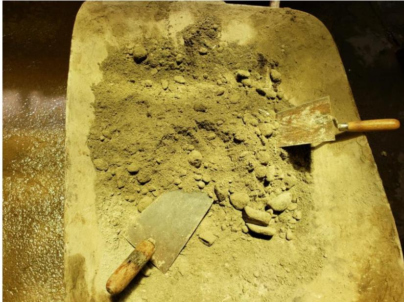
*Figura 23.* Mezcla de áridos, cemento, PET
