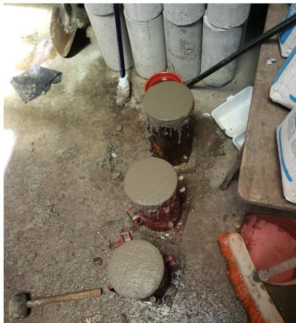
*Figura 26. Briquetas de concreto hidráulico*
