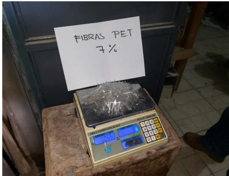
*Figura 21.* Dosificación de las fibras PET recicladas.
