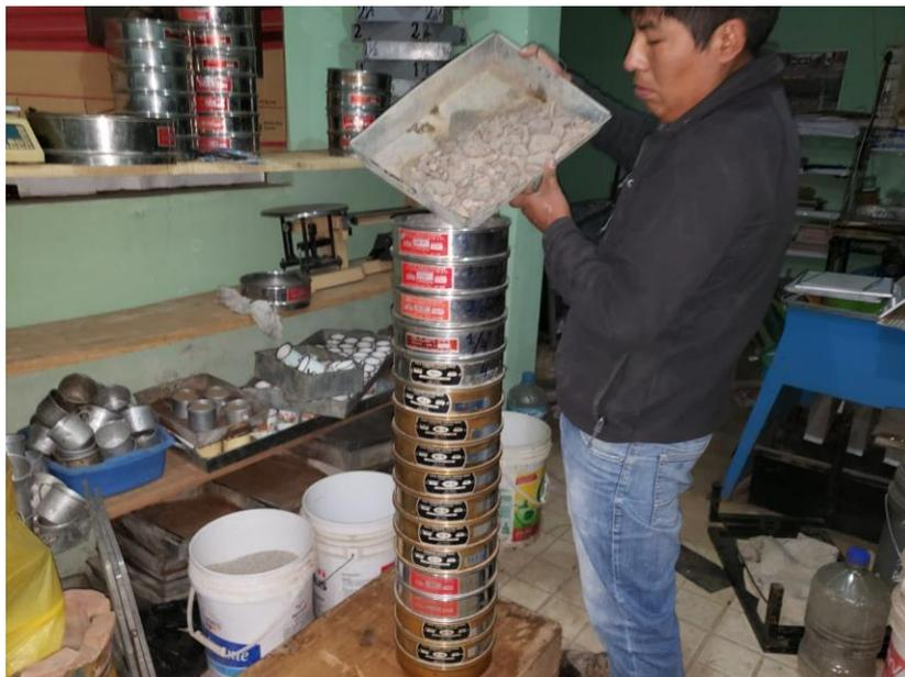
*Figura 16.* Ensayo de granulometría partículas gruesas.
