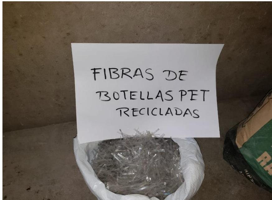
Figura 19. Fibras PET a ser empleadas dentro del diseño de mezclas.
