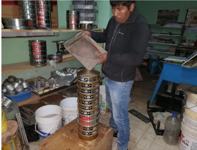
*Figura 14.* Ensayo de granulometría partículas finas.
