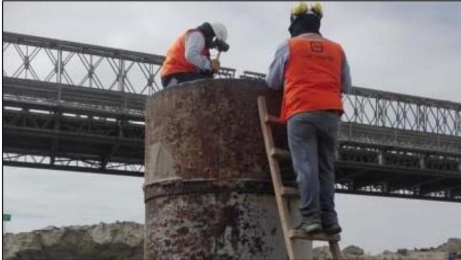
**Figura 44.** Prueba PIT, Dynamic Control Perú S. A.
