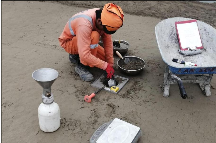
**Figura 72.** Ensayo de densidad en campo.
