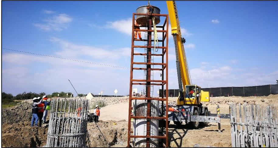
**Figura 51.** Prueba de carga dinámica en pilotes PDA.
