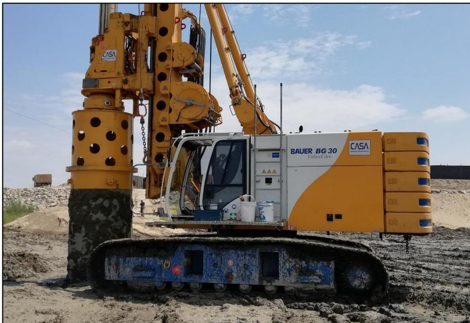
**Figura 34.** Piloteadora hidráulica Bauer BG 30.
