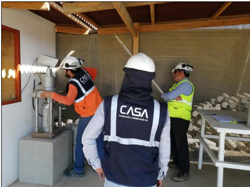
Prueba de resistencia a la compresión del concreto juntamente con la supervisión
