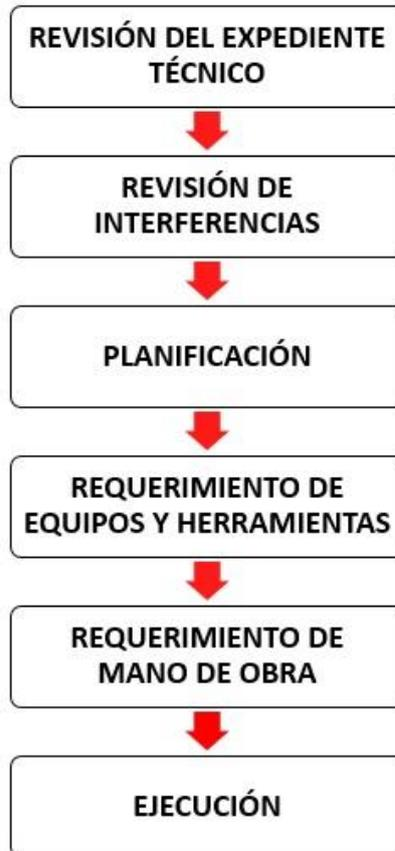
**Figura 18.** Esquema de los trabajos previos a la ejecución de obra.
