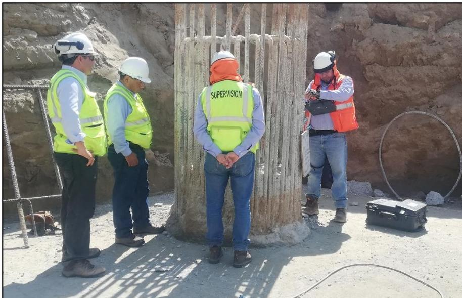
**Figura 45.** Prueba PIT en pilotes.
