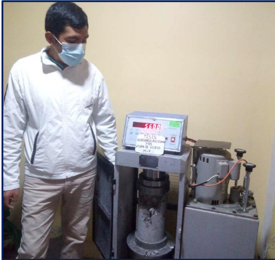
Imagen N° 17 Realizando las pruebas de resistencia a compresión.
