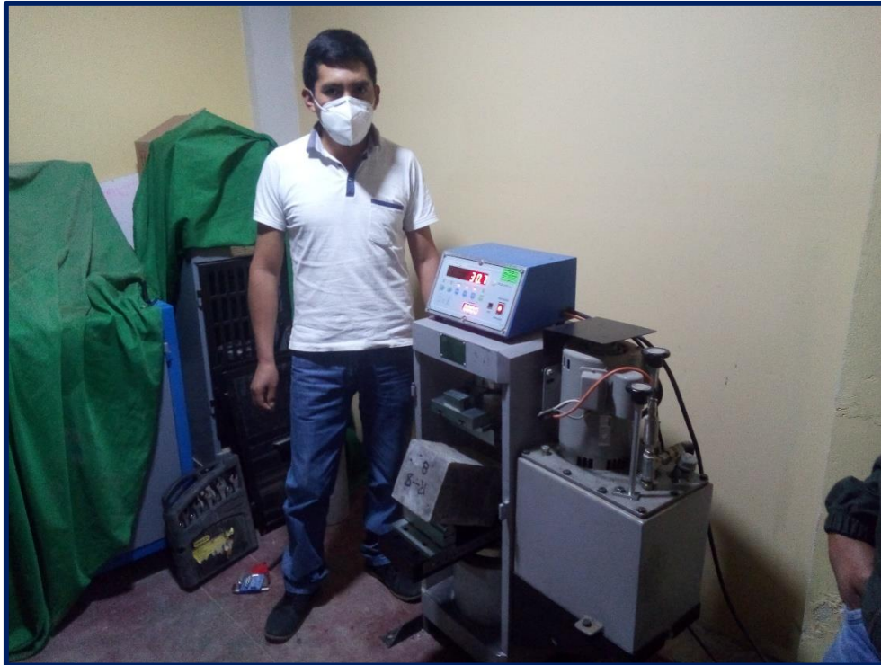
Imagen N° 15 Realizando las pruebas a flexión en las vigas.
