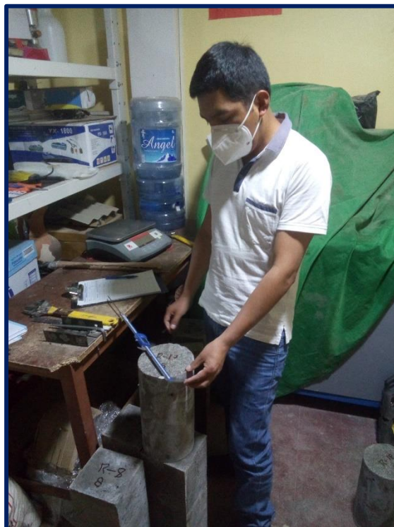
Imagen N° 16 Toma de datos de las dimensiones de las probetas cilíndricas para las pruebas de compresión.
