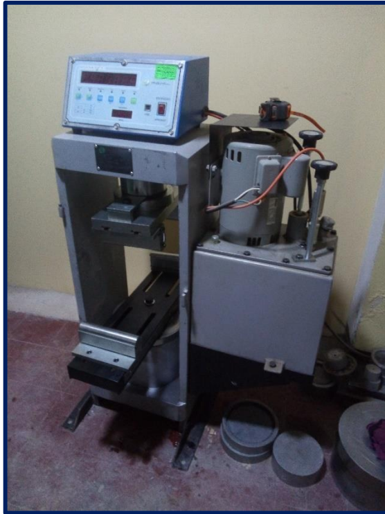
Imagen N° 13 Equipo para realizar los ensayos de resistencia a flexión en las vigas.
