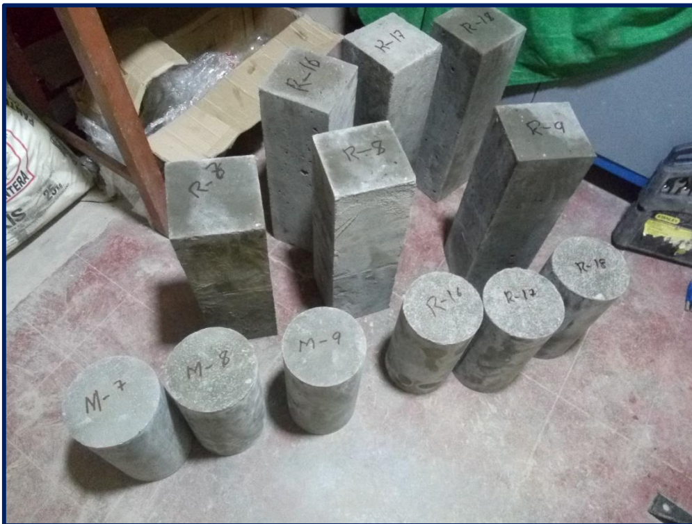
Imagen N° 12 Probetas cilíndricas y vigas para los ensayos de compresión y flexión.
