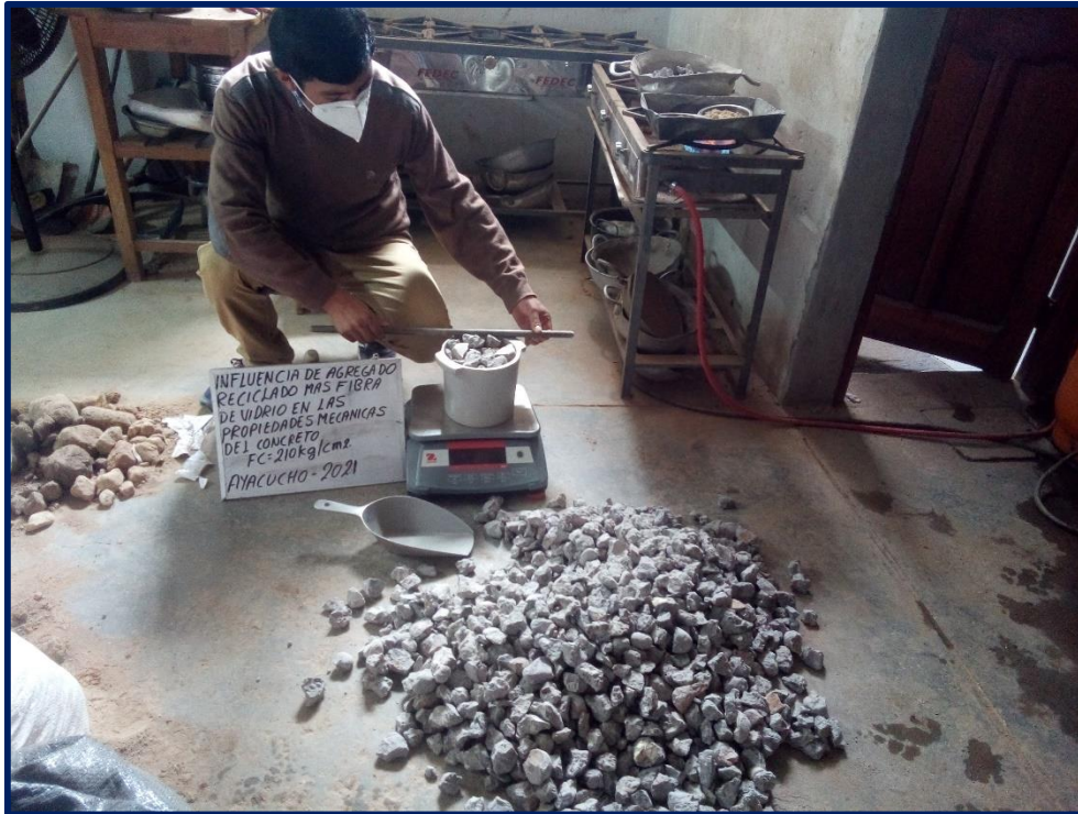
Imagen N° 9 Pesado de muestra para determinar peso específico.
