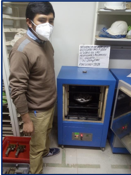
Imagen N° 11 Secado de muestra en horno para determinar contenido de humedad.
