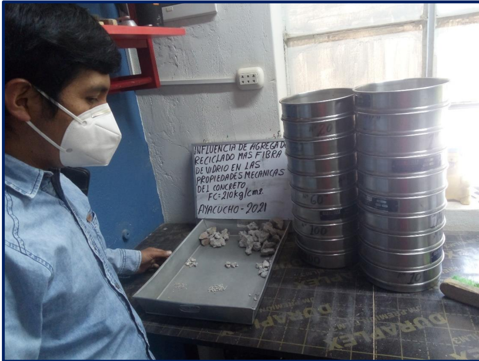
Imagen N° 5 Análisis granulométrico del agregado reciclado.
