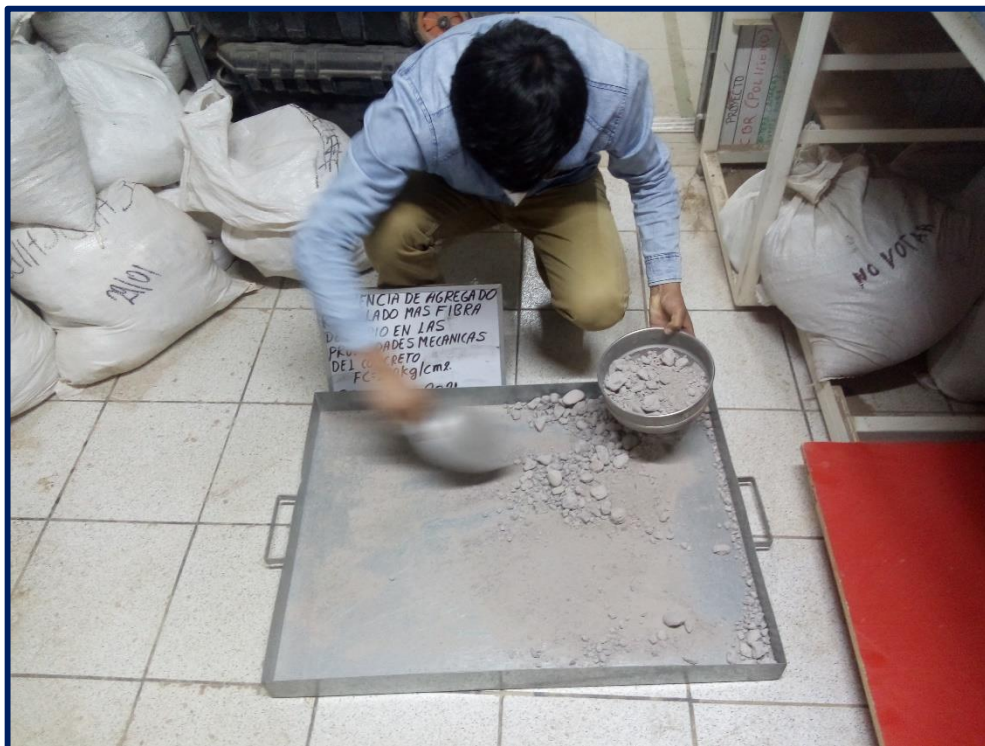
Imagen N° 8 Zarandeado para determinar el porcentaje de abrasión.
