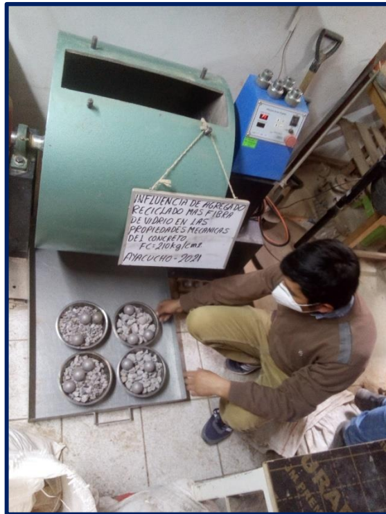
Imagen N° 7 Ensayo de abrasión de los ángeles.
