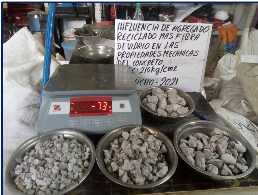
Imagen N° 6 Tara de muestra para determinar abrasión.
