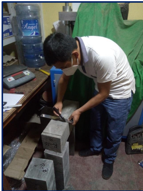
Imagen N° 14 Toma de datos y marcado de las vigas para el ensayo a flexión.
