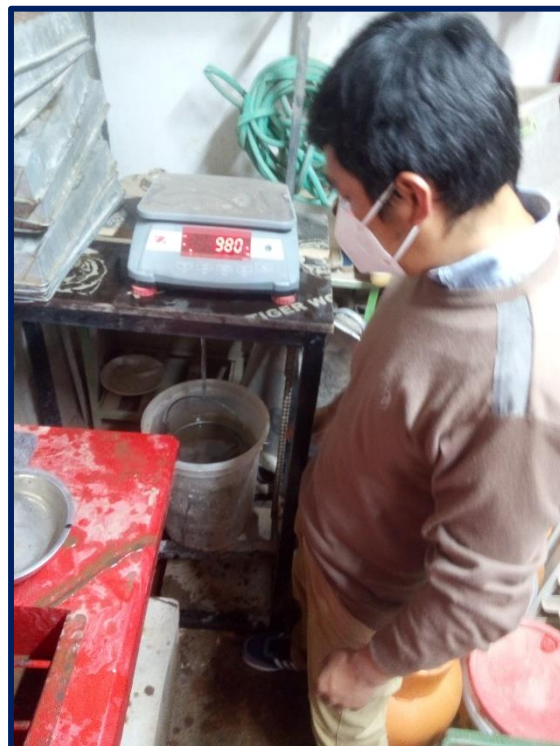
Imagen N° 10 Pesado de muestra sumergido en agua para determinar peso específico.
