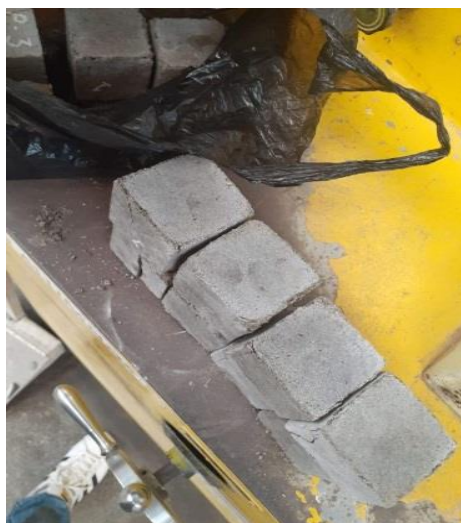
FOTO N°27, 28 y 29: Morteros ya Ensayados
