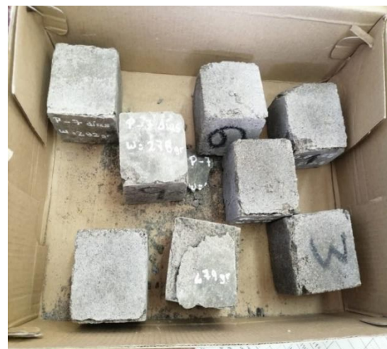
FOTO N°24, 25 y 26: Cubos listos para Ensayo de Resistencia a la Compresión
