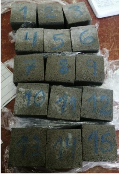
FOTO N°19, 20 y 21: Morteros seleccionados según días de Curado
