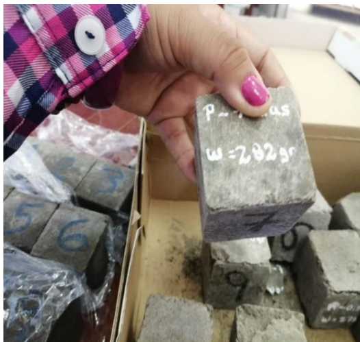
FOTO N°24, 25 y 26: Cubos listos para Ensayo de Resistencia a la Compresión
