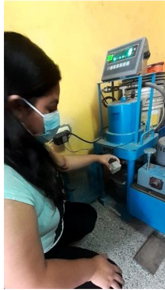
FOTO N°24, 25 y 26: Cubos listos para Ensayo de Resistencia a la Compresión
