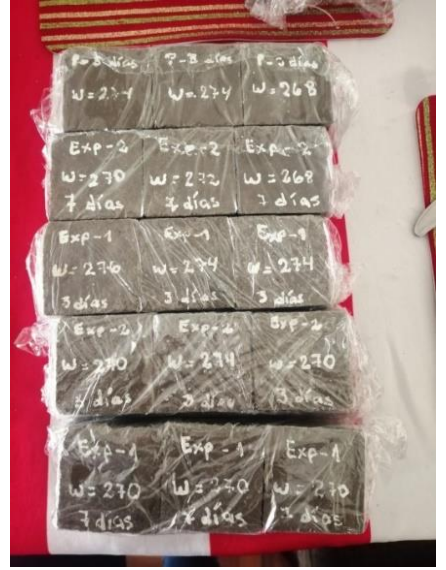
FOTO N°19, 20 y 21: Morteros seleccionados según días de Curado
