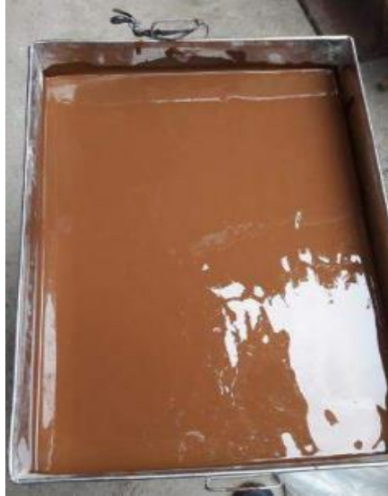
FOTO N°3, 4 y 5: Limpieza y secado de arcilla
