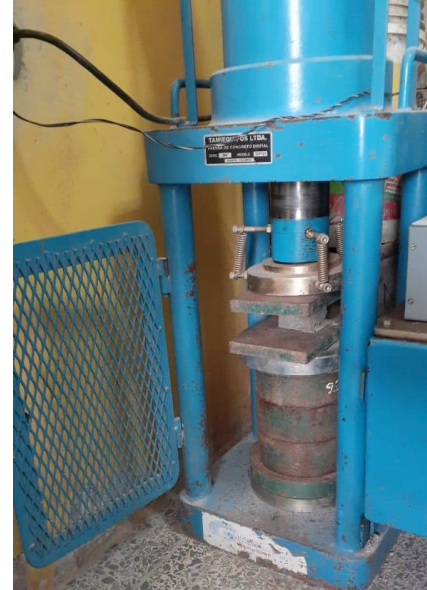
FOTO N°24, 25 y 26: Cubos listos para Ensayo de Resistencia a la Compresión
