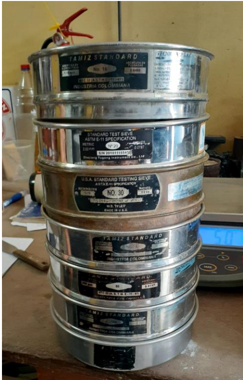
FOTO N°11 y 12: Tamices para la gradación de arena
