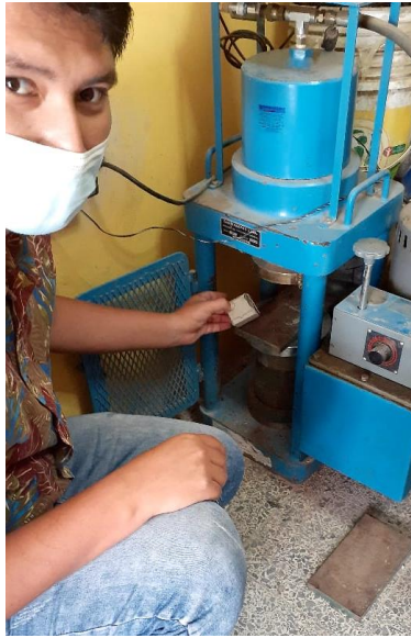
FOTO N°24, 25 y 26: Cubos listos para Ensayo de Resistencia a la Compresión
