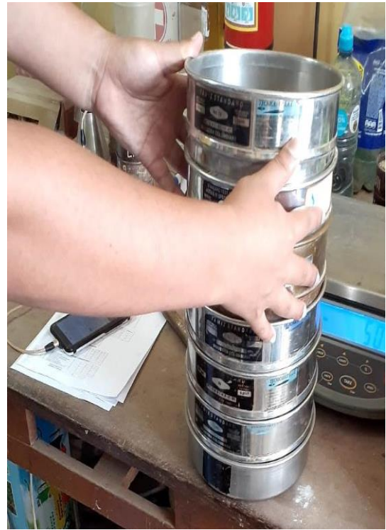
FOTO N°11 y 12: Tamices para la gradación de arena
