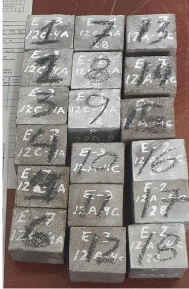
FOTO N°19, 20 y 21: Morteros seleccionados según días de Curado
