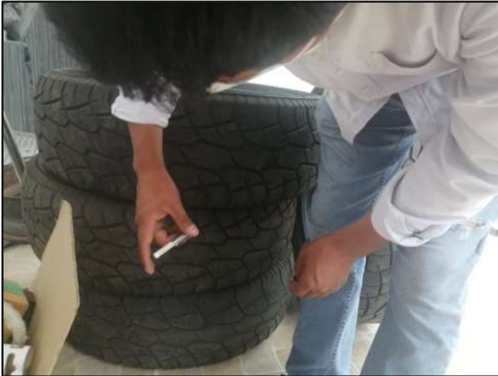
Figura 6: Medición de cocadas
