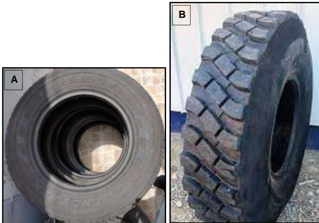
Figura 15: (A) Llanta antes del reencauche, (B) llanta después del reencauche
