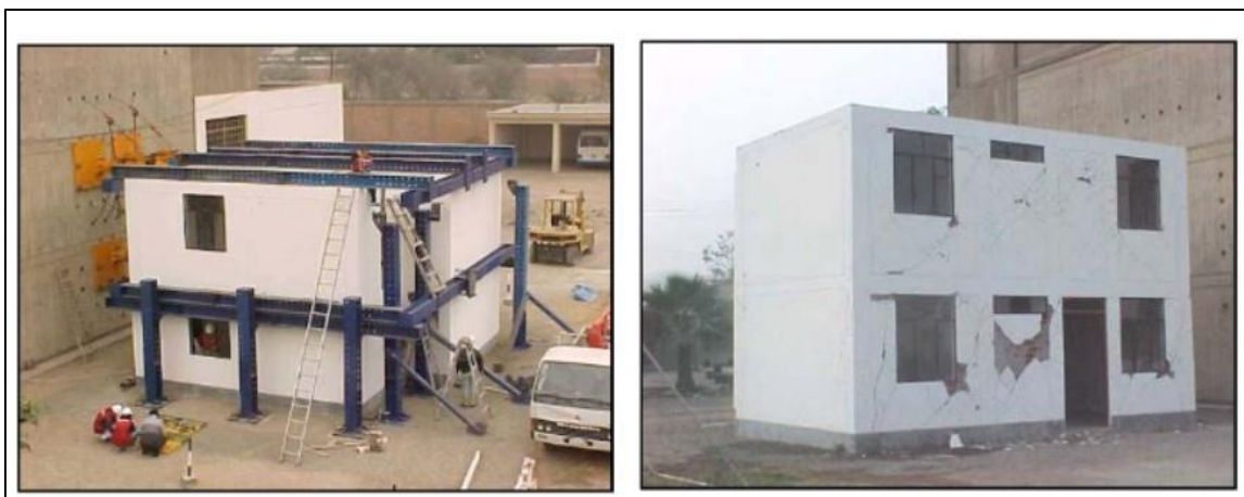
Figura 53. Módulo de 2 niveles ensayado en CISMID. Fuente: Tomado de (Zavala et al., 2003).
