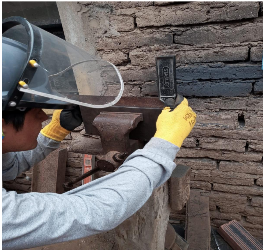
Creación de la maquina cinva ram modifi
