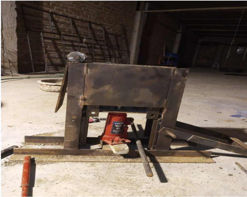
cinva ram accionada por la gata hidraulica
