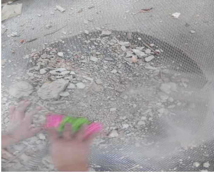
tamizado de residuo pétreo de construcción
