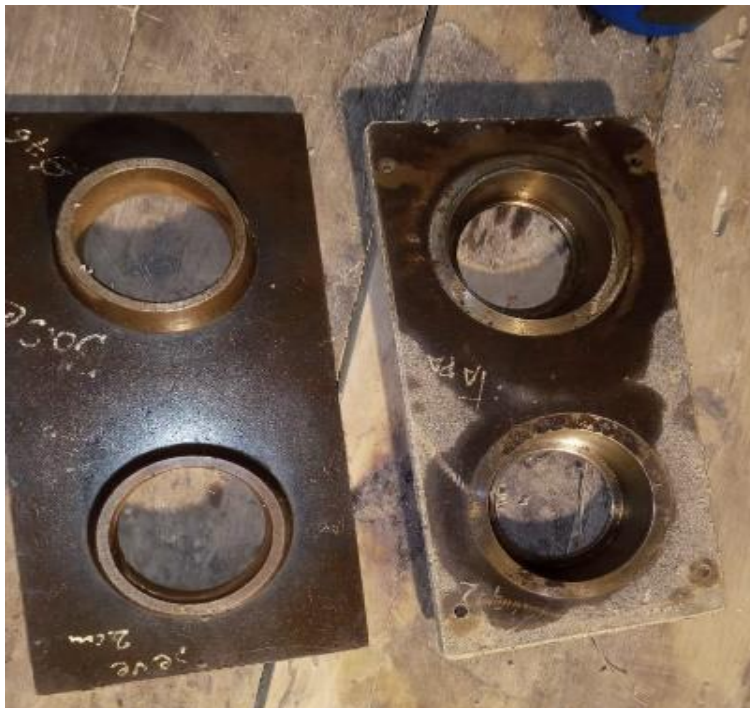
moldes internos de la cinva ram elaborados por un tornero
