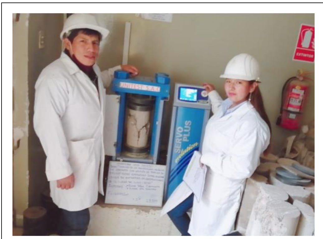
Figura 9. Ensayo de resistencia a la compresión del concreto.
