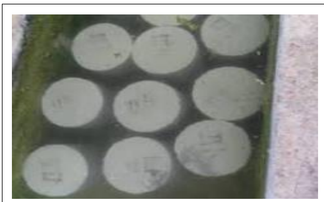
Figura 8. Curado de briquetas.
