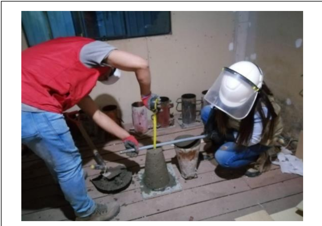
Figura 6. Imagen de la mezcla de agregados + perlas de poliestireno expandido.
