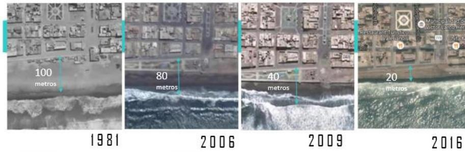
Figura 45: Evolución avance de la Erosión
