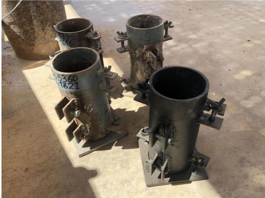
Figura 41: Moldes de 4x8" para ensayo de resistencia a la compresión no confinada.
