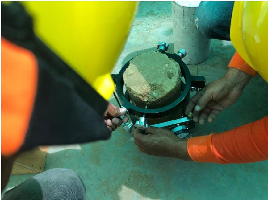
*Figura 53: Instalación de armazón y calibración diales para módulo de elasticidad.*
