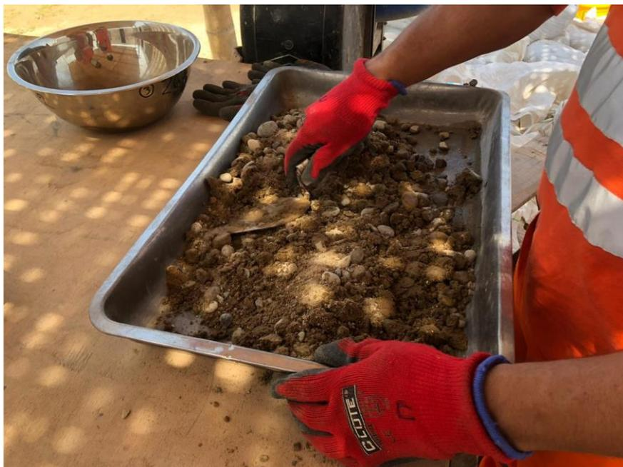
*Figura 36: Material terminado y listo para ser utilizado en ensayos para suelo-cemento.*
