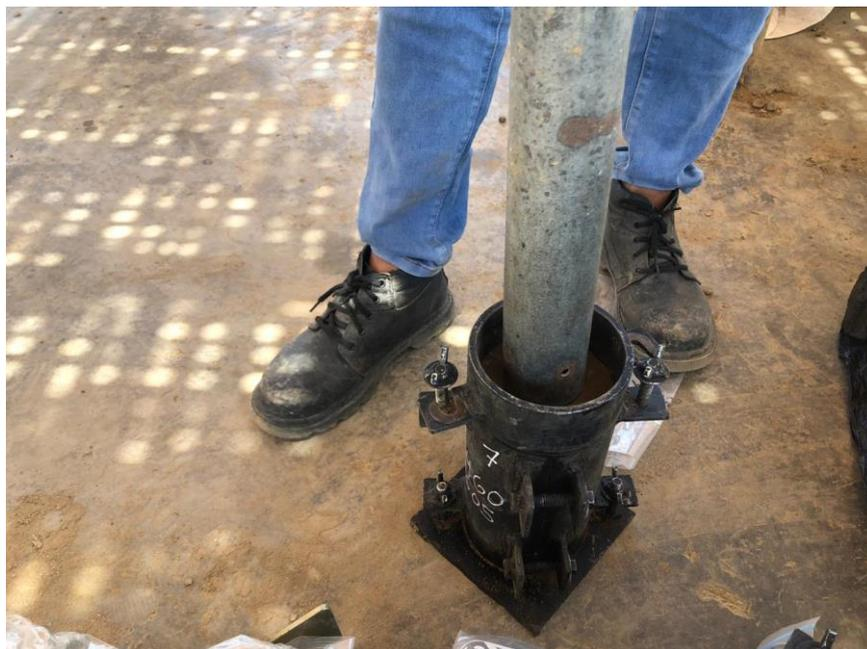
Figura 42: Compactado de material granular en moldes de 4x8".
