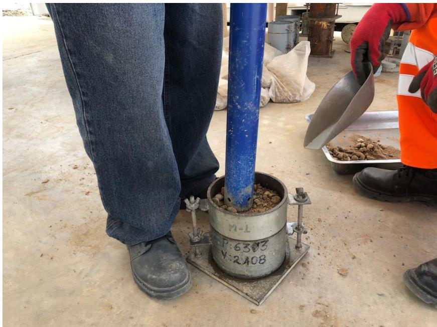
*Figura 38: Compactado de última capa en molde Proctor modificado.*
