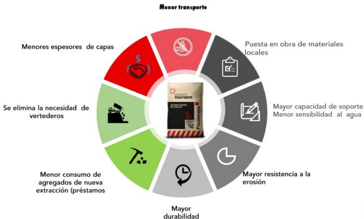
Figura 7: Ventajas de la estabilización con cemento VIAFORTE.
