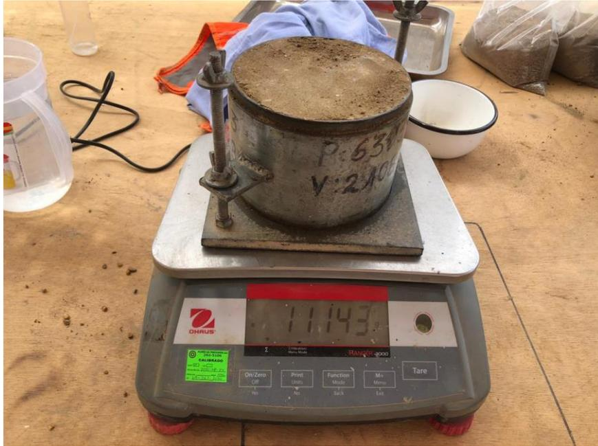
Figura 39: Peso de muestra para determinación de densidad.
