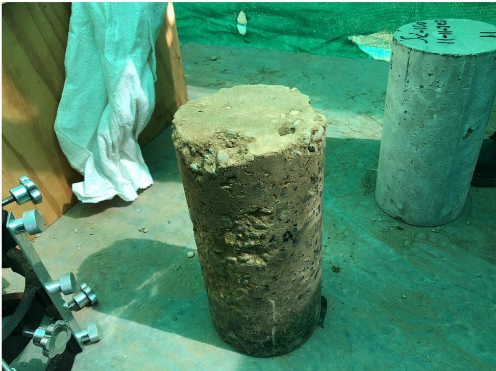
*Figura 55: Probeta de 6x12" ensayada.*
