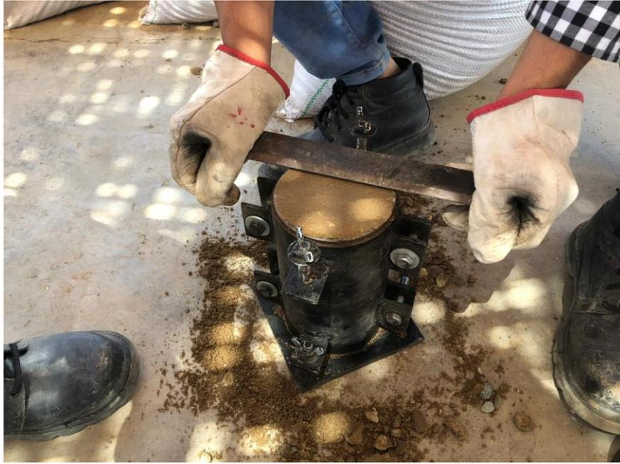
Figura 43: Enrasado de briquetas de 4x8".
