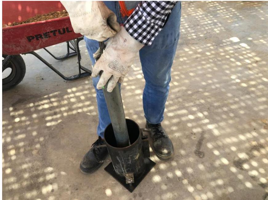
*Figura 50: Compactación de probetas de 6x12".*
