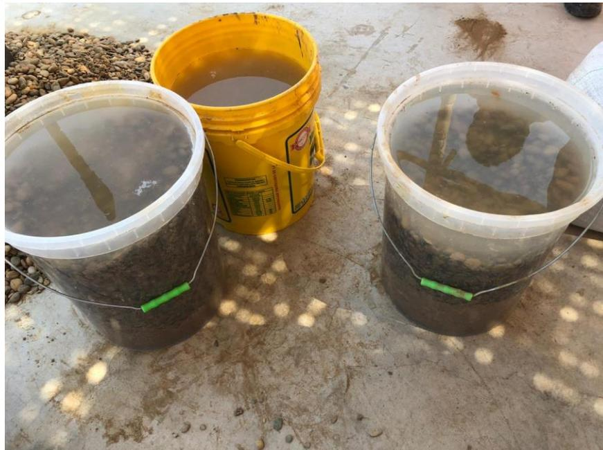
Figura 30: Saturación de material que pasa malla 3/4" y retenido en malla N°4.
