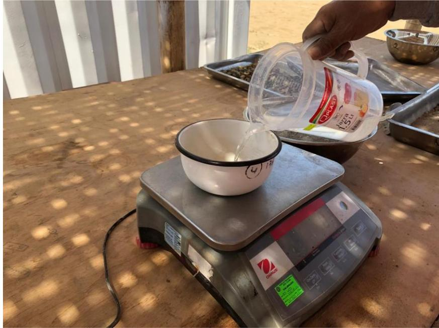
Figura 33: Peso de agua potable para mezcla según humedad de prueba.
