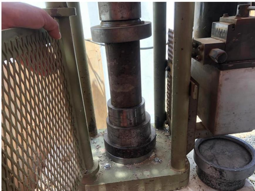
*Figura 48: Compresión de briquetas a una velocidad de 160 kg/seg.*
