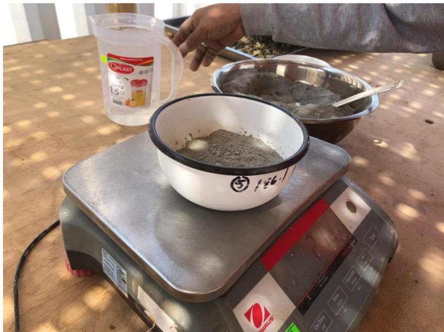
*Figura 32: Peso de Cemento Viaforte según porcentaje a analizar.*
