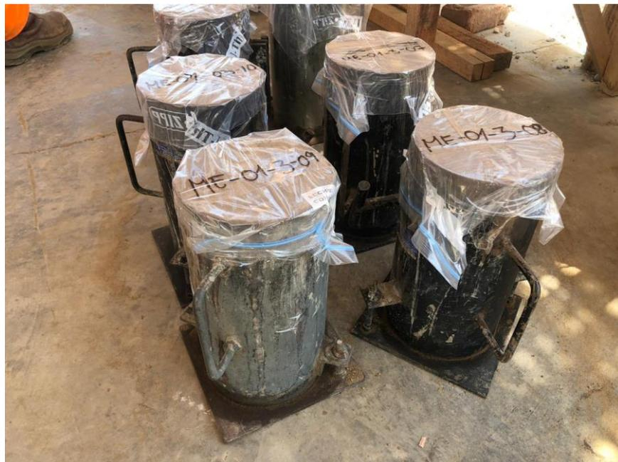
*Figura 51: Codificación de probetas de 6x12" para módulo de elasticidad.*
