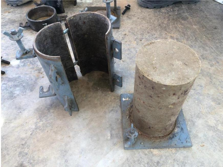
*Figura 45: Desmoldado de briquetas después de 24 horas de reposo.*
