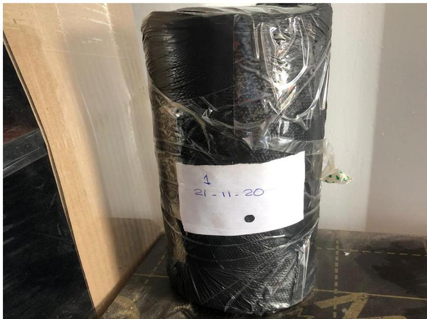
*Figura 46: Curado y etiquetado de briquetas hasta su fecha de rotura programada.*
