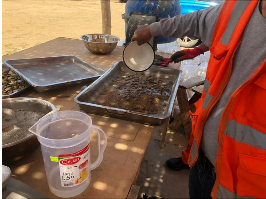
*Figura 35: Combinación de materiales granulares con agua según humedad de prueba.*
