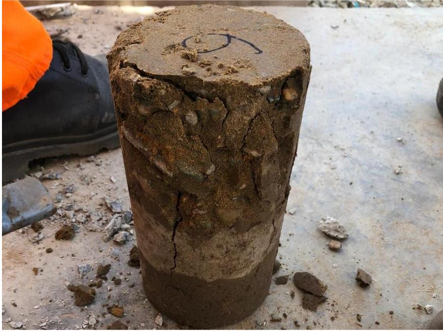
*Figura 49: Falla de briqueta por compresión no confinada.*
