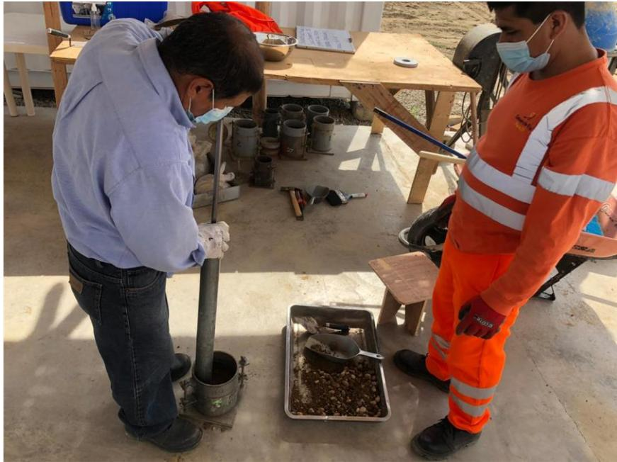
*Figura 37: Compactado en molde Proctor modificado.*
