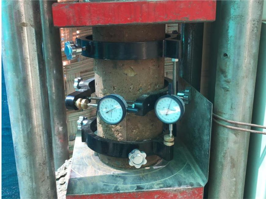
*Figura 54: Ejecución de ensayo de módulo de elasticidad.*
