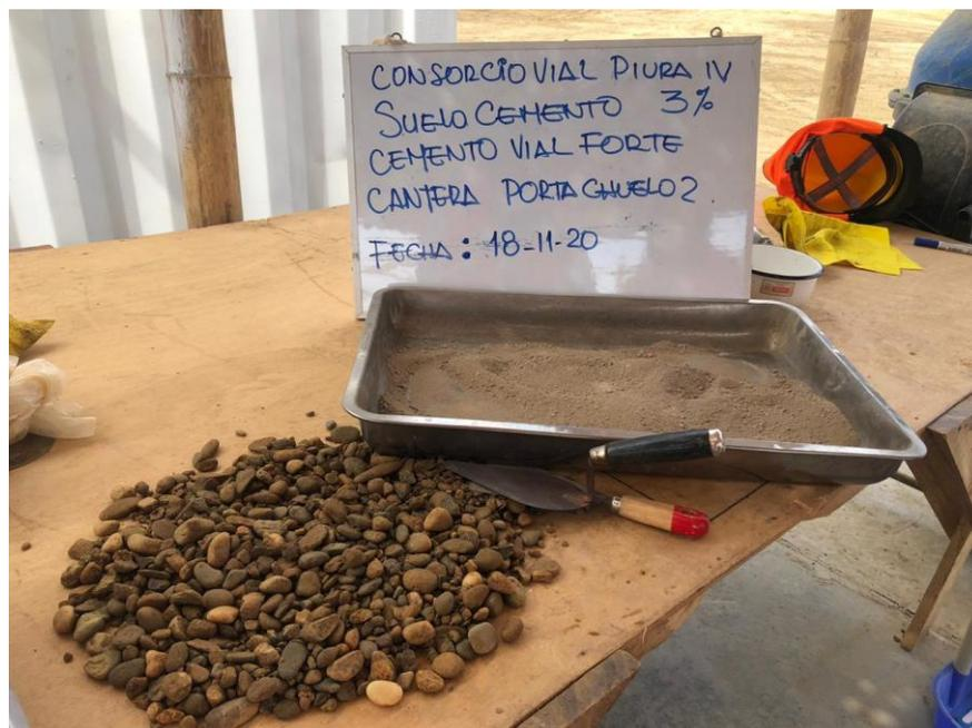
Figura 34: Material granular que retenido en malla N°4 saturado con superficie seca y material granular que pasa la misma, mezclado con cemento Viaforte.
