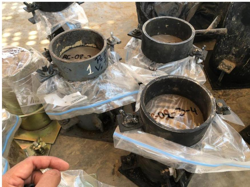
Figura 44: Reposo de briquetas por 24 horas.
