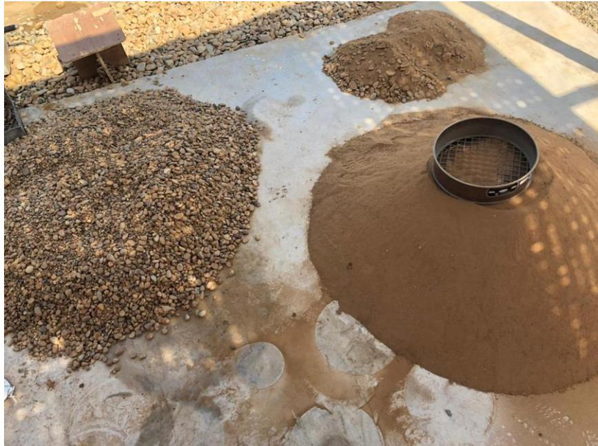
Figura 29: Tamizado de material por la malla N°4 para separar agregado gruesos y finos.
