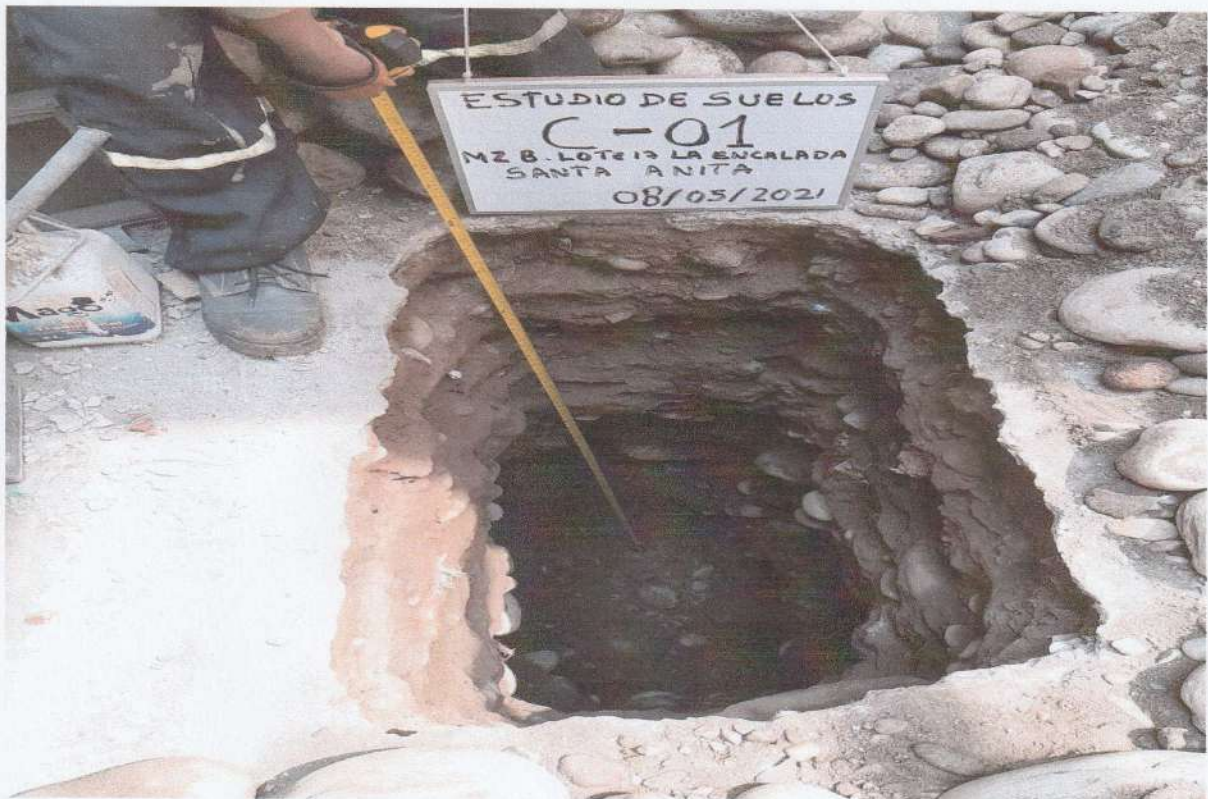
FOTO N° 04: Vista interior de la calicata C-1 donde se muestra el perfil estratigráfico del suelo que alcanza una profundidad de exploración de 3.00m. Se observa el material heterogéneo conformado por gravas y cantos sub redondeados unidos por una matriz de arena.
