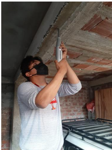
Ensayo de esclerometría en los puntos críticos
