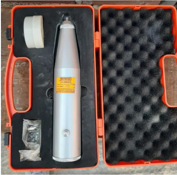
Esclerómetro calibrado: Instrumento para el ensayo de esclerometría
