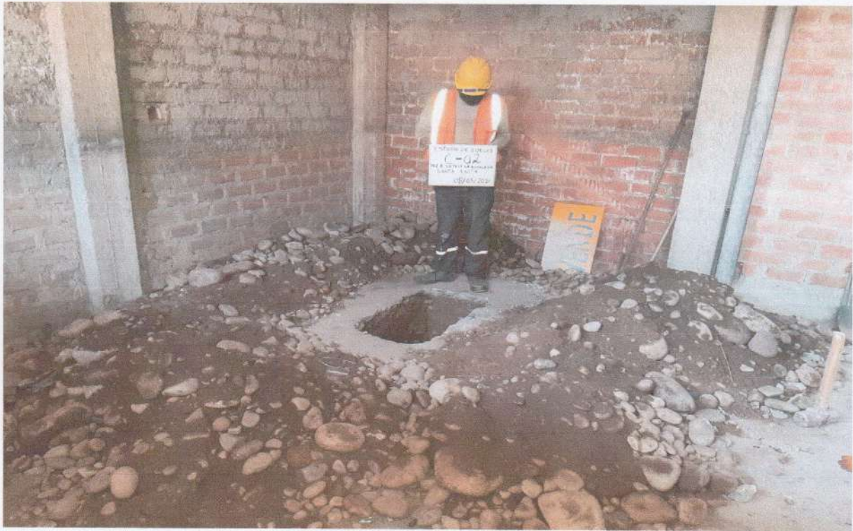
FOTO N° 05: Vista panorámica del exterior de la calicata C-2, que se ubicó en la zona de estacionamiento. Se puede observar el material de grava pobremente gradada con arena (GP).
