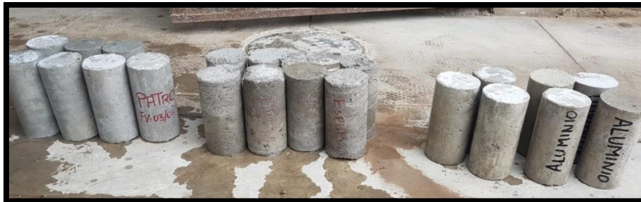
Figura 19: Probetas De Concreto Celular Curado 7 días
