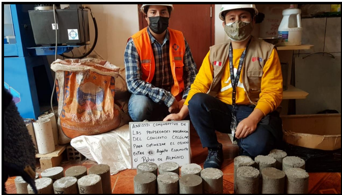
Figura 17: Testigos De Concreto Celular
