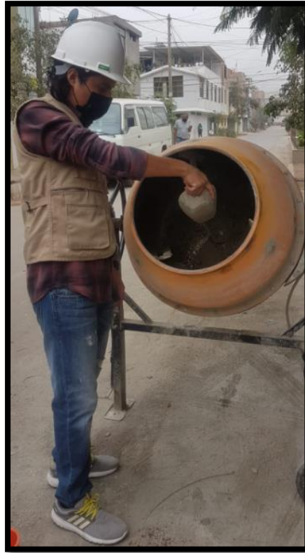
Figura 16: Adición De Polvo De Aluminio
