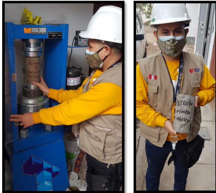
Figura 20: Ensayo de Resistencia a la Compresión de Concreto Celular 7 días
