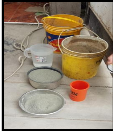
Figura 10: Materiales Utilizados para Elaborar Concreto Celular
