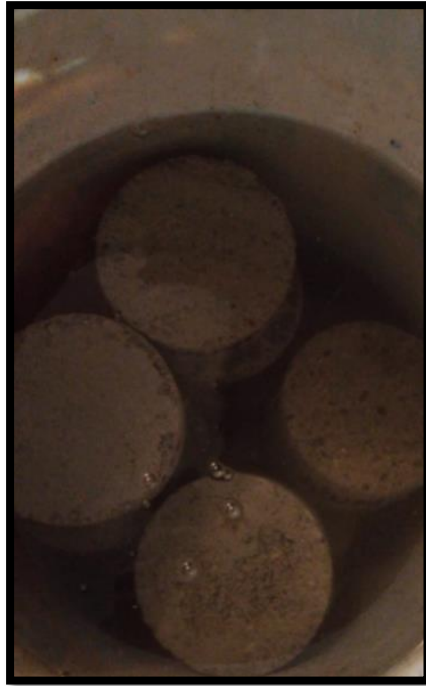
Figura 26: Curado de Muestras 24H
