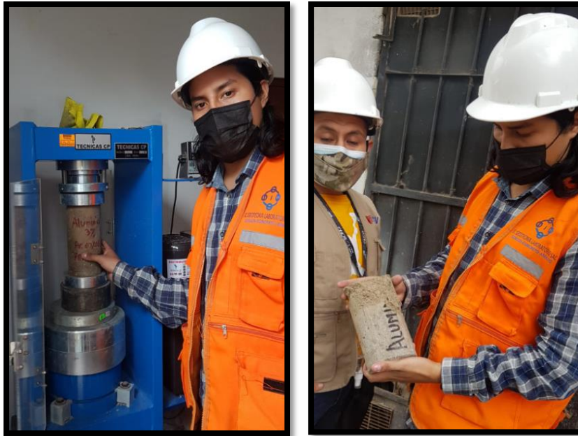
Figura 22: Ensayo de Resistencia a la Compresión de Concreto Celular 28 días
