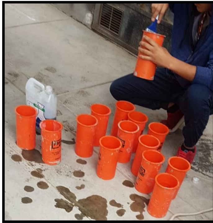
Figura 14: Adición De Aditivo Desmoldando a los Moldes
