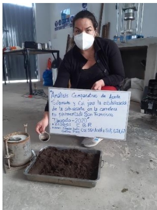
Ensayo de CBR suelo natural con el 5% cal + aceite sulfonado 0.2 L/m3
