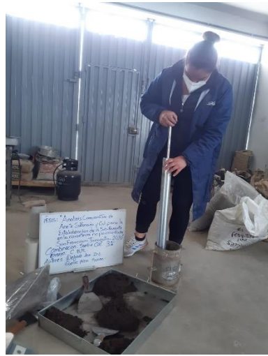
Elaboración Proctor modificado suelo natural + el 8 % cal
