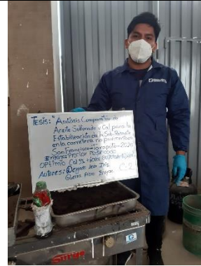
Proctor modificado con el 5% cal + aceite sulfonado de 0.2 L/m3
