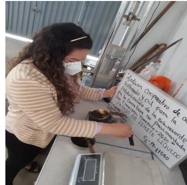
Limite liquido del suelo natural calicata N°2
