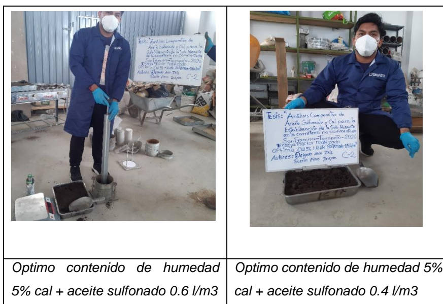
Figura 31. Proctor modificado S.N + óptimo de cal + aceite sulfonado
