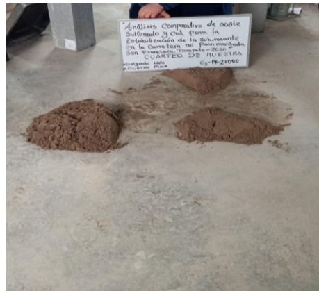
separación y cuarteo de muestra según la norma MTC de la calicata N°3
