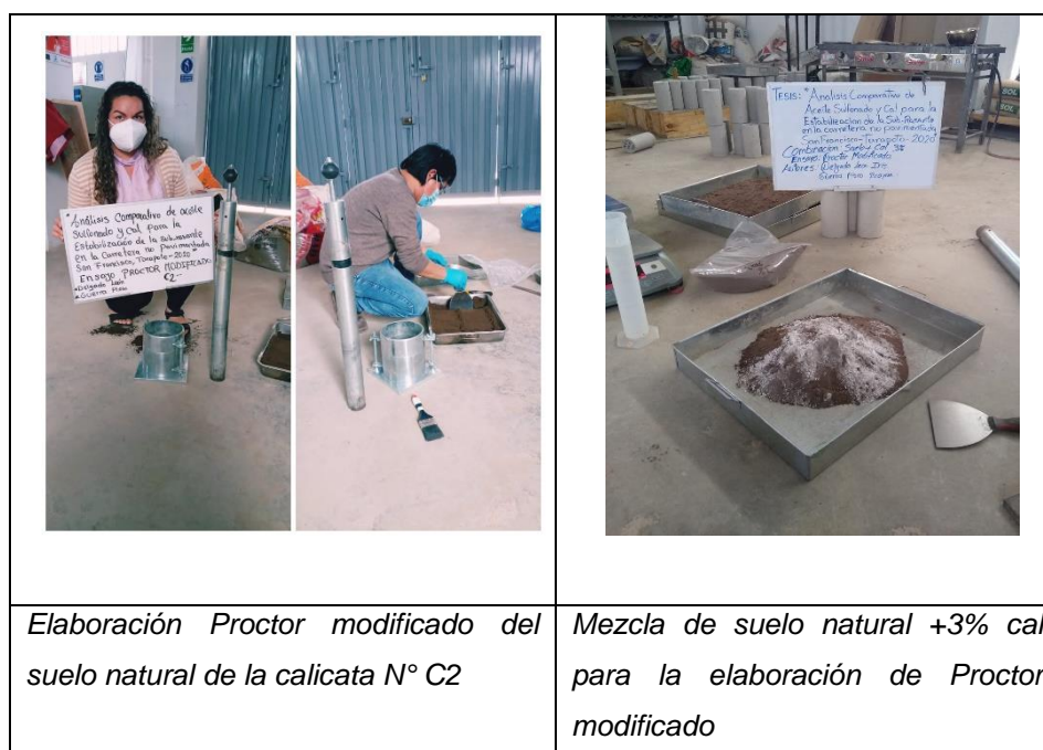
Figura 24. Proctor modificado de suelo natural + cal
