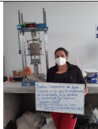
Ensayo de penetración de CBR con el 5% cal + aceite sulfonado 0.4 L/m3
