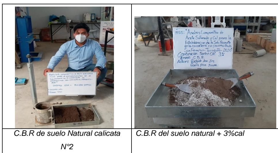
Figura 27. Ensayo de CBR suelo natural + cal
