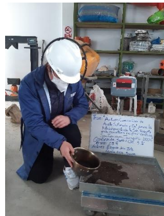
Ensayo de CBR suelo natural + el 5 % cal
