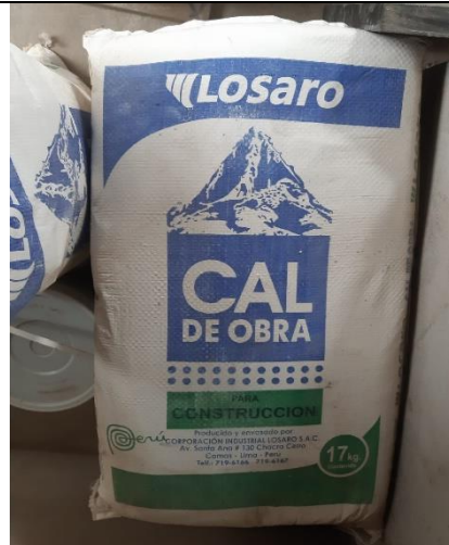
Aditivo cal utilizada en distintas dosificaciones 3%, 5% y 8%
