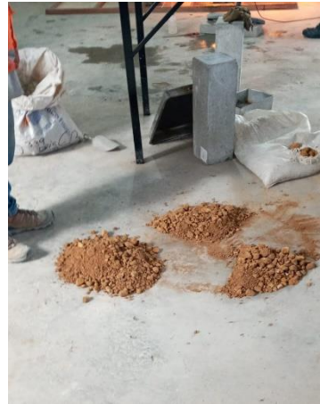
separación y cuarteo de muestra según la norma MTC de la calicata N°1
