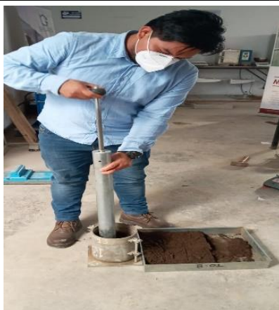
Ensayo de C.B.R suelo natural calicata N°2 en 3 moldes a 10, 25 y 56 golpes según la norma MTC
