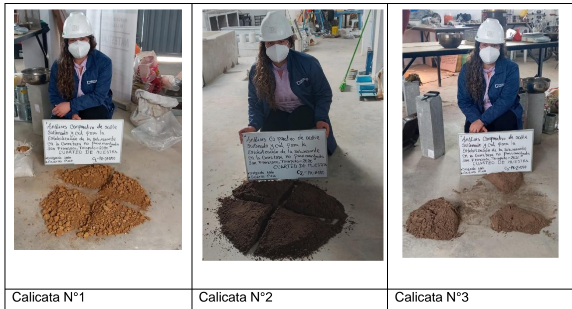
Figura 13. Cuarteo de Muestra
