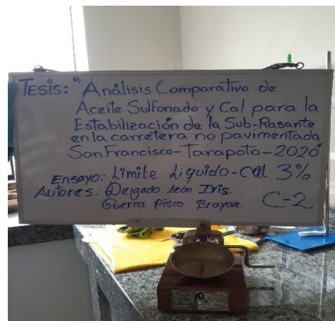
Limite liquido del 3% cal
