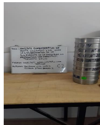
Estudio de granulometría por tamizado calicata N°2
