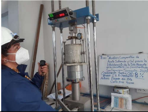
Ensayo de CBR suelo natural + el 8 % cal
