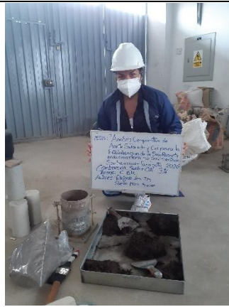
Proctor modificado suelo natural + el 3 % cal
