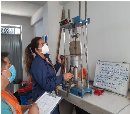
Ensayo de CBR suelo natural + el 3 % cal
