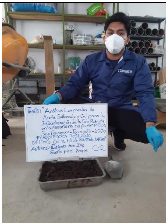
Proctor modificado con el 5% cal + aceite sulfonado de 0.4 L/m3
