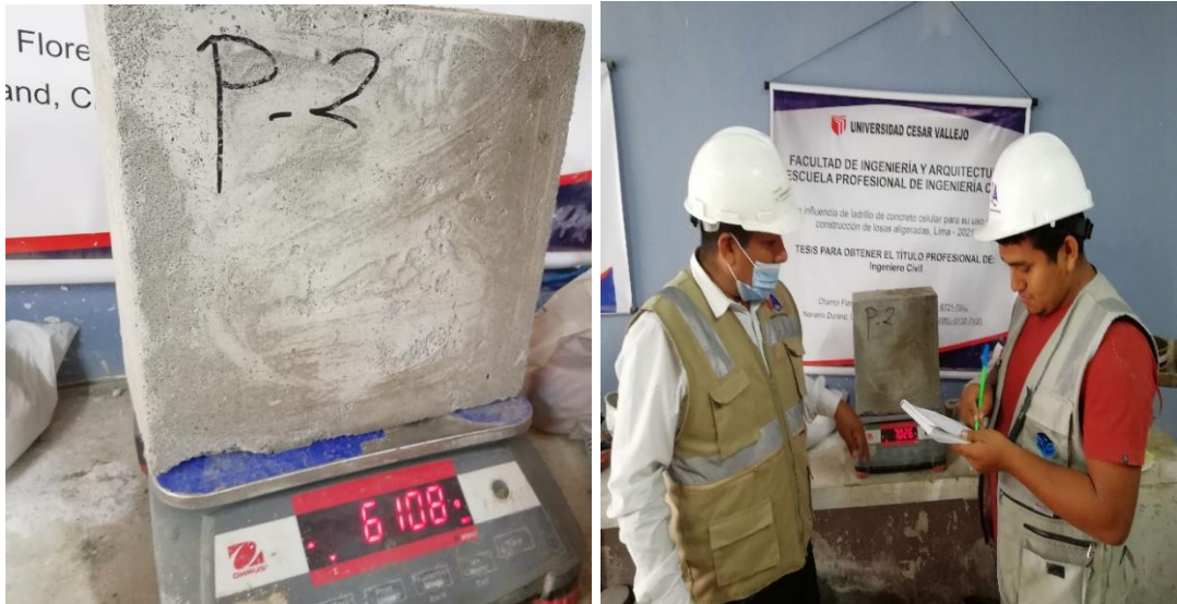
Figura 7. Peso unitario del ladrillo de concreto celular.
