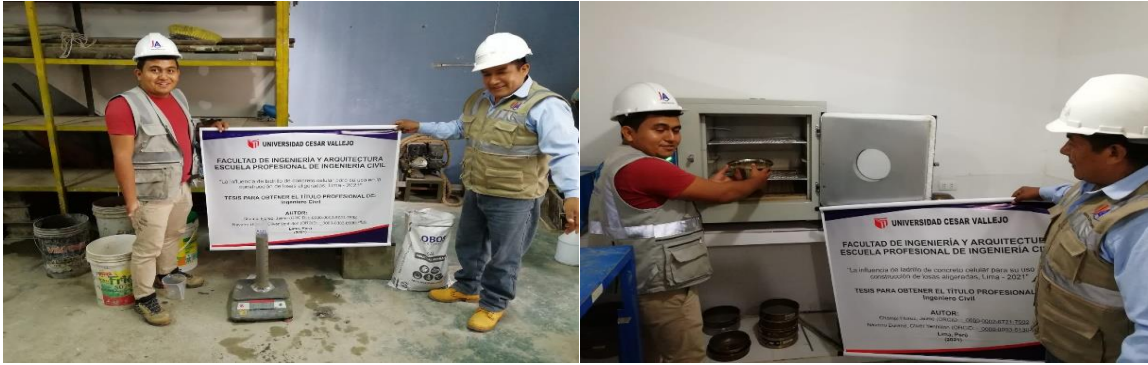
Figura 24. Proceso para obtener la absorción y el peso específico del agregado fino.
