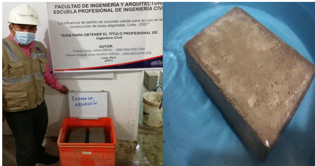
Figura 8. Absorción de cada unidad del ladrillo concreto celular.
