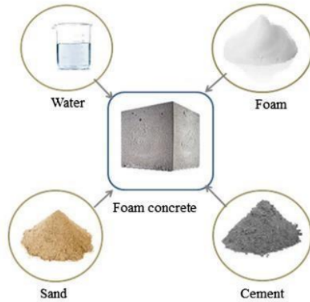
Figura 2. Materiales para el concreto celular liviano Fuente: Construction and Building Materials
