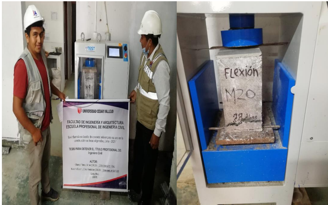
Figura 11. Módulo de Rotura o Flexión.
