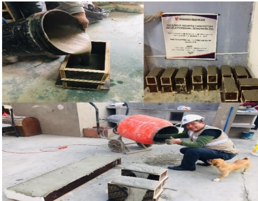
Figura 31. Moldeado con las dimensiones largo 30, ancho 30 y altura 15 cm.
