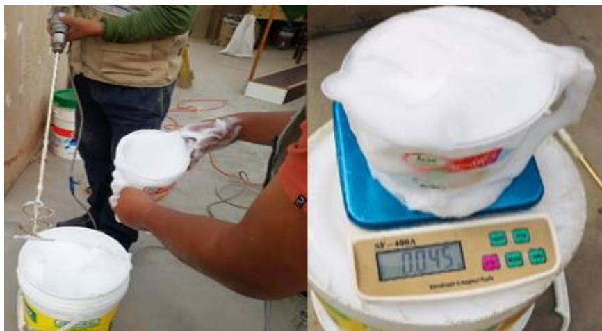
Figura 29. Batir en altas revoluciones hasta logra una espuma y pesar.
