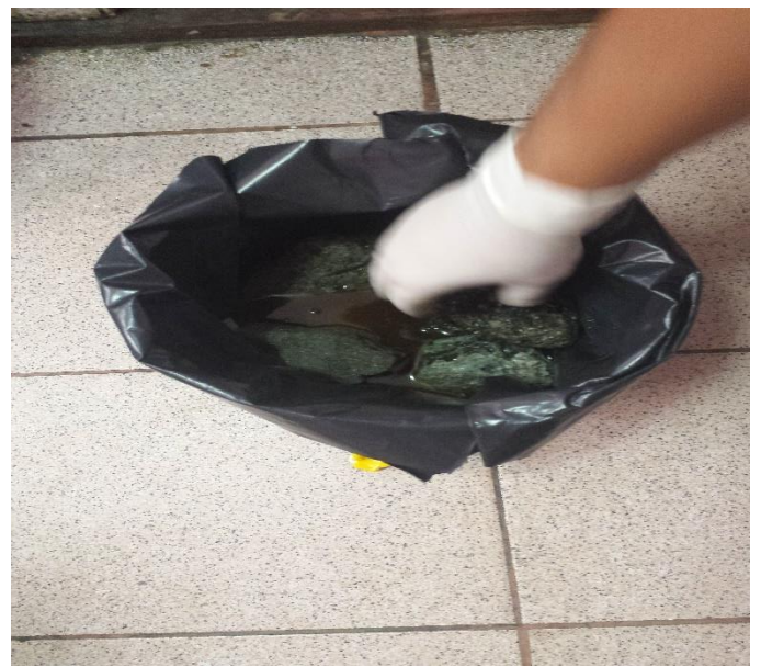
Elaboración Propia: Imagen del biofiltro empacado de piedra pómez y EM - Agua.
