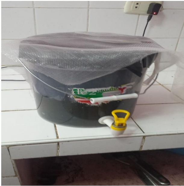
Elaboración Propia: Imagen del biofiltro empacado de piedra pómez y EM - Agua.
