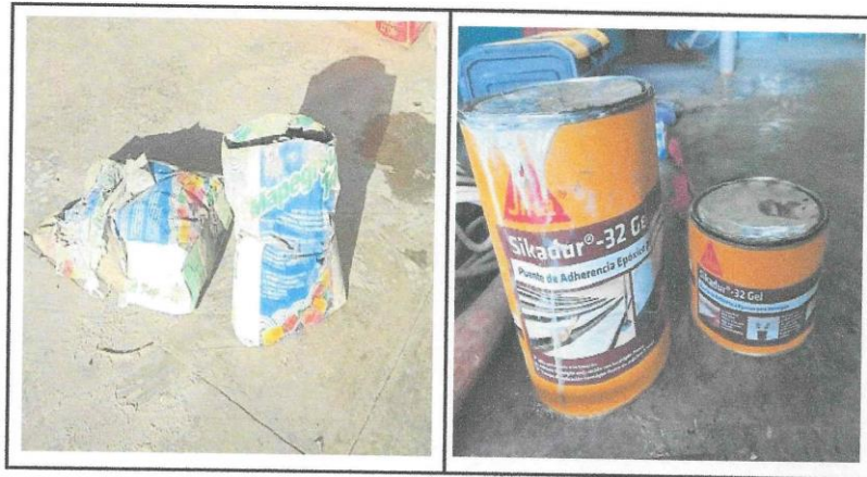
Figura N° 10: Aditivo empleado MAPEI Mapegrout T60 y Sikadur®-32 Gel Fuente: Elaboración Propia
