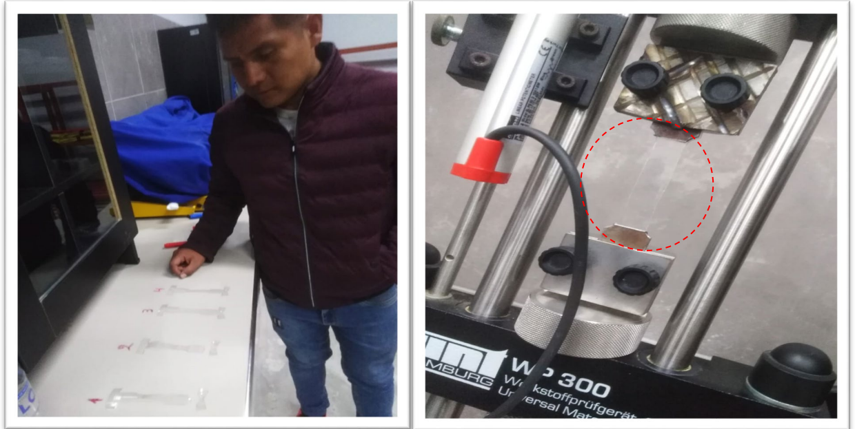
Foto N° 07: Molde del polietileno residuos plástico y ensayo de tensión en el Equipo Universal.
