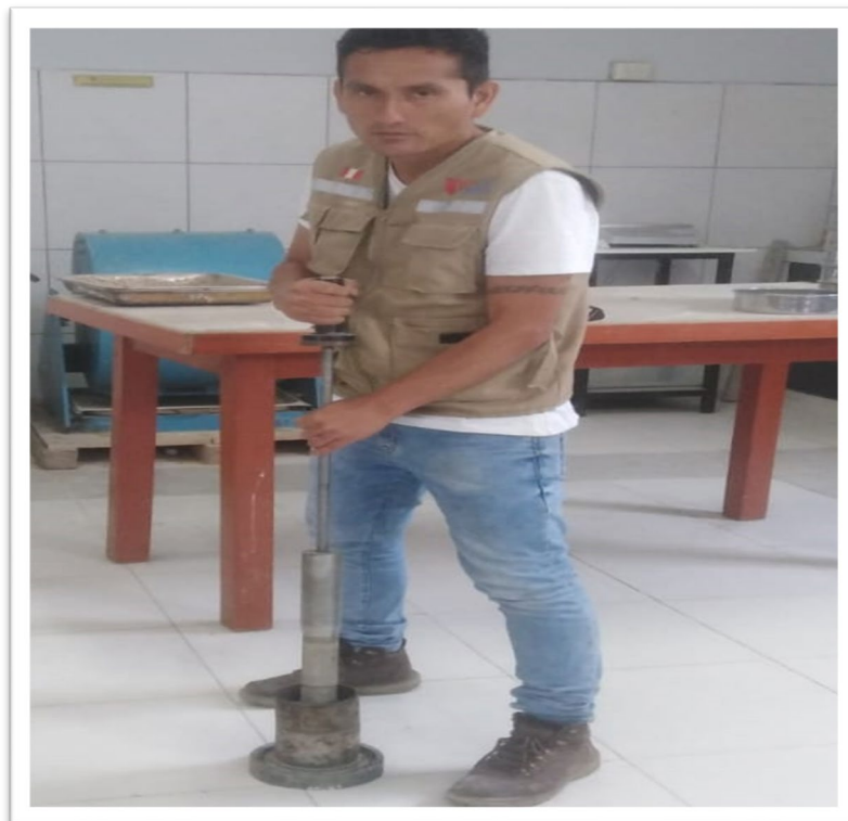
Foto N° 12: Compactación del espécimen 50 golpes
