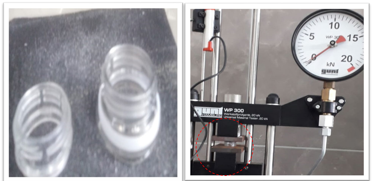
Foto N° 08: Molde del polietileno residuos plástico y ensayo de compresión en el Equipo Universal.
