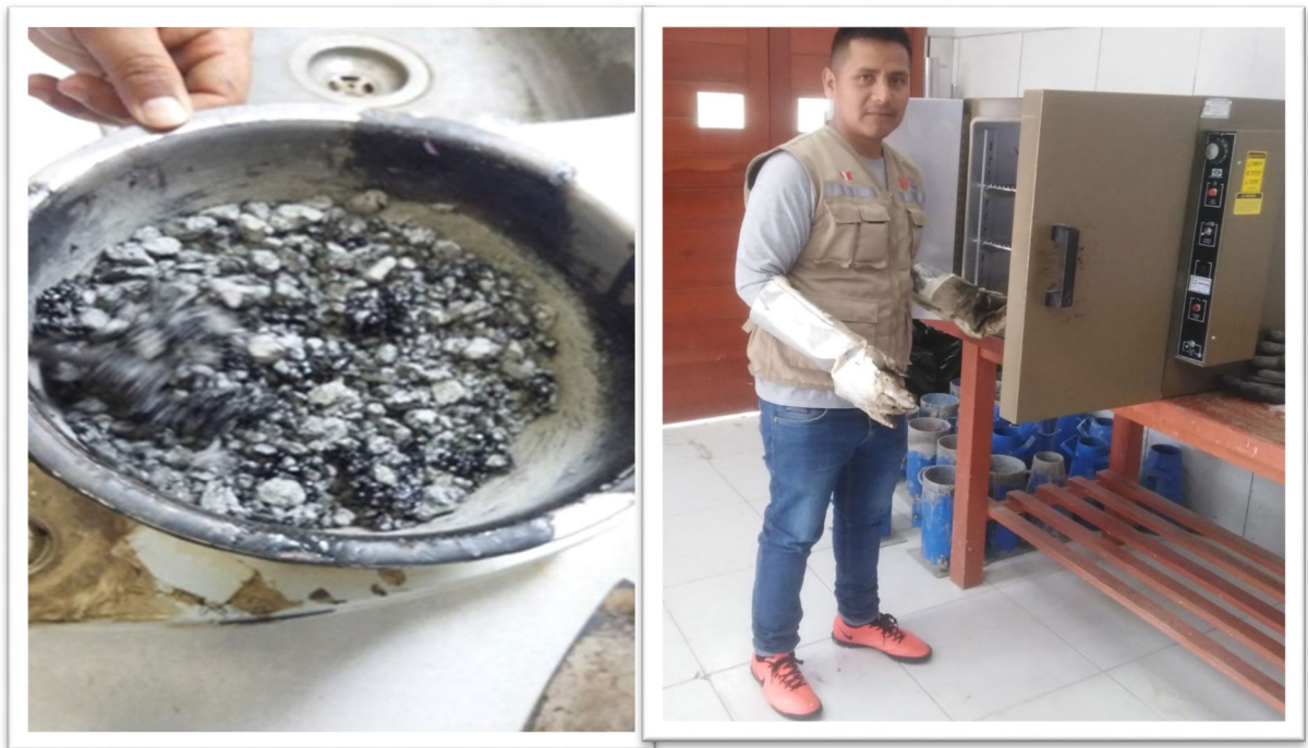
Foto N° 10: Peso específico de los materiales y colocación al horno (90°-120°)
