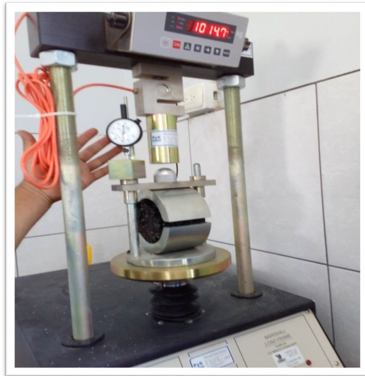
Foto N° 17: Ensayo Marshall de la muestra modificada con polímero 4%
