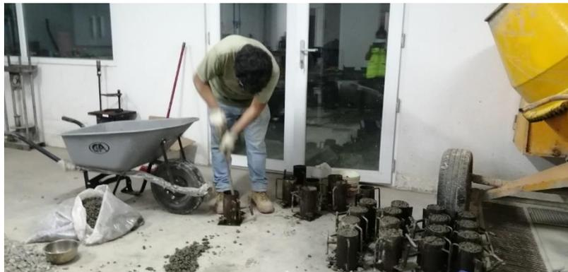
Elaboración de probetas cilíndricas de concreto permeable para realizar ensayos a compresión según NTP 339.034.
