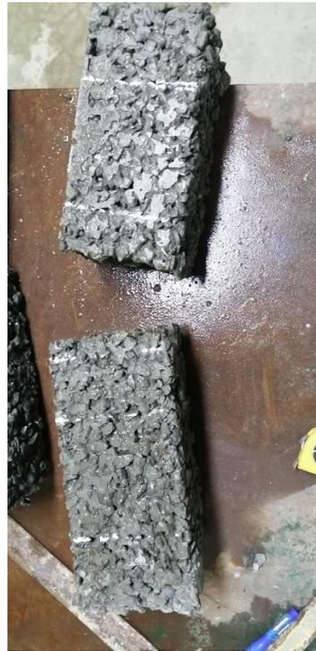
Ensayo a compresión de vigas a los tercios del tramo.
