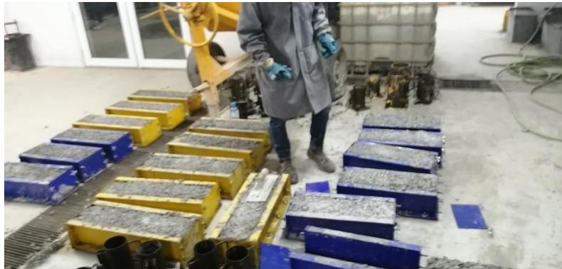
Elaboración de vigas de concreto permeable para realizar ensayos de resistencia a flexión. NTP 339.078
