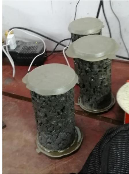
Colocación de capping a las muestras cilíndricas para ensayo de compresión.
