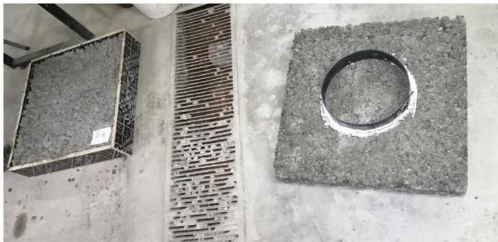
Habilitación de la muestra para ensayo de infiltración adhiriendo un aro con silicona en la parte superior de la muestra
