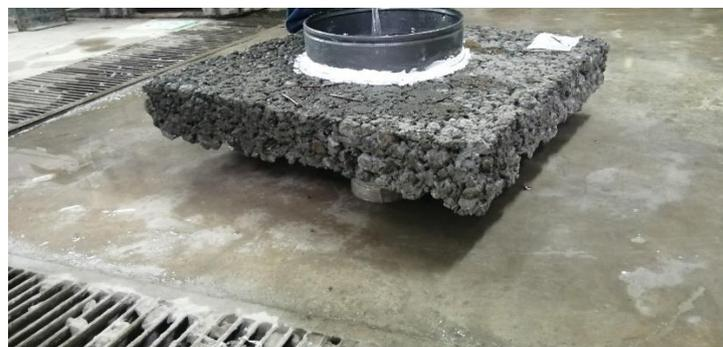
Ensayo de infiltración de agua (ASTM C1701-17)
