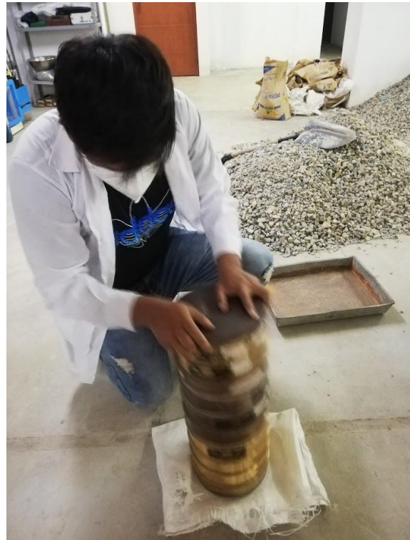
Figura 26: Ensayo de análisis granulométrico del agregado grueso.
