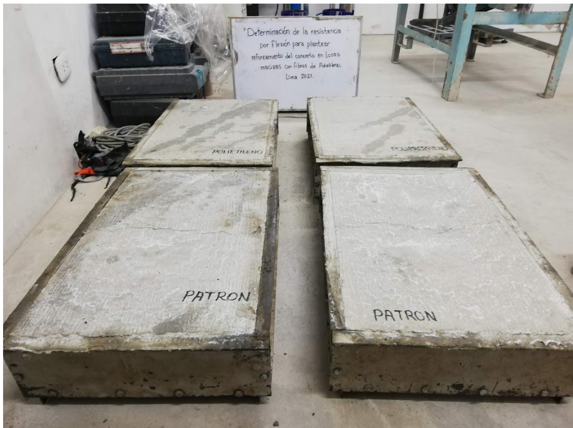
Figura 47: Retiro de plástico para cuantificar el ancho de fisuras.
