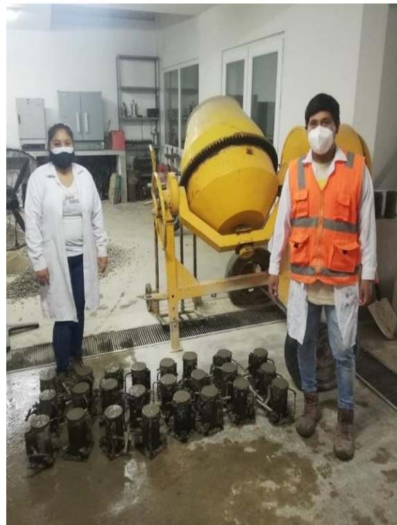
Figura 36: Elaboración de probetas cilíndricas con las dosificaciones establecidas.
