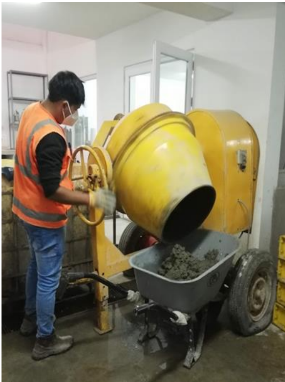
Figura 31: Elaboración de la mezcla para elaboración de probetas cilíndricas.
