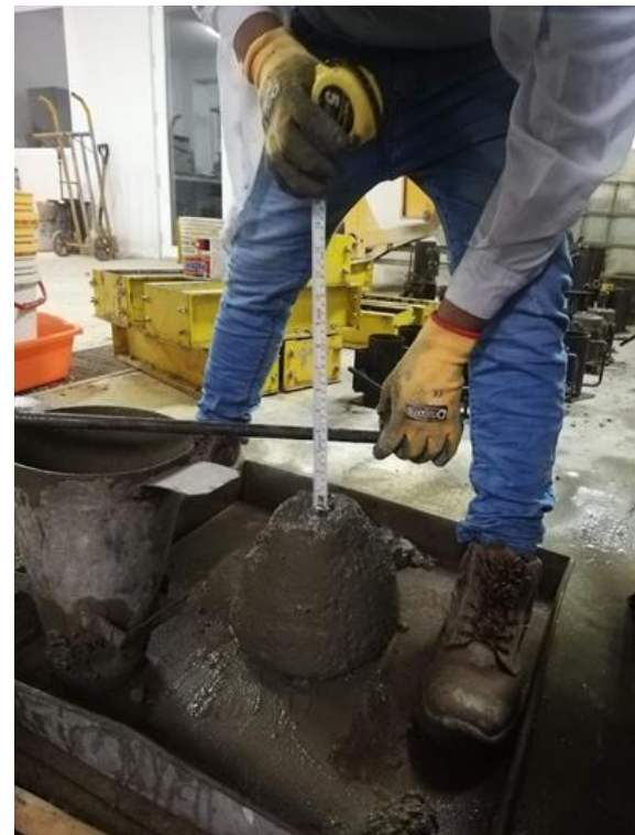
Figura 32: Ensayo de asentamiento del concreto con el Cono de Abrams.
