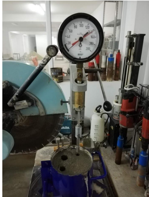
Figura 44: Ensayo de tiempo de fraguado del concreto.
