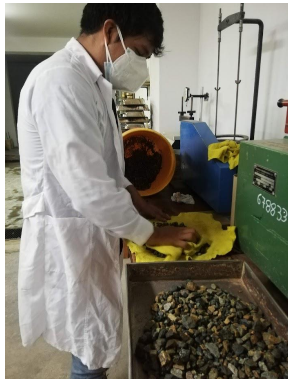
Figura 28: Secado superficialmente del agregado grueso.
