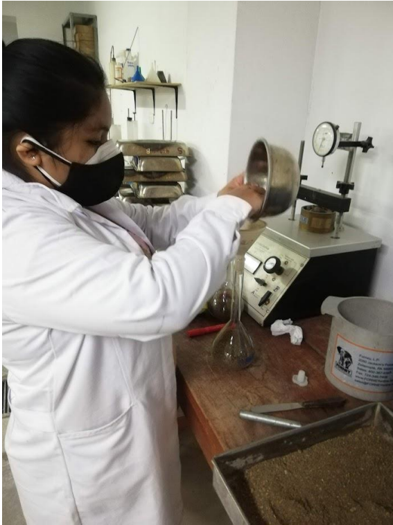
Figura 29: Ensayo de densidad y absorción del agregado fino.
