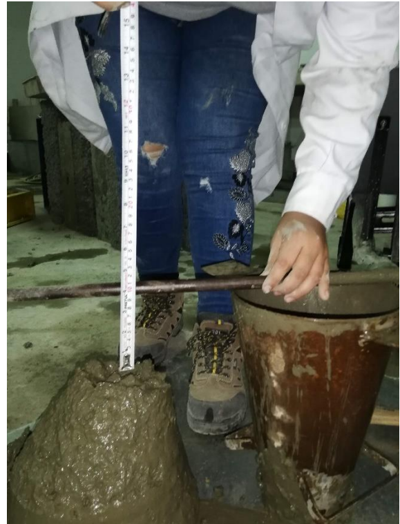
Figura 34: Ensayo de asentamiento del concreto con el Cono de Abrams.
