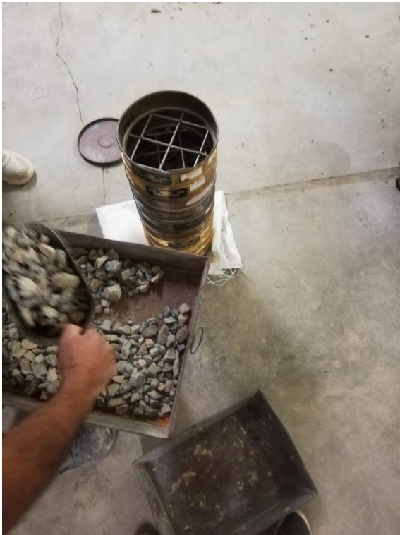
Figura 25: Colocación de agregado grueso en tamices.
