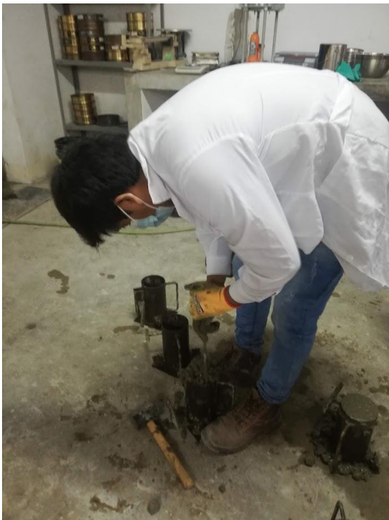
Figura 35: Compactado del concreto en probetas cilíndricas.
