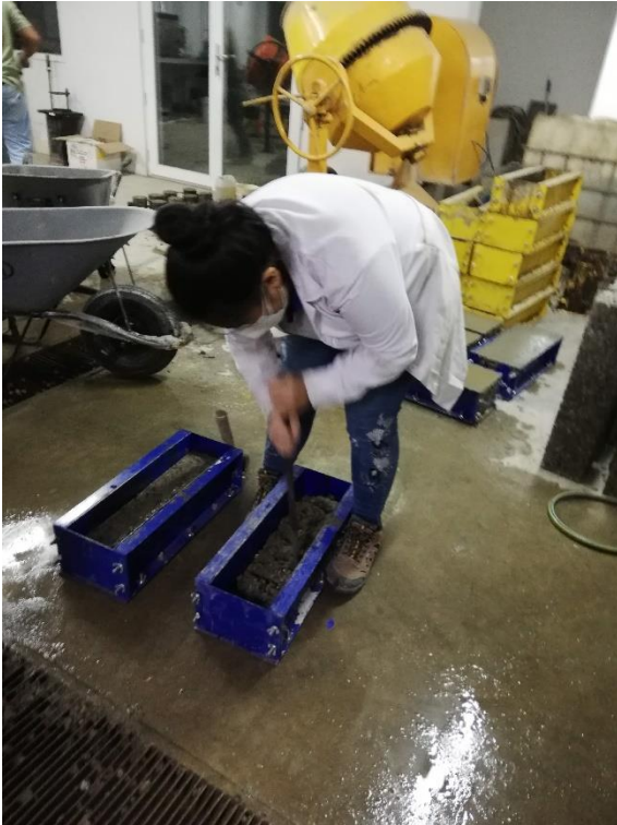
Figura 37: Elaboración de vigas prismáticas con las dosificaciones establecidas.
