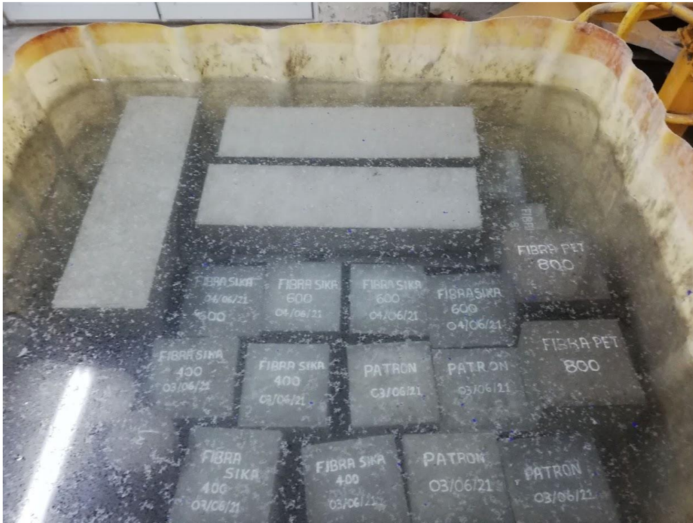
Figura 40: Curado de vigas prismáticas.
