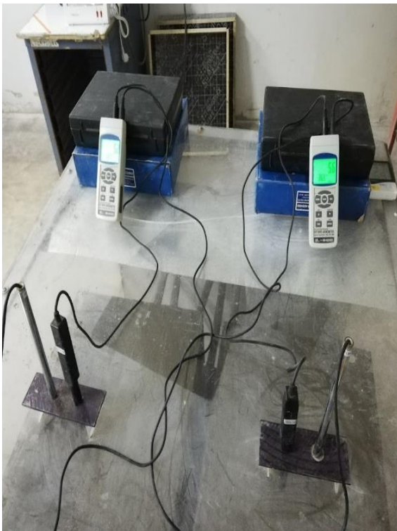
Figura 41: Medición de las temperatura y velocidad de viento mediante anemómetros.
