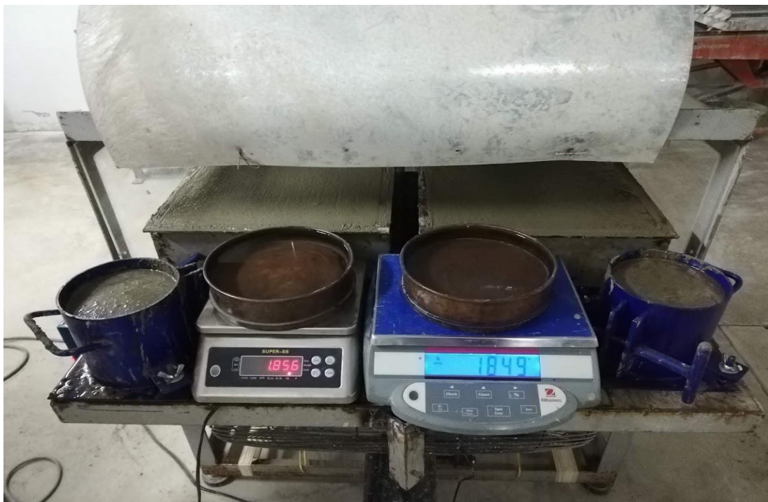
Figura 45: Ensayo para evaluar el agrietamiento por contracción plástica de concreto reforzado con fibra.
