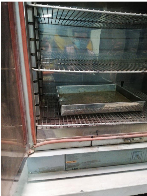
Figura 27: Secado al horno del agregado fino.
