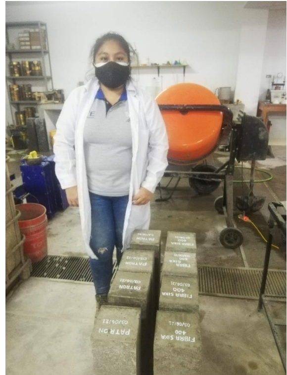
Figura 38: Desencofrado de vigas prismáticas.
