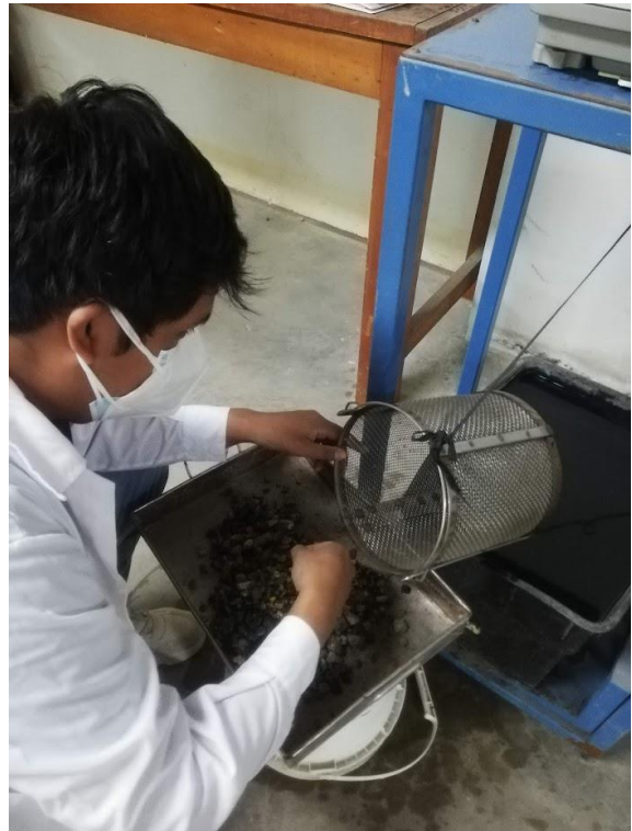
Figura 30: Ensayo de densidad, gravedad específica y absorción del agregado grueso.
