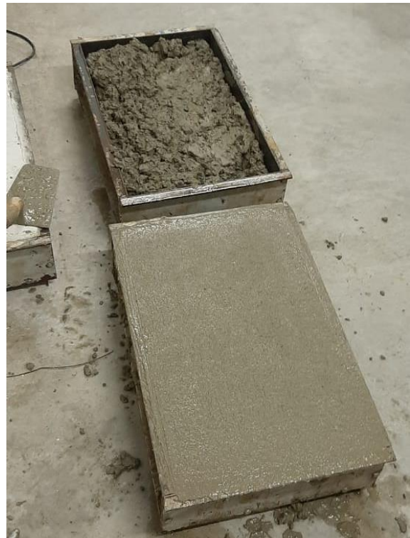
Figura 42: Elaboración de especímenes para ensayo de fisuración
