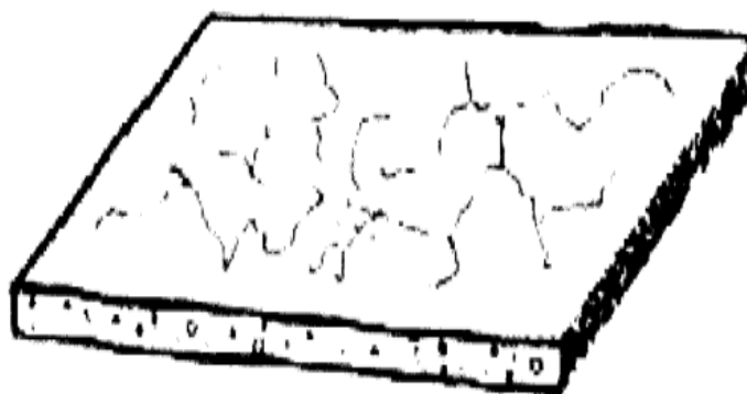
Figura 2: Fisuras por contracción plástica.
