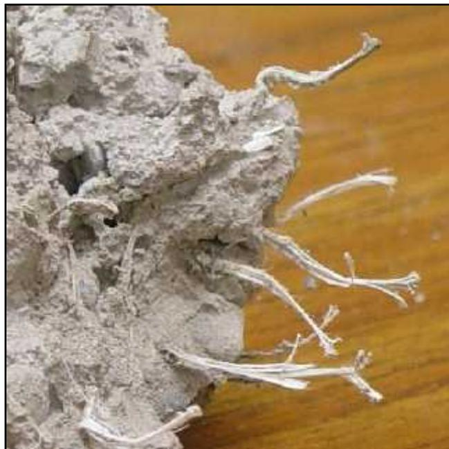
**Figura 5:** Concreto con fibra
