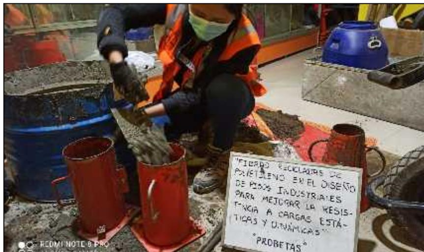
**Anexo 12:** Nivelación del Vaciado de probetas.
