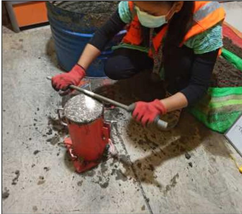
**Anexo 13:** Colocación para medir el Slump.
