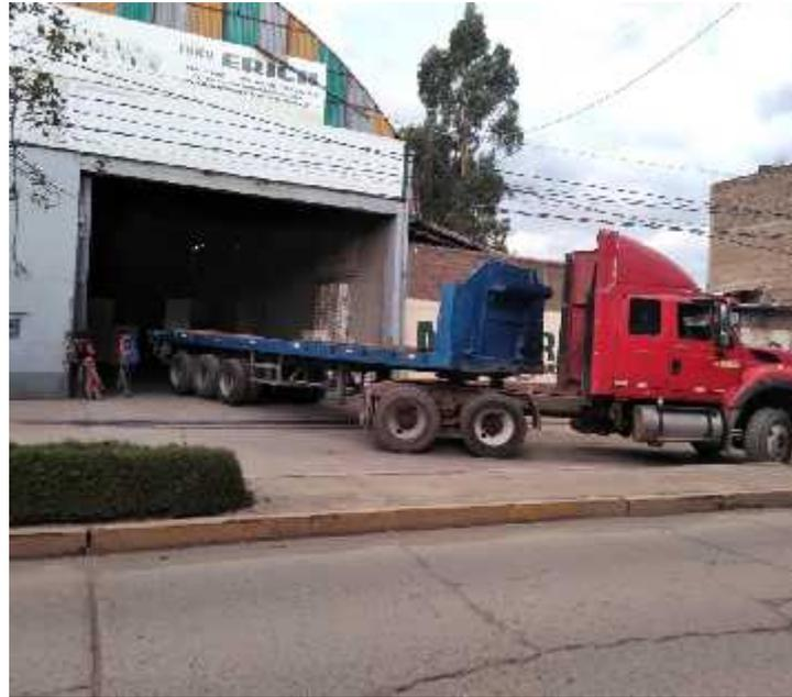
**Figura 51:** Cargas dinámicas con una configuración vehicular T3 S3.
