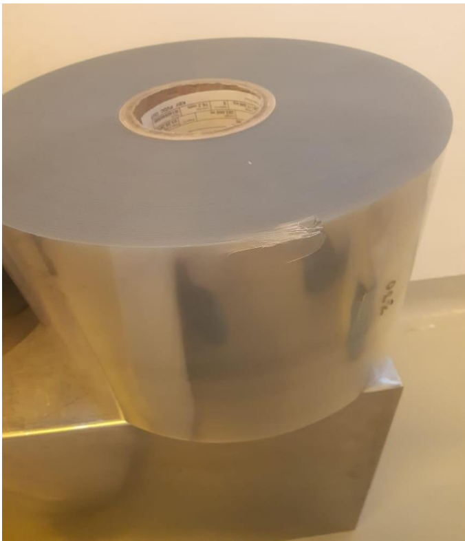
Anexo 26 Cinta PVC ámbar defectuosa
