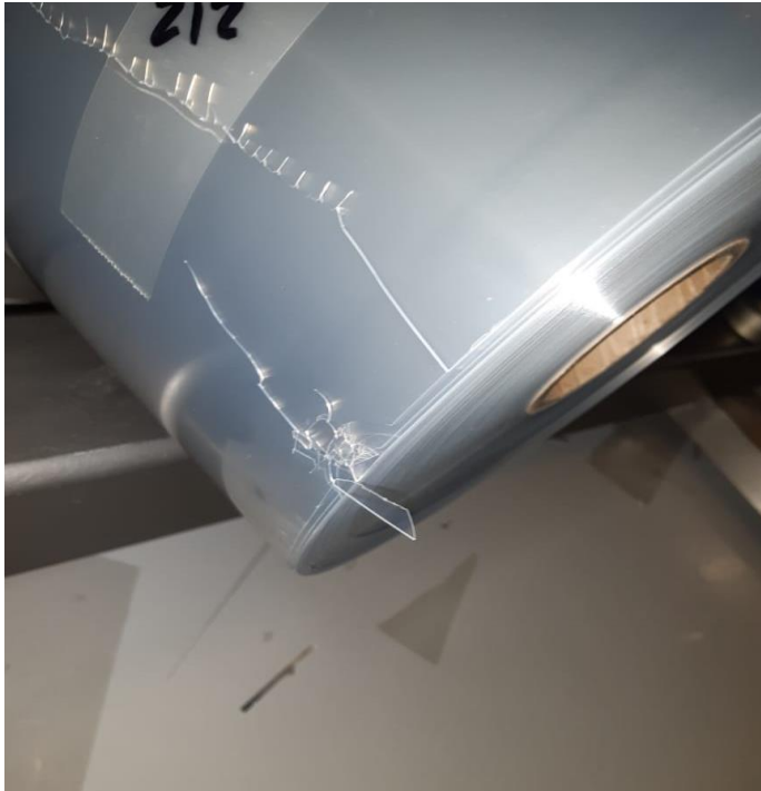
Anexo 25 Cinta de PCV defectuosa
