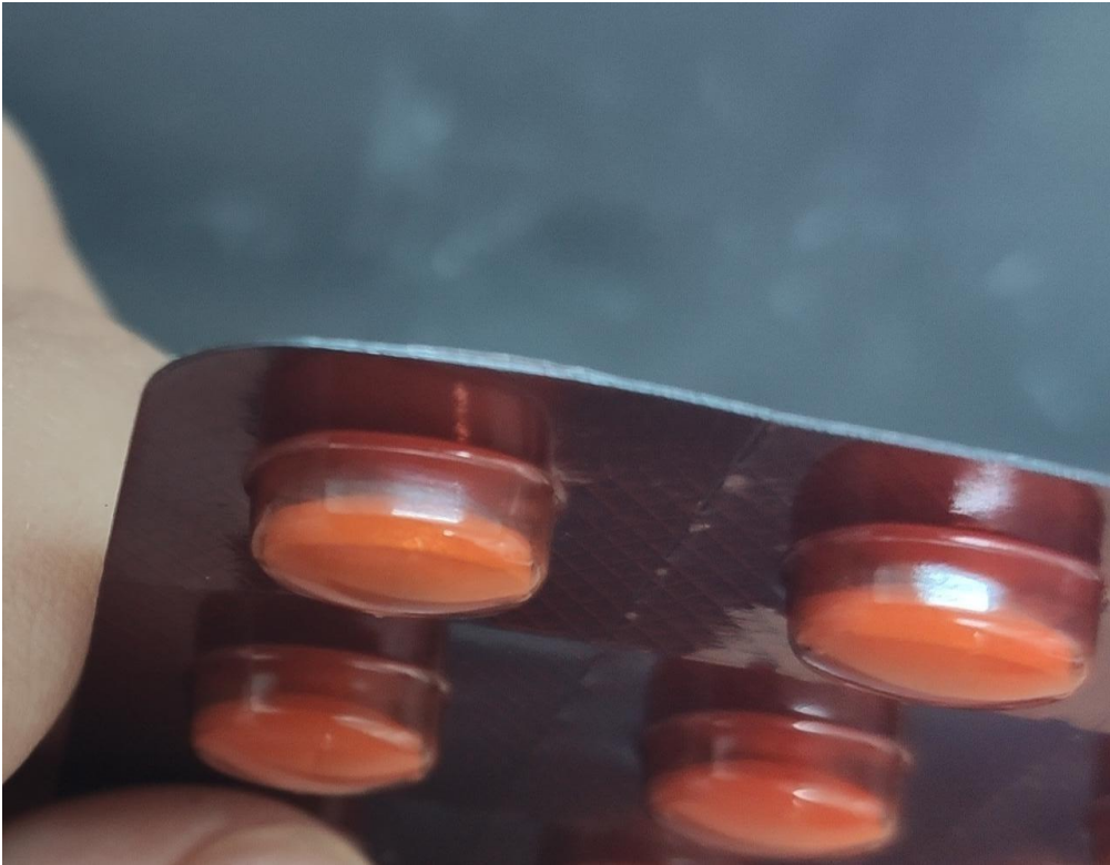
Anexo 36 Blister mal sellado
