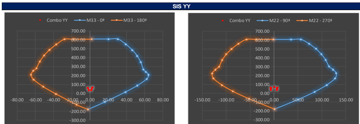
Figura 49: diagrama de interacción de la columna C5 – dirección “yy” Fuente: Etabs y SAP 2000
