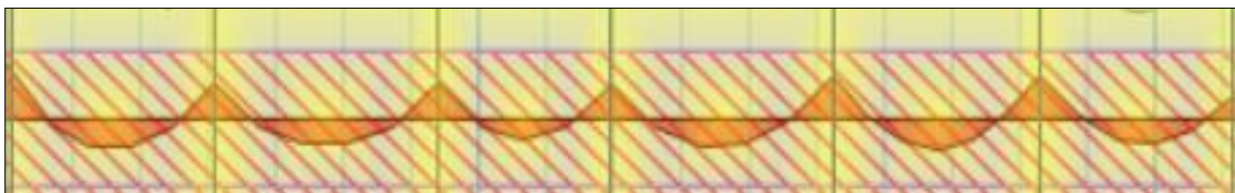
Figura 44: Diagrama típico de momentos flectores – metodo de las franjas Fuente: SAFE
