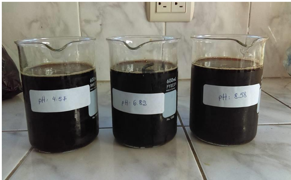
Fotografía 14. Muestra de agua recolectada con pH modificados de 4 y 8, manteniendo el pH original de la muestra de 6
