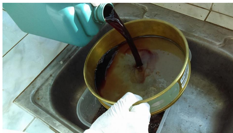
Fotografía 10. Separación de sólidos grandes, el agua recolectada pasada a través de la malla N°60
