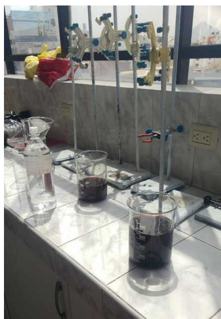
Fotografía 7. Medición de DBO y DQO de la muestra de agua del efluente final del Camal Municipal El Porvenir
