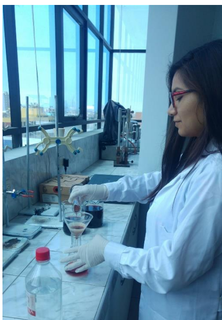
Fotografía 6. Medición de SST de la muestra de agua del efluente final del Camal Municipal El Porvenir
