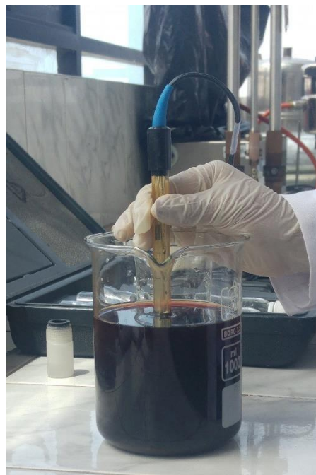
Fotografía 7. Medición de DBO y DQO de la muestra de agua del efluente final del Camal Municipal El Porvenir
