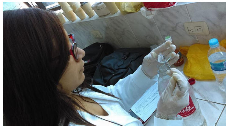
Fotografía 9. Obtención de la solución de Sulfato de Aluminio a concentración de 15000 ppm y floculante aniónico a 1000 ppm
