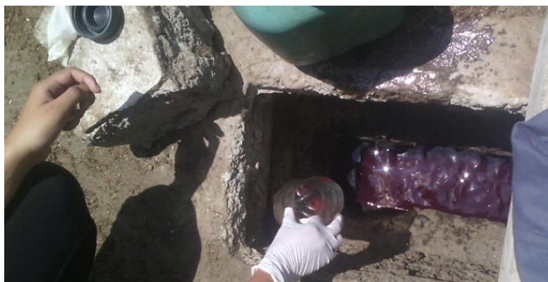
Fotografía 2. Toma de muestra del efluente final del Camal Municipal El Porvenir
