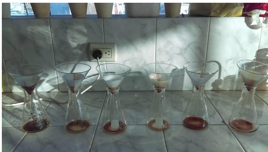
Fotografía 17. Proceso de filtración para medir SST
