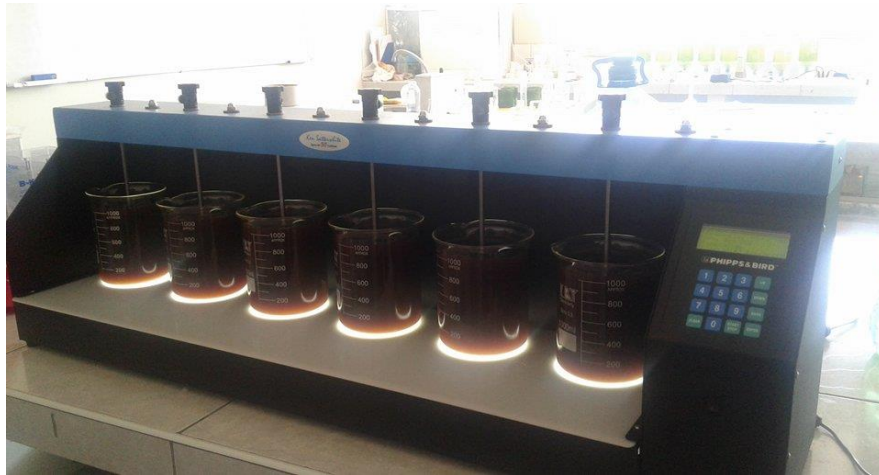
Fotografía 15. Test de jarra para simular el proceso de coagulación-floculación
