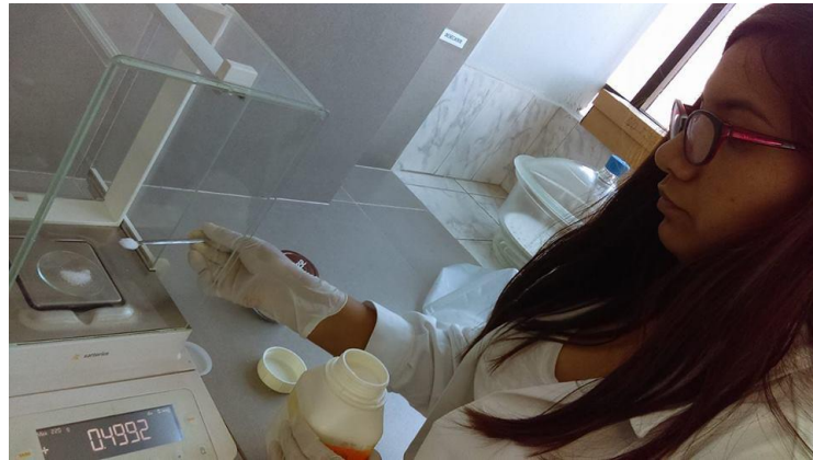
Fotografía 8. Pesaje del coagulante y floculante (granulado) para conseguir la solución líquida de cada uno de ellos
