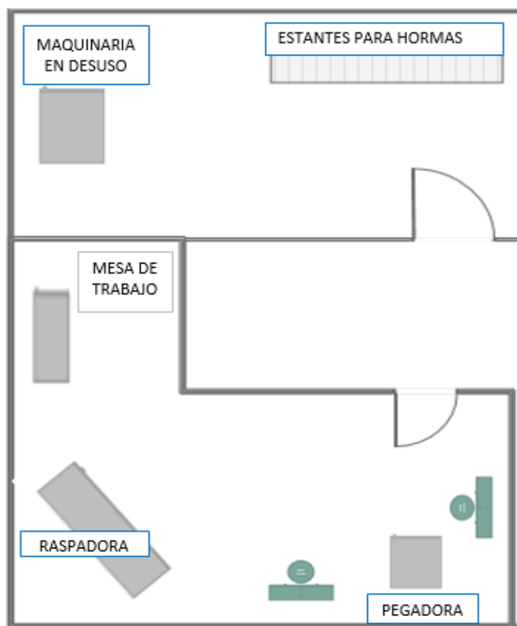
Figura 26: Reubicación de maquinarias en el área de armado
