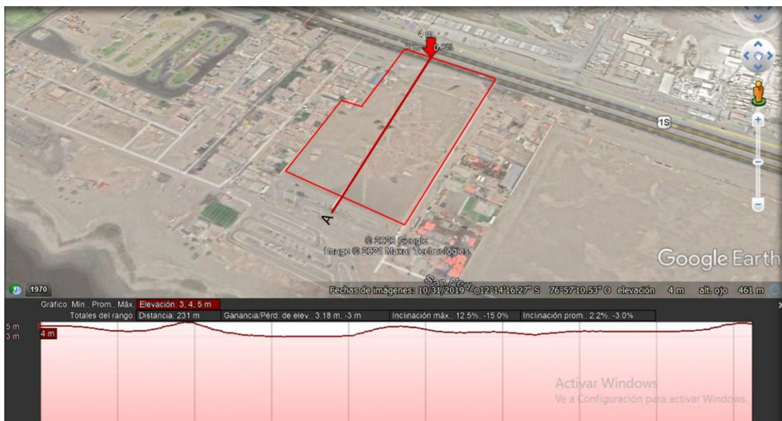
Figura 4.12 Corte A - A Longitudinal del Terreno a Intervenir
