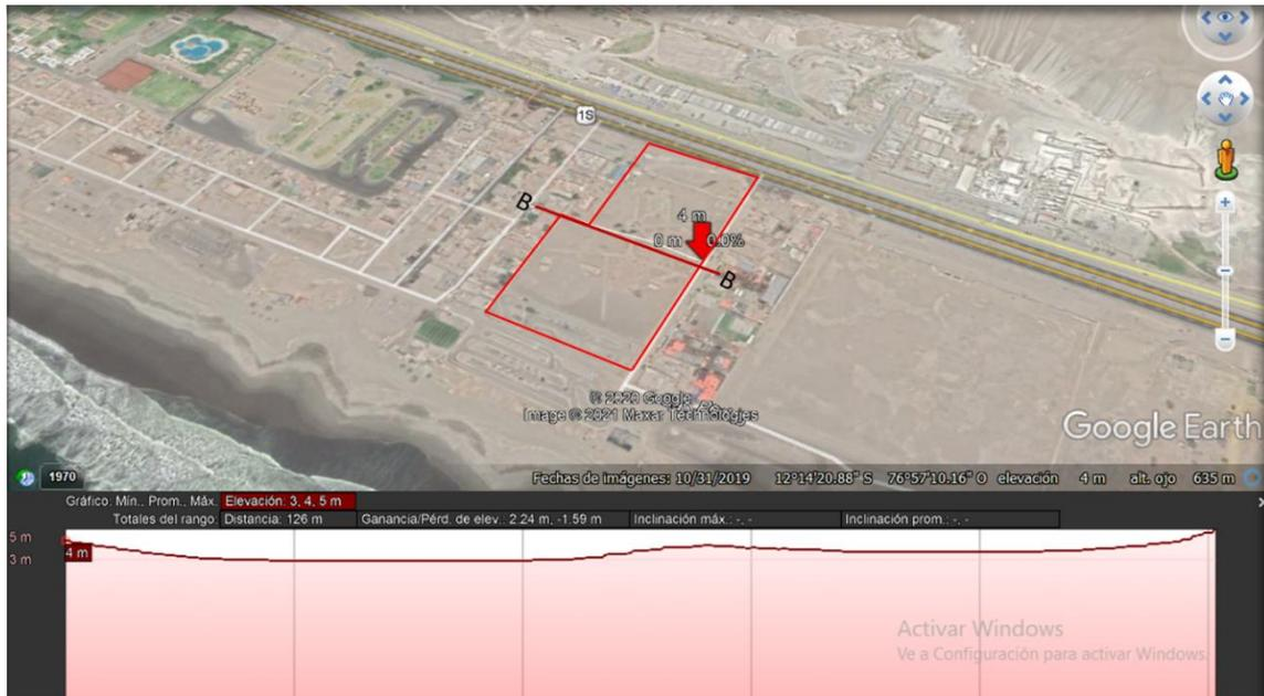
Figura 4.13 Corte B - B Transversal del Terreno a Intervenir
