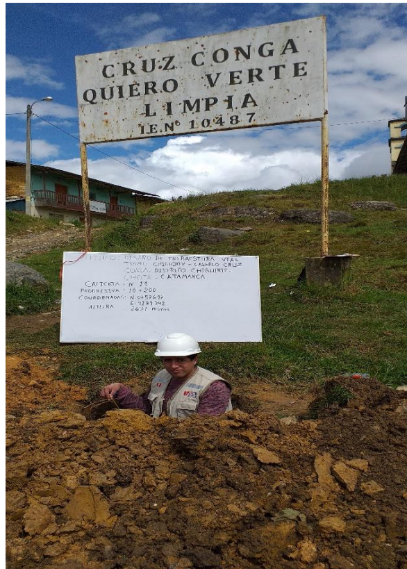
Figura 3: Presencia de suelos arcillosos de baja plasticidad color amarillo
