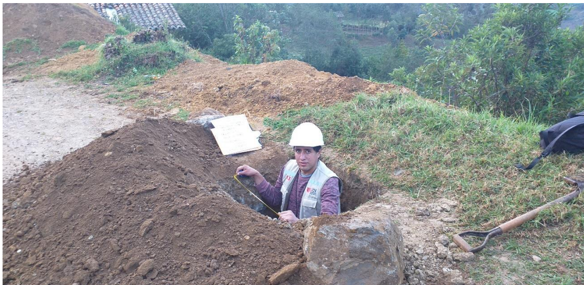
Figura 4: Exploración y muestreo de suelos
