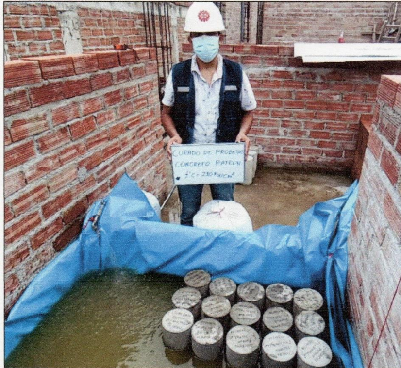
FOTOGRAFÍA 09: Curado de probetas de concreto Patrón.
