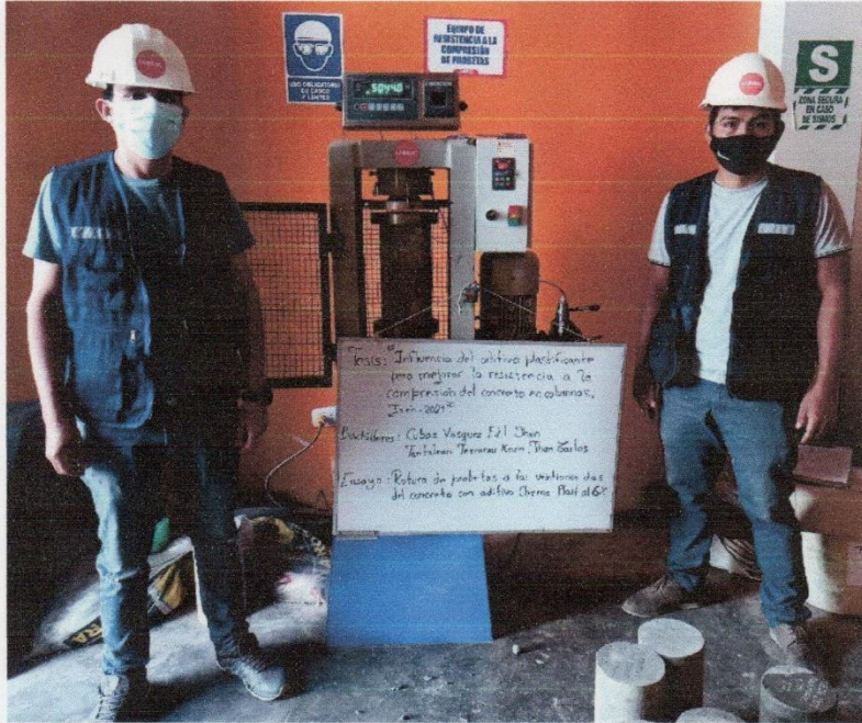
FOTOGRAFÍA 17 y 18: Ensayo a la compresión de testigos de concreto bajo la norma ASTM C39, de la muestra del concreto con aditivo Chema Plast al 6% a los 28 días.
