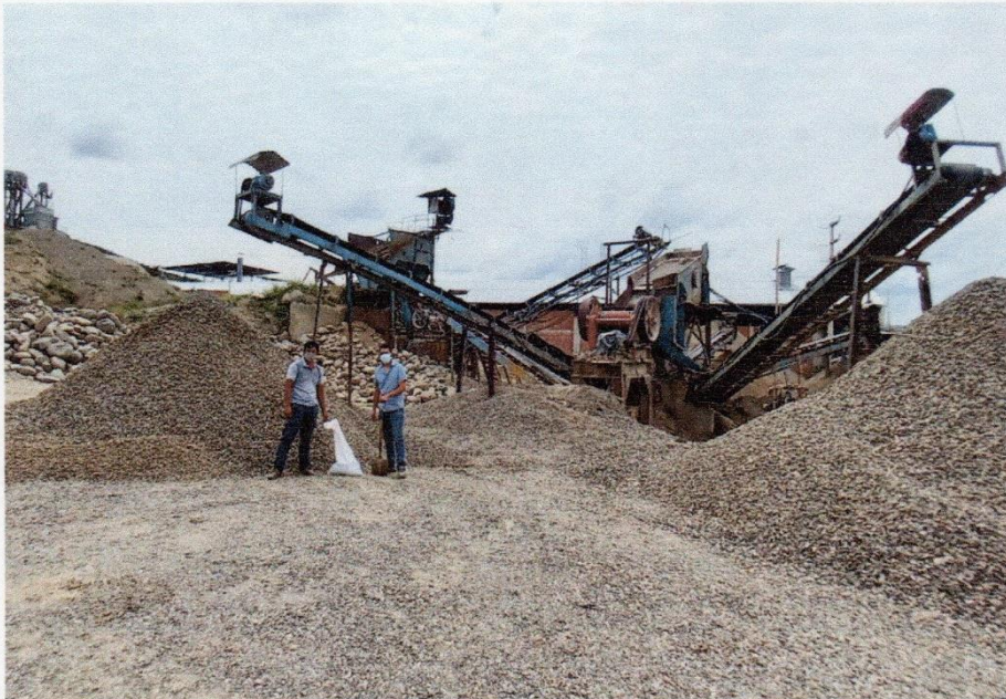
FOTOGRAFÍA 02: Extracción del agregado grueso de la cantera.
