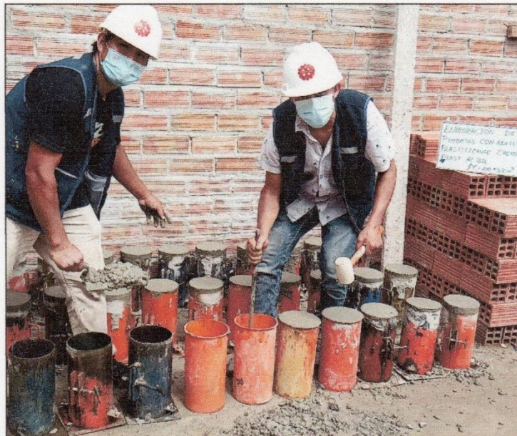
FOTOGRAFÍA 32: Llenado de probetas de concreto.
