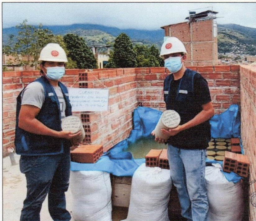
FOTOGRAFÍA 26: Colocación de probetas a la piscina de curado.
