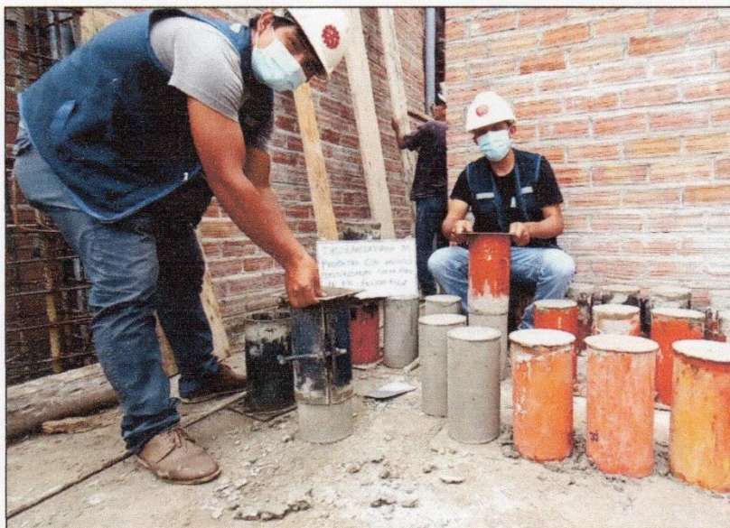
FOTOGRAFÍA 25: Desencofrado de probetas.
