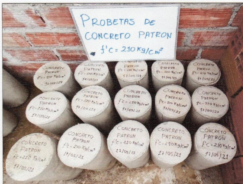
FOTOGRAFÍA 07: Probetas de concreto F'c=210 kg/cm 2 .
