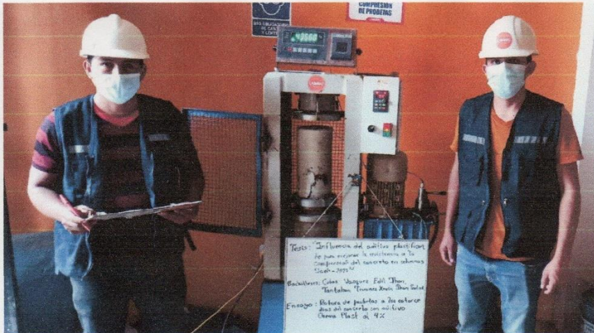
FOTOGRAFÍA 09: Ensayo a la compresión de testigos de concreto bajo la norma ASTM C39, de la muestra del concreto con aditivo Chema Plast al 4% a los 14 días.
