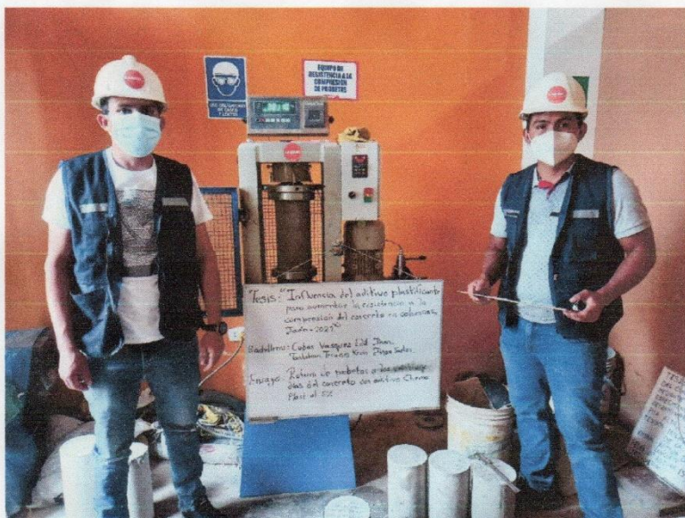
FOTOGRAFÍA 15: Ensayo a la compresión de testigos de concreto bajo la norma ASTM C39, de la muestra del concreto con aditivo Chema Plast al 6% a los 14 días.
