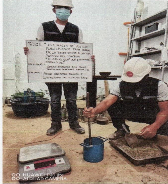
FOTOGRAFÍA 13: Peso unitario compactado de la muestra del agregado fino.
