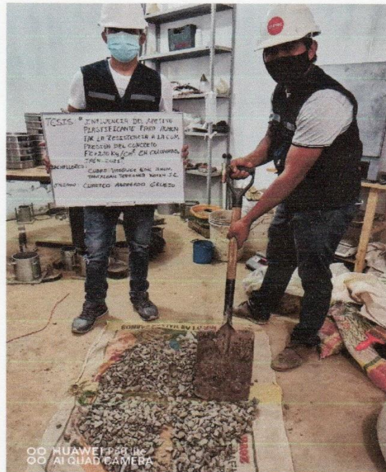
FOTOGRAFÍA 14: Cuarteo del agregado grueso.
