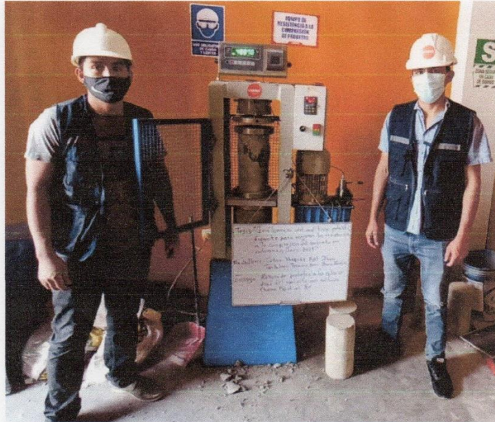
FOTOGRAFÍA 21: Ensayo a la compresión de testigos de concreto bajo la norma ASTM C39, de la muestra del concreto con aditivo Chema Plast al 8% a los 14 días
