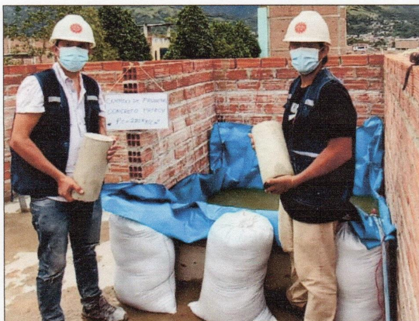
FOTOGRAFÍA 08: Colocación de probetas de concreto patrón a la piscina de curado.
