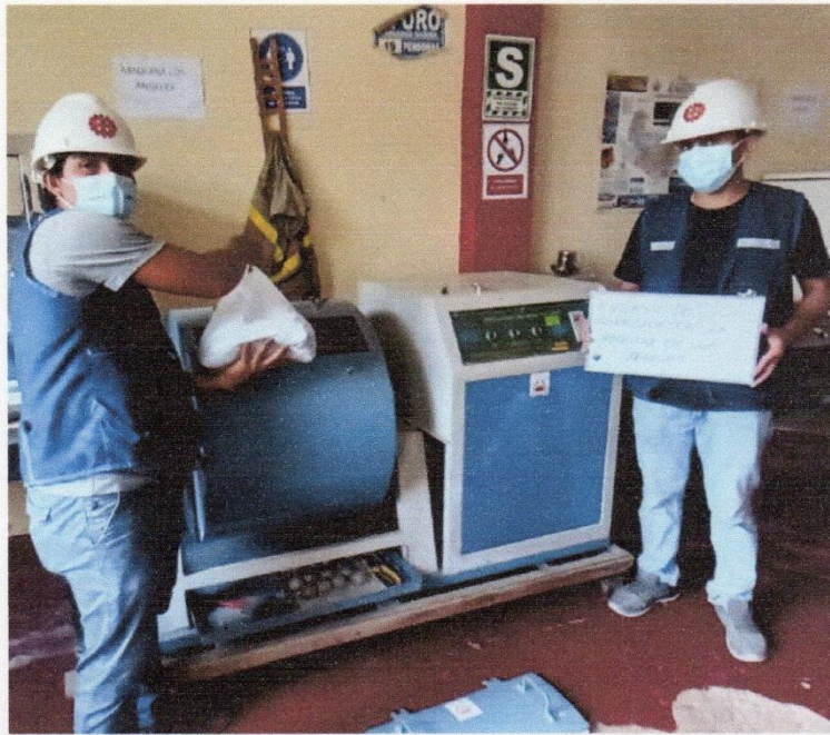
FOTOGRAFÍA 23: Ensayo de abrasión del agregado grueso en la Maquina de los Ángeles.
