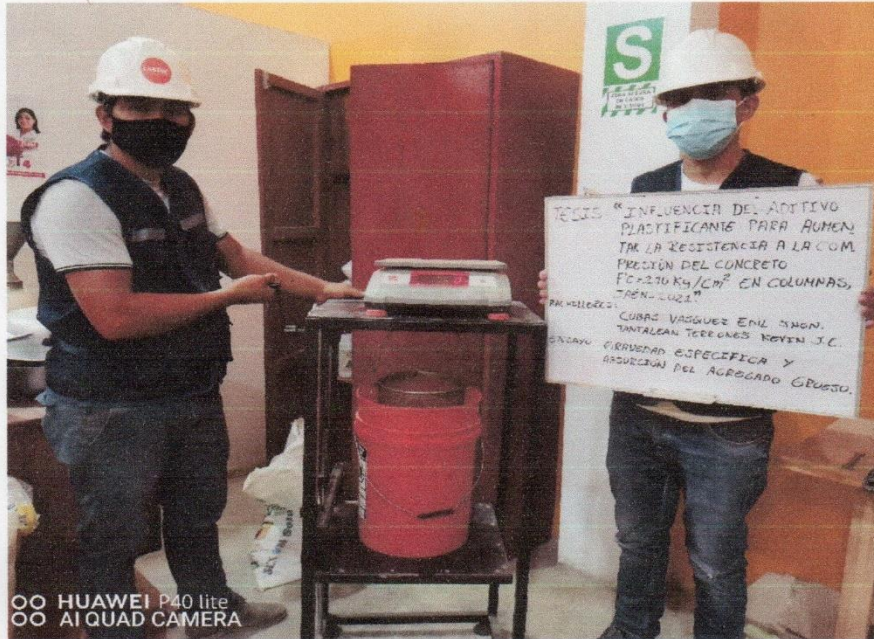
FOTOGRAFÍA 19: Determinación de gravedad específica y absorción de la muestra.
