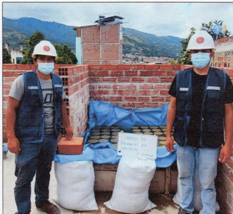
FOTOGRAFÍA 36: Curado de probetas patrón y con Aditivo Plastificante Chema Plast al 4%, 6% y 8%.
