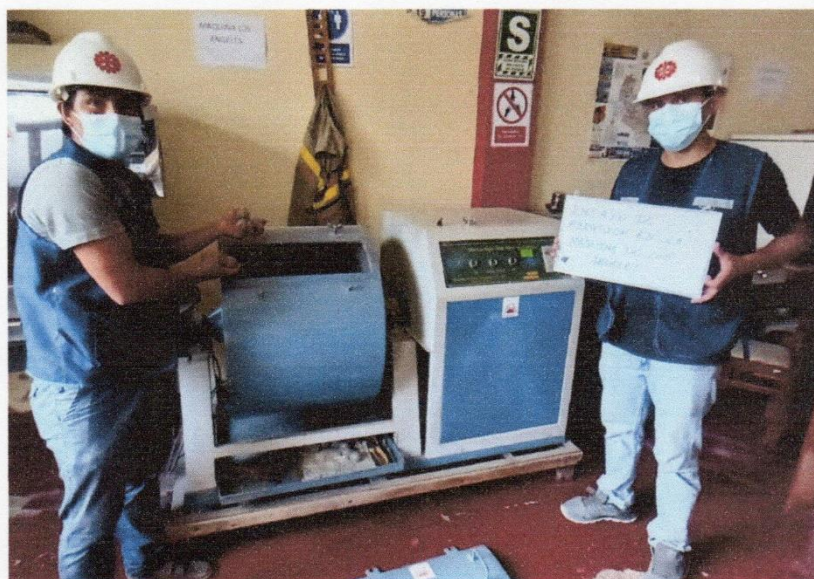
FOTOGRAFÍA 24: Determinación de abrasión del agregado grueso en la Maquina de los Ángeles.
