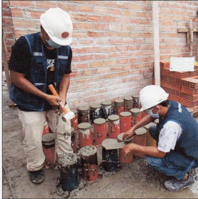
FOTOGRAFÍA 33: Chuseado, vibrado y enrasado de probetas.
