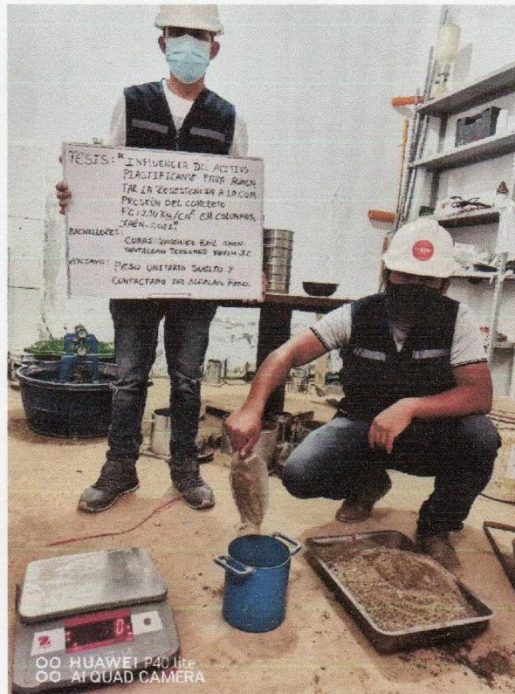
FOTOGRAFÍA 12: Peso unitario suelto de la muestra del agregado fino.
