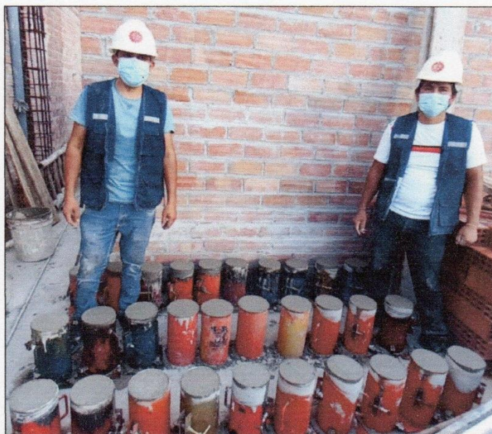
FOTOGRAFÍA 15: Probetas de concreto con aditivo Chema Plast al 4%.
