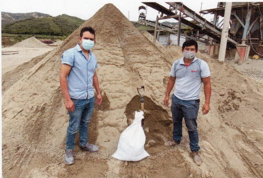
FOTOGRAFÍA 04: Extracción de agregado fino de la cantera.
