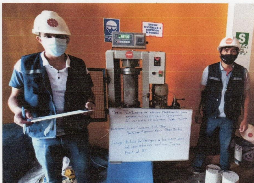
FOTOGRAFÍA 20: Ensayo a la compresión de testigos de concreto bajo la norma ASTM C39, de la muestra del concreto con aditivo Chema Plast al 8% a los 7 días.
