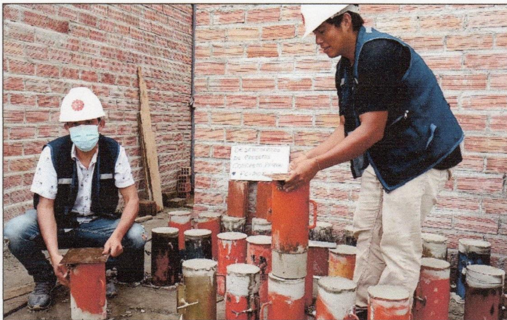
FOTOGRAFÍA 06: Desencofrado de probetas de concreto patrón.
