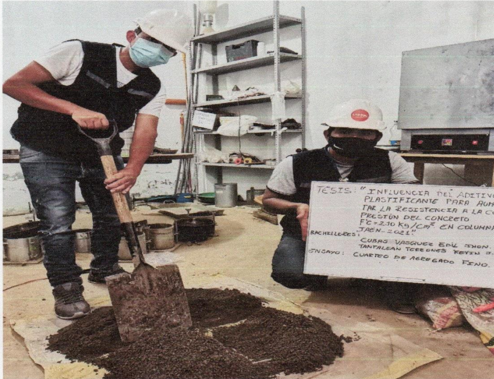
FOTOGRAFÍA 05: Cuarteo de agregado fino.
