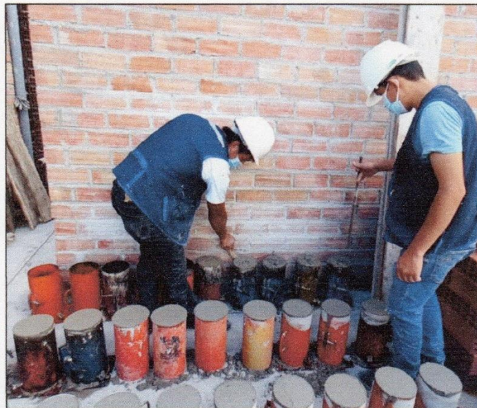
FOTOGRAFÍA 14: Llenado, chuseado y vibrado de probetas de concreto.
