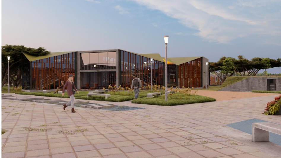
Figura 11. Estructuras aporticadas, coberturas metálicas, y cerramientos de muro cortina con celosías de acabado en madera.
