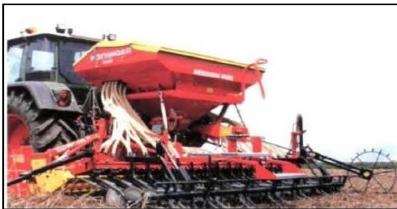
Figura 7. Sembradora a chorrillo neumática con elemento dosificador centralizado.
