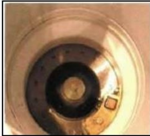
Figura 9. Plato dosificador horizontal de sembradora mecánica monograno.
