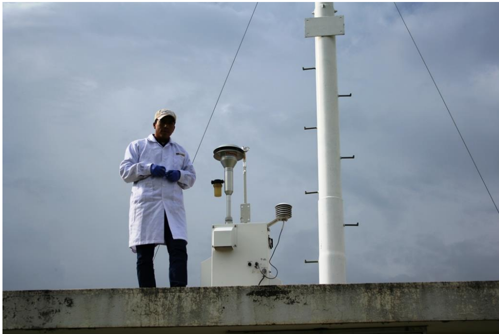
Foto 4. Ubicación del equipo colector de material particulado atmosférico junto a la torre de mediciones de vientos de 10 m de altura.
