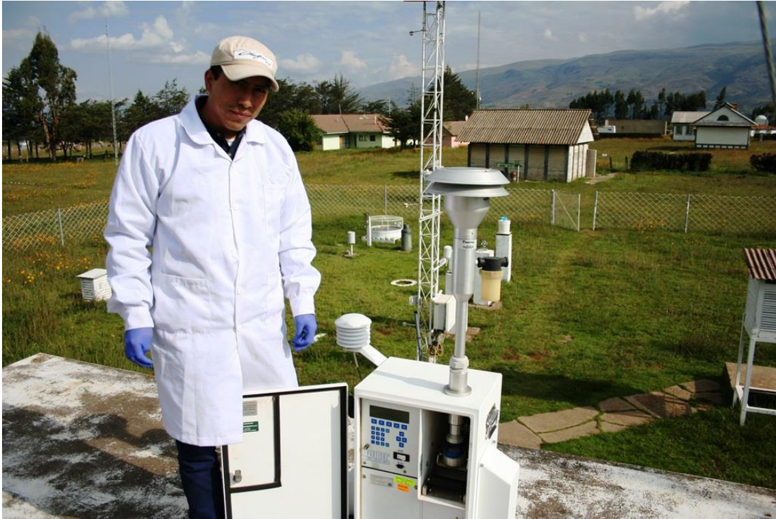
Foto 3. Labor de muestreo en campo del material particulado mostrando el equipo utilizado: sistema Partisol de bajo volumen de marca Thermo Scientific con control de flujo.
