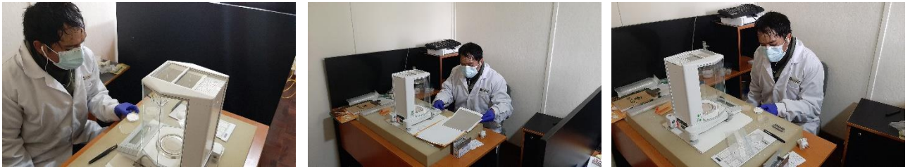
Figura 6. Pesado de varios filtros de teflón de porosidad 2.0 \mu\text{m} con porta filtros
