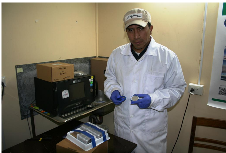
Foto 1. Labor de cambio de filtros de teflón de 47 mm de diámetro para colecta de material particulado atmosféricos utilizando un muestreador Partisol de bajo volumen.
