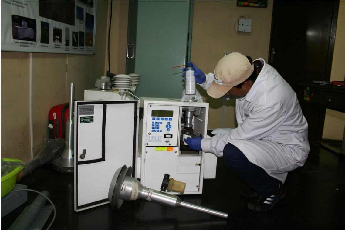
Foto 5. Realizando labores de limpieza y mantenimiento de equipo Partisol como limpieza del área de ubicación del filtro, limpieza del ciclón y cabezal de toma de muestra.
