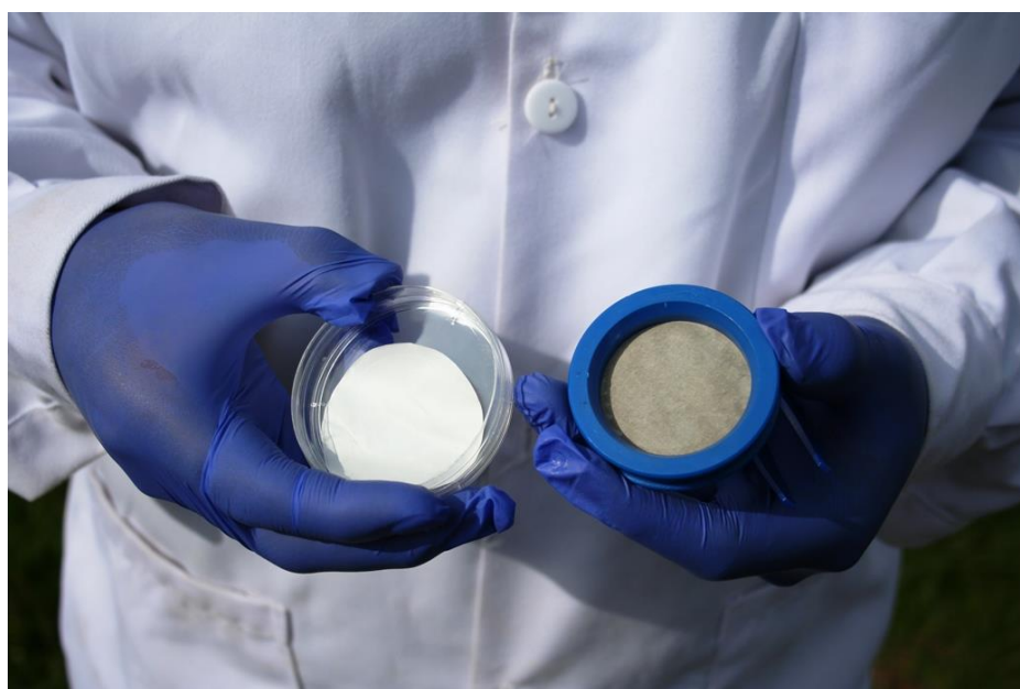
Foto 2. Un acercamiento al filtro de teflón para notar el cambio de color debido a la presencia del material particulado atmosférico sobre diversos lugares de la metrópoli de Huancayo.
