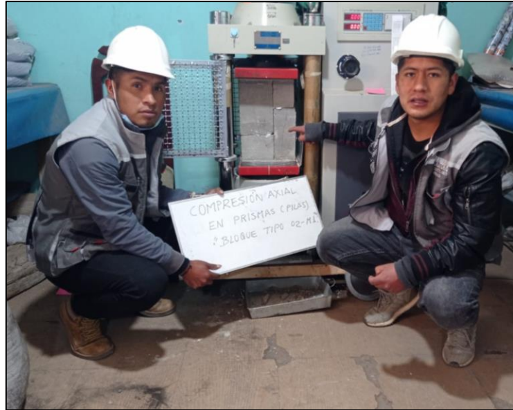
Figura 53. Ensayo de pila elaborado con bloques tipo II.
