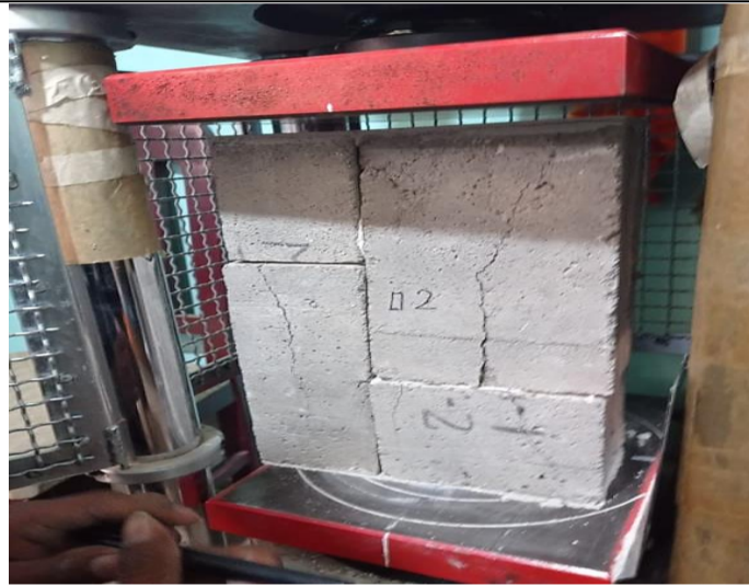
Compresión axial de pila M – 2.
