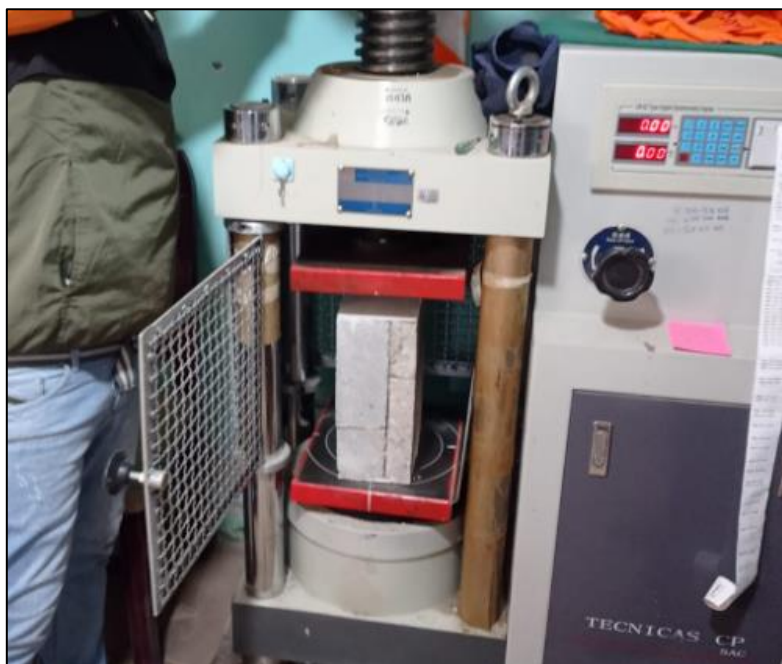
Figura 52. Ensayo de pila elaborado con bloques tipo I.
