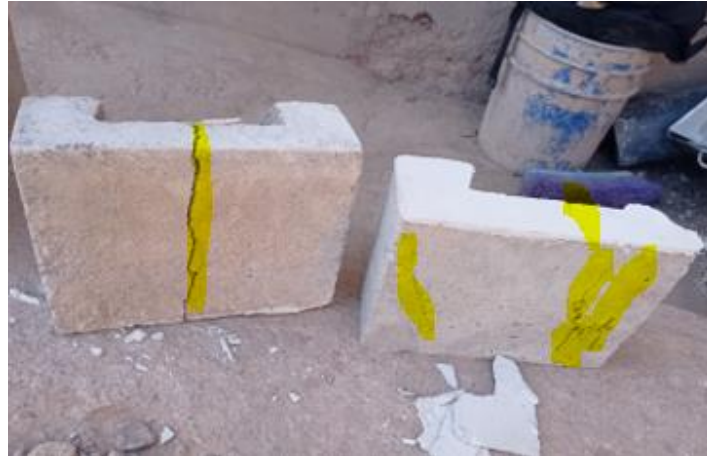
Figura 71. Fallas en unidades de albañilería, bloque tipo I.
