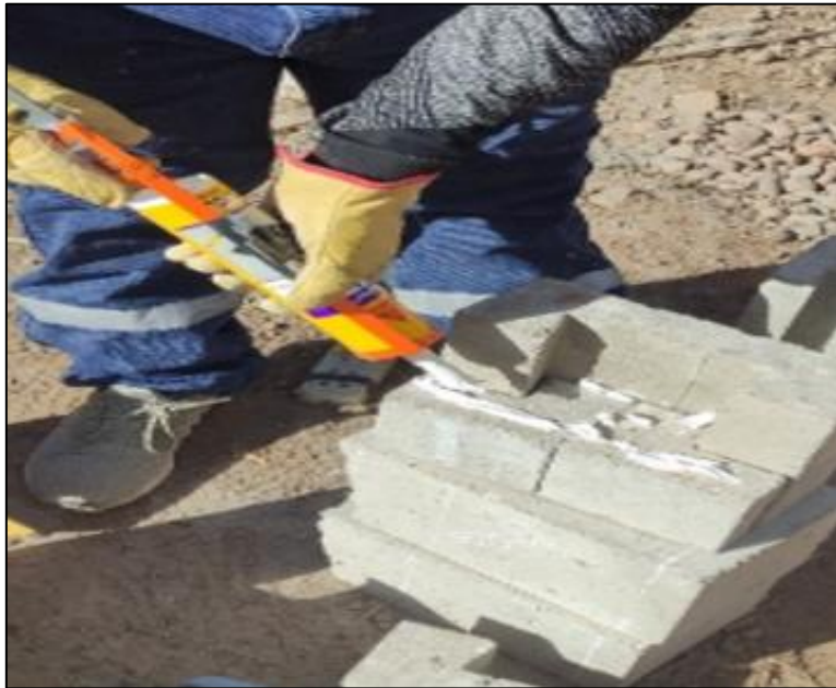
Figura 49. Aplicación de Sikaflex 118 para elaborar la pila tipo I.
