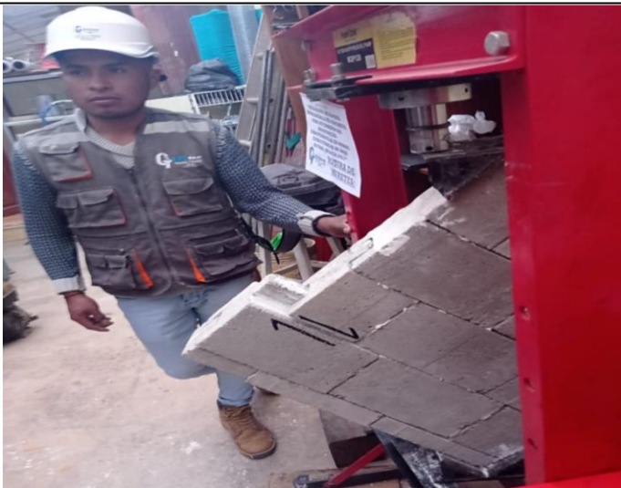
Perfil de ensayo de albañilería al corte de murete elaborados con bloque tipo II, M-1
