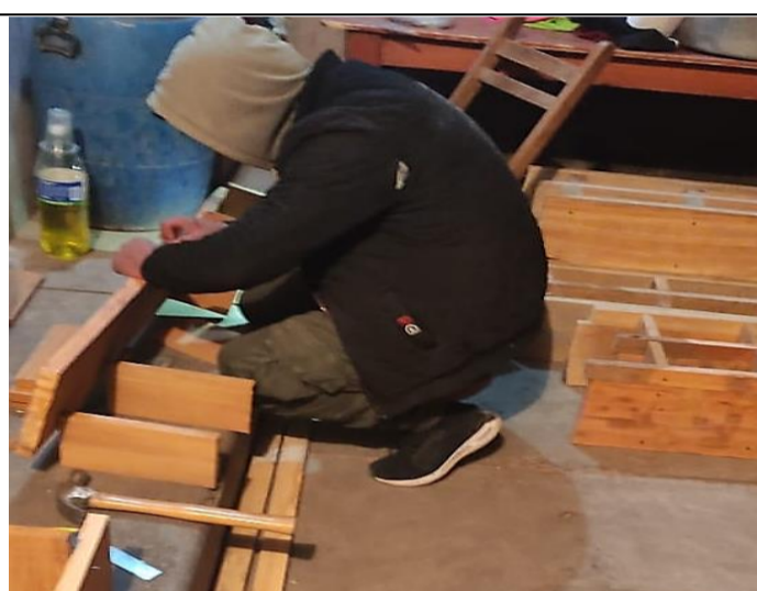
Trazo respectivo de molde de bloque tipo I para su clavado y armado.
