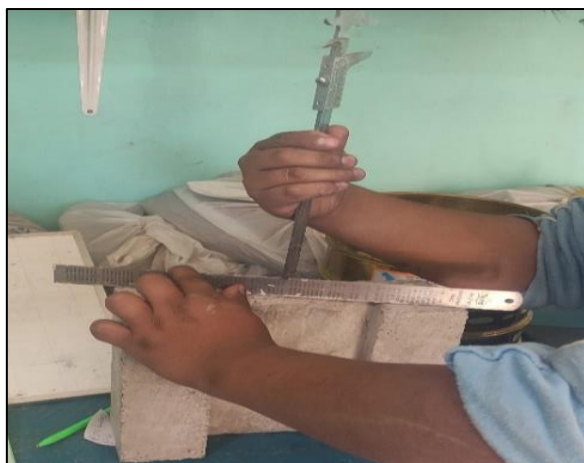
Figura 46. Medición de la distorsión de la superficie.
