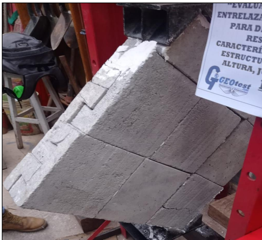
Figura 59. Falla por tensión diagonal en el murete T1 M-2.
