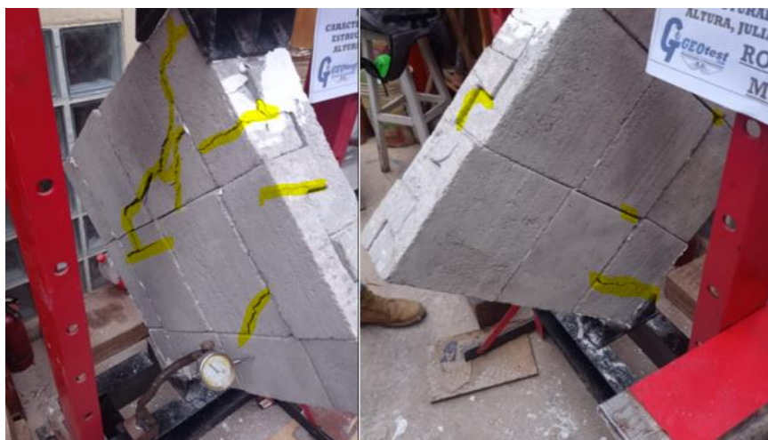
Figura 77. Tipo de fallas en muretes confeccionados con bloques tipo I.
