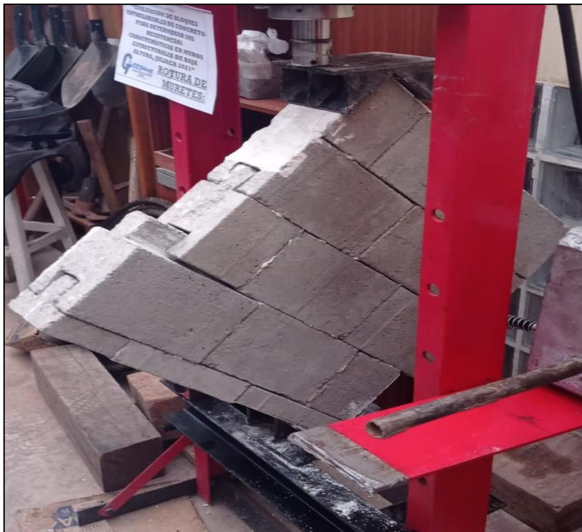
Figura 61. Falla por deslizamiento en el murete T2-M-1.
