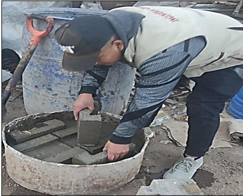
Figura 40. Inmersión de los bloques tipo I y II en agua.
