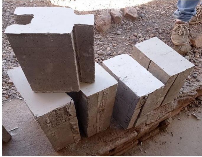
Refrentado o capping en bloques y pilas.
