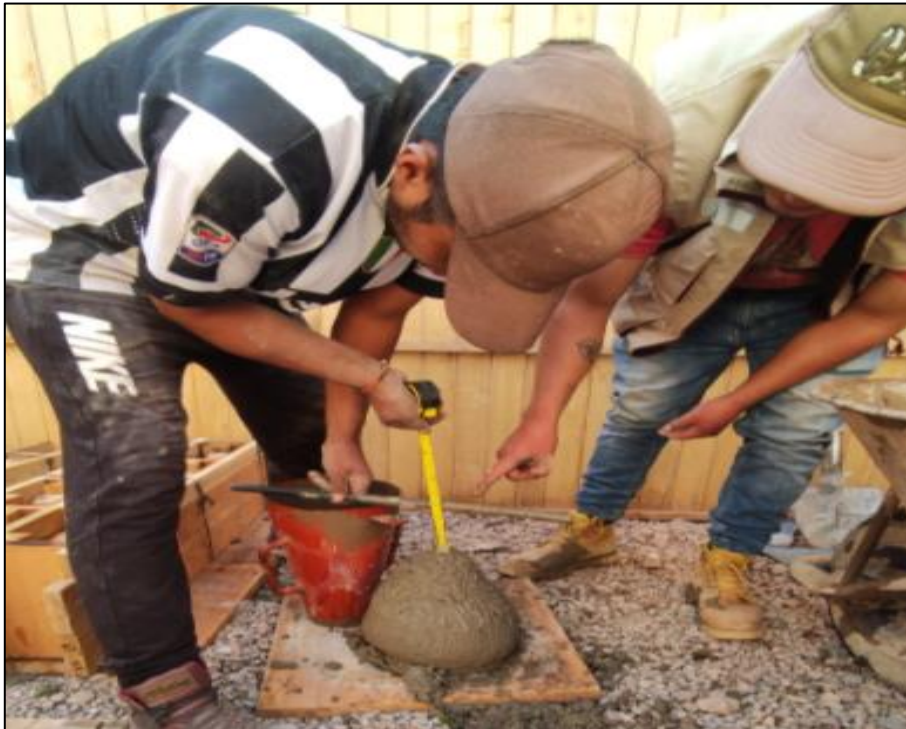
Figura 37. Ensayo de Slump con un revenimiento de 3”.
