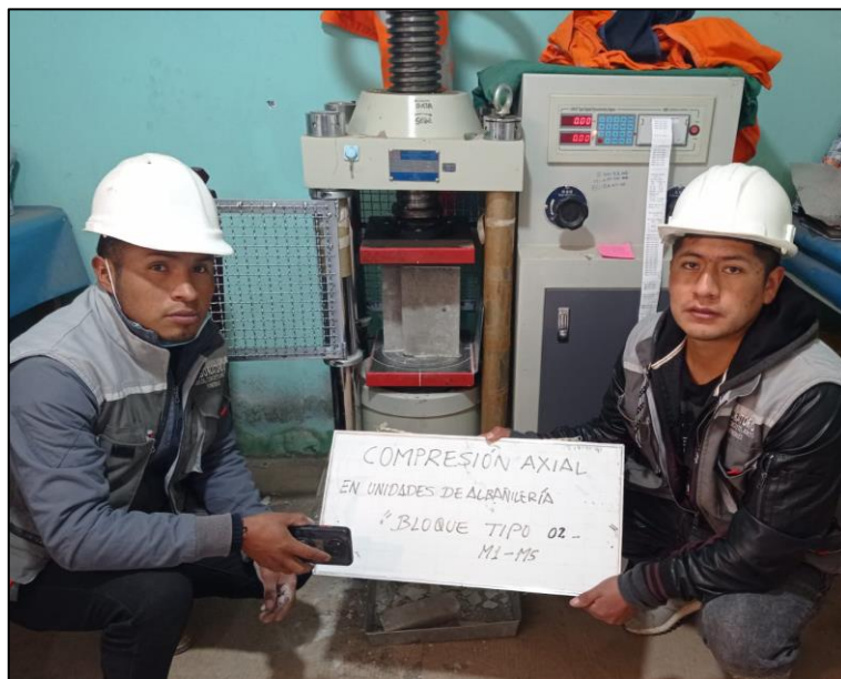
Figura 48. Bloque tipo II sometido a compresión axial.
