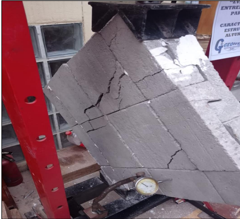
Figura 60. Falla por tensión diagonal en el murete T1-M-5.
