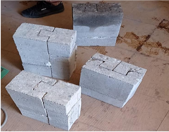
Proceso de pilas de concreto elaborados con bloques de tipo I y tipo II.
