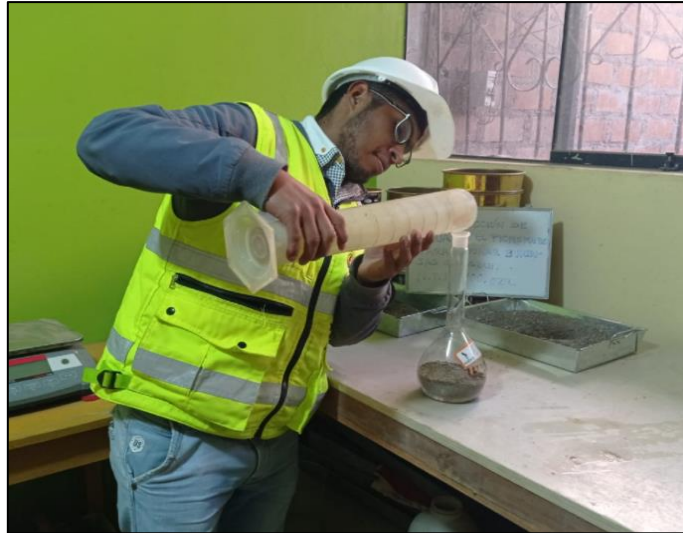
Figura 29. Vertiendo agua al picnómetro para eliminar burbujas.
