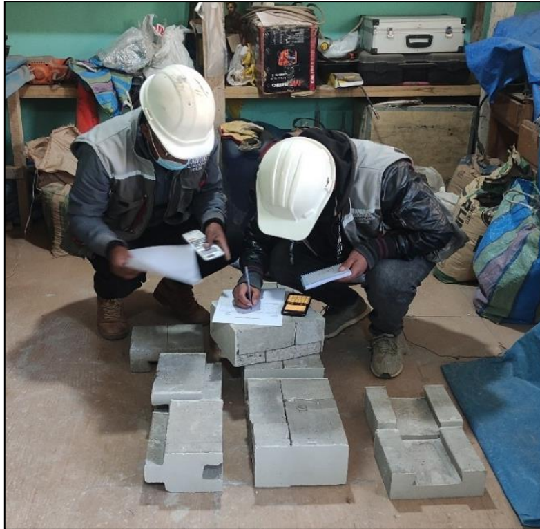
Figura 51. Registro de las dimensiones de las pilas a ensayar.
