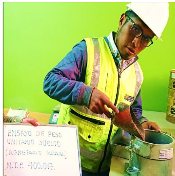
Figura 30. Adición del agregado grueso en el molde de CBR.
