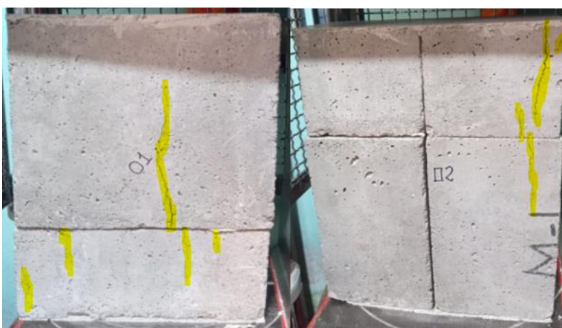
Figura 74. Tipo de fallas en pilas confeccionadas con bloques tipo I.
