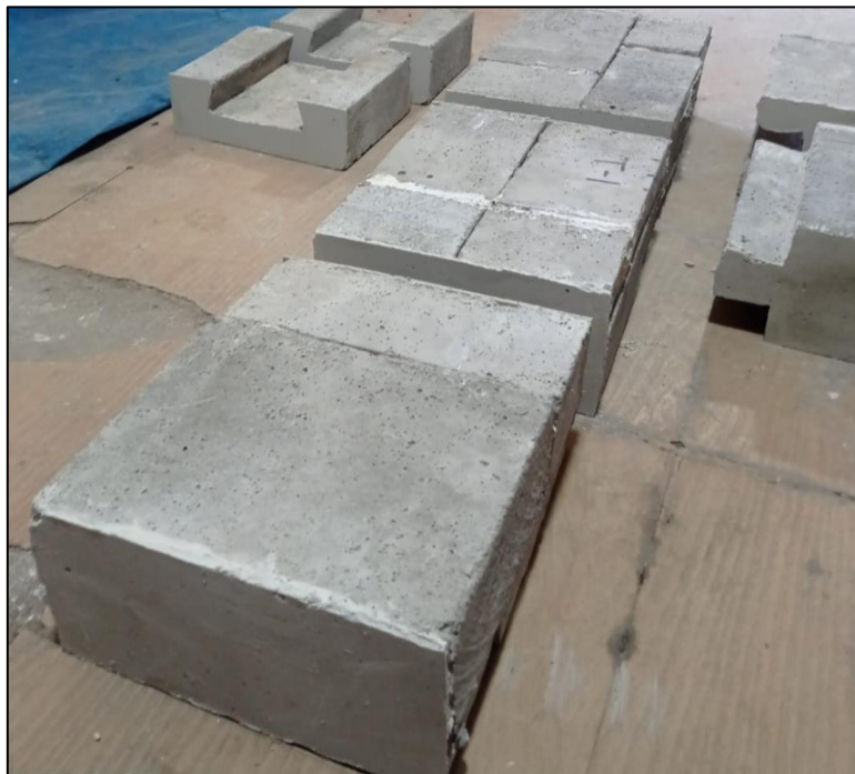
Figura 50. Construcción de pilas con bloques tipo II.
