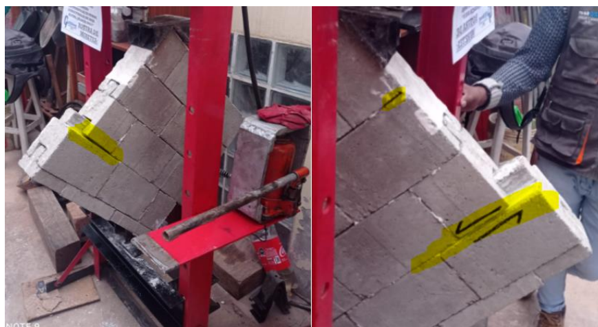
Figura 78. Tipo de fallas en muretes confeccionados con bloques tipo II.
