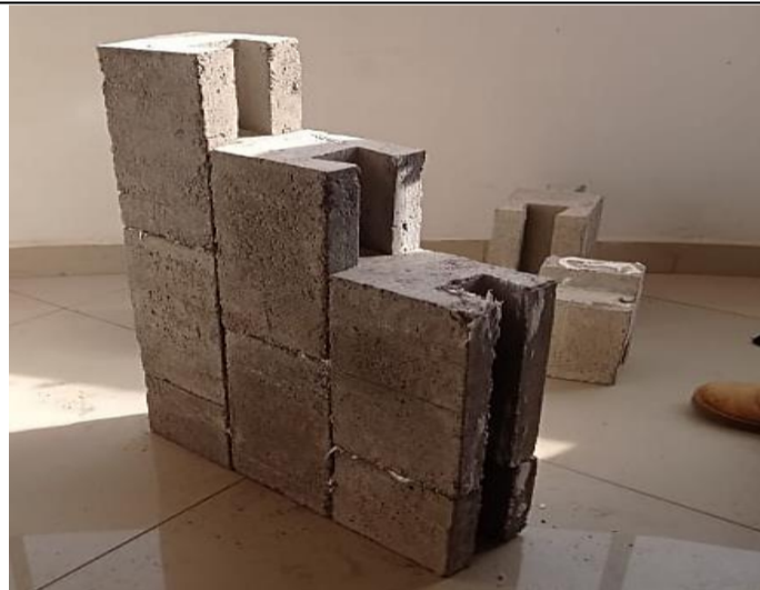
Proceso de armado de murete con bloque tipo II y pegado con Sikaflex-118
