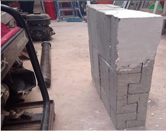
Refrentado de murete.
