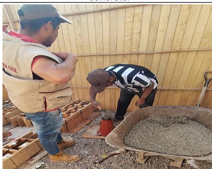
Revenimiento de concreto con el ensayo de cono de Abrams al inicio de cada proceso.
