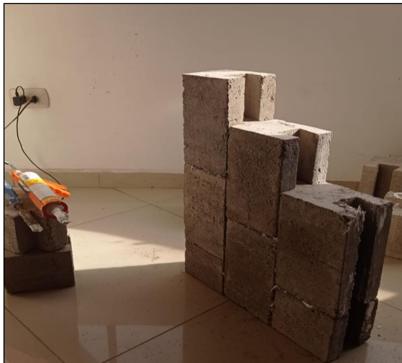
Figura 55. Elaboración de Murete con bloques tipo II.
