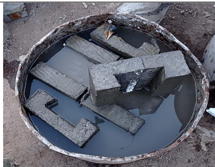
Sumergido en cilindro para su respectivo curado.
