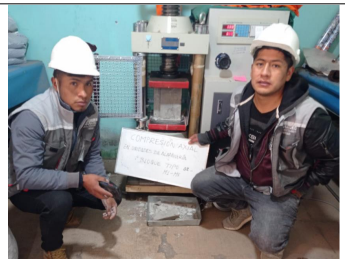
Compresión axial de bloque tipo II.
