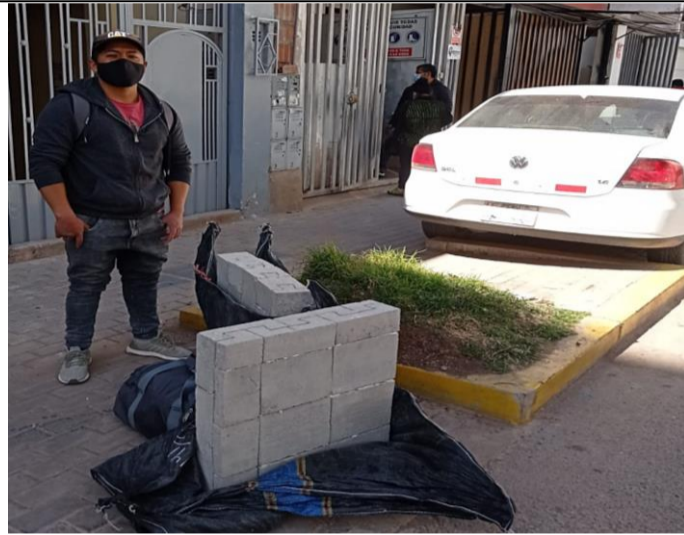
Traslado de muretes al laboratorio para su ensayo respectivo.
