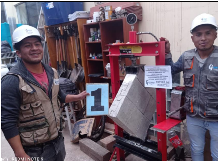
Perfil de falla de deslizamiento de murete sometido a compresión.
