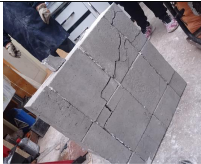
Perfil de ensayo de murete con el personal técnico de laboratorio.
