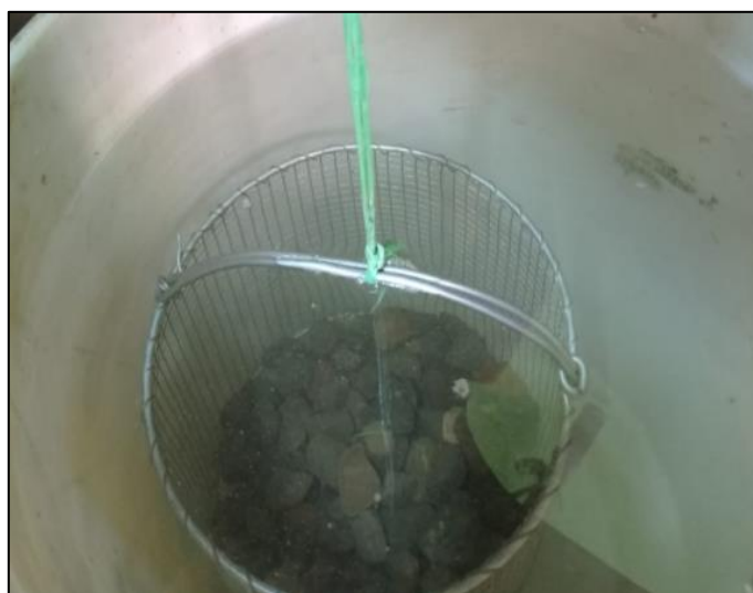
Figura 28. Peso de la muestra saturada en el agua.
