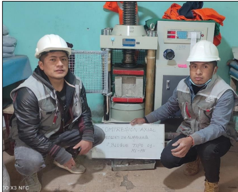
Figura 47. Bloque tipo I sometido a compresión axial.
