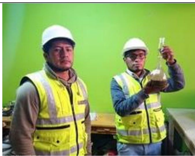
Agitar el agua manualmente para eliminar las burbujas del picnómetro.
