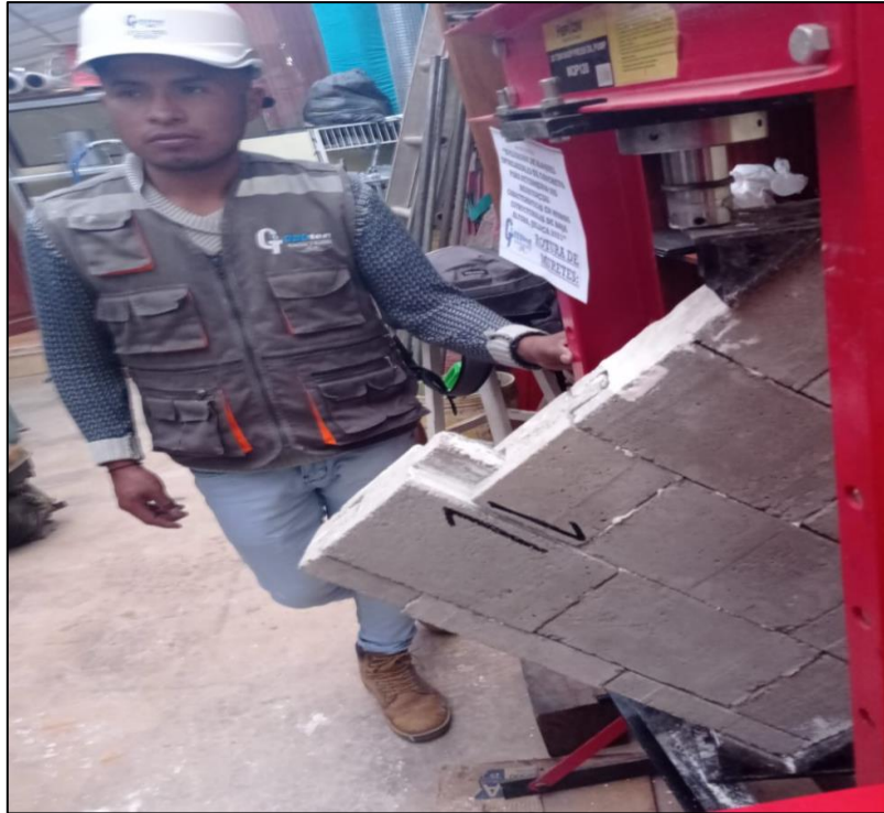
Figura 62. Falla por deslizamiento en el murete T2-M-4.
