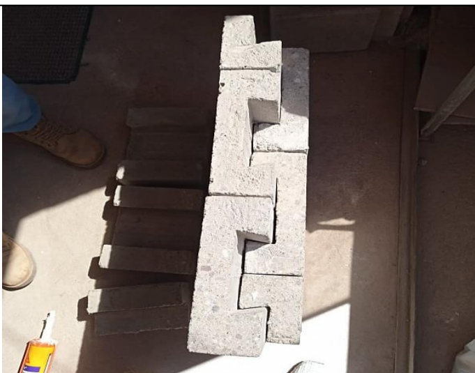
Inicio de armado de muretes 0.60mx 0.60m con bloque tipo I.
