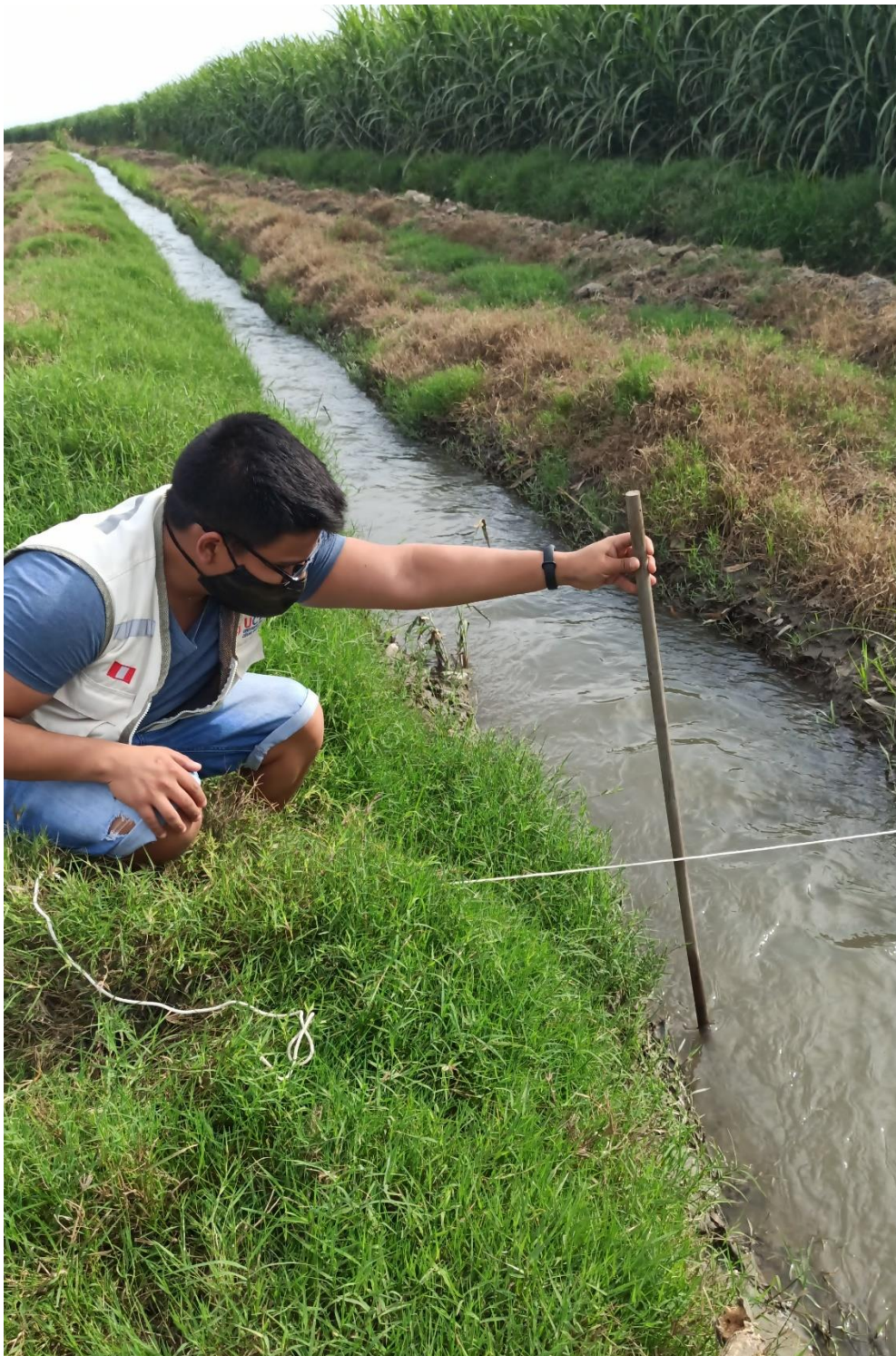
Figura 29 – Realizando las medidas de los perfiles de cada sección
