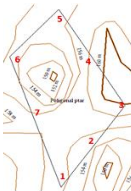
Figura 21 – Topografía obtenida en la zona donde se hizo el diseño de la PTAR
