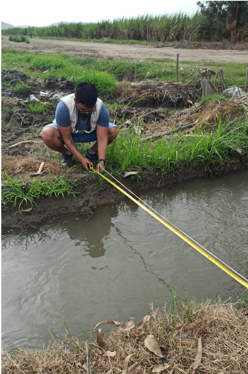
Figura 28 – Medición del ancho del canal
