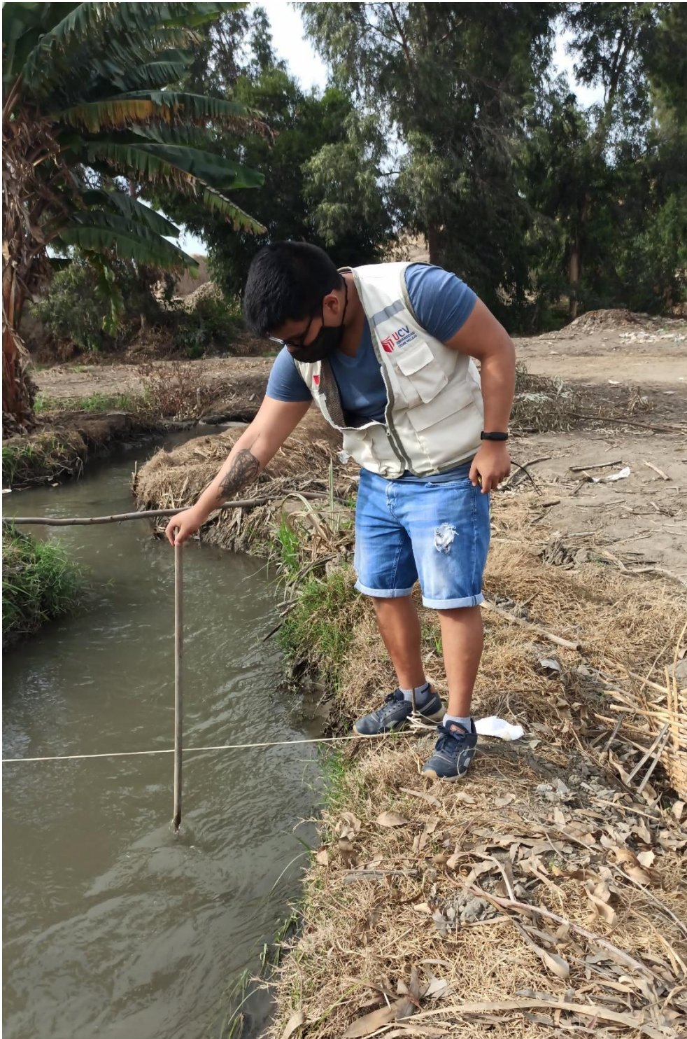
Figura 31 – Continuando con la medición de la profundidad del canal
