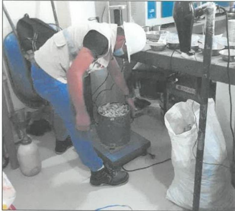
Fotografía N° 09. Obtención de la Ceniza de bagazo de Caña
