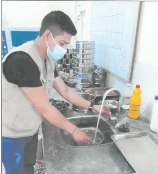
**Fotografía N° 03. Lavado del Agregado grueso**
