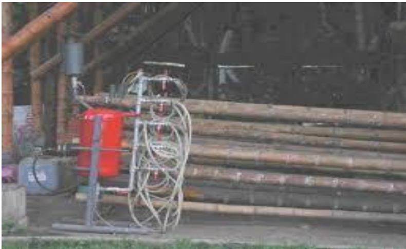
Imagen 9: Inyección del perseverante a presión para tratamiento de varios bambúes
