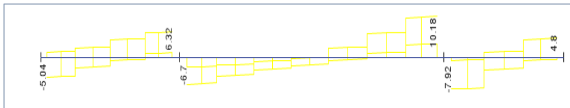
Figura N° 51. Diagrama de fuerza cortante en vigas VP1 0.30X0.55
