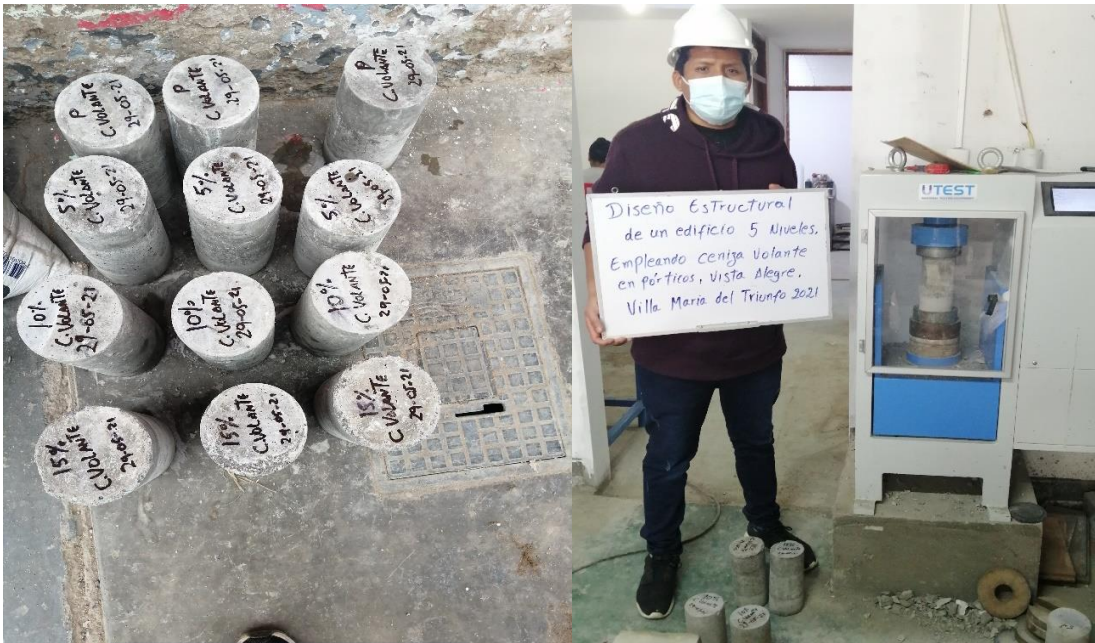
Probetas a los 28 días
