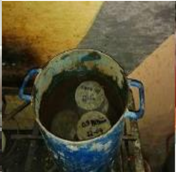
Hervido y ebullición de las rodajas de concreto
