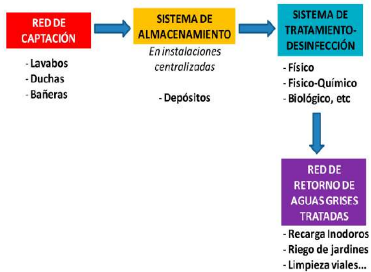
Figura 60: Tratamiento de aguas grises Fuente: Confort Chiller Lenox Refac S.A.
