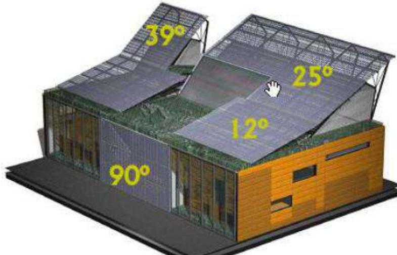
Figura 63: Disposición y alineamiento de paneles solares, Fuente: Panel Solar Perú S.A.
