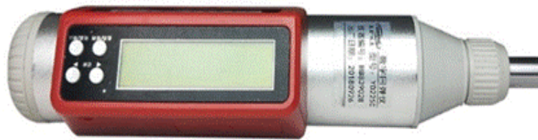
Figura 33. Esclerómetro Marca: RHC3-D, N° de serie: 181207
