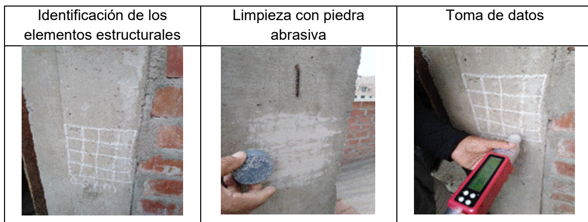
Figura 34. Procedimiento para toda de datos con el esclerómetro
