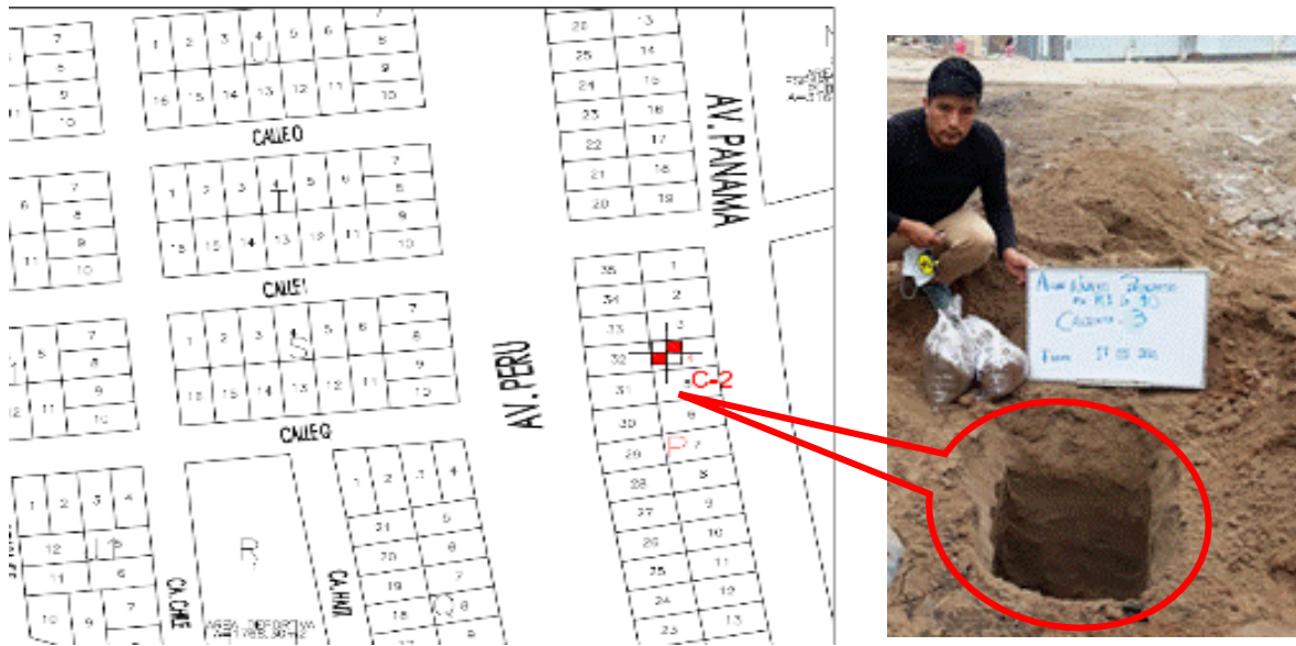
Figura 30. Ubicación de la calicata N° 02 - Mz P, Lote 4
