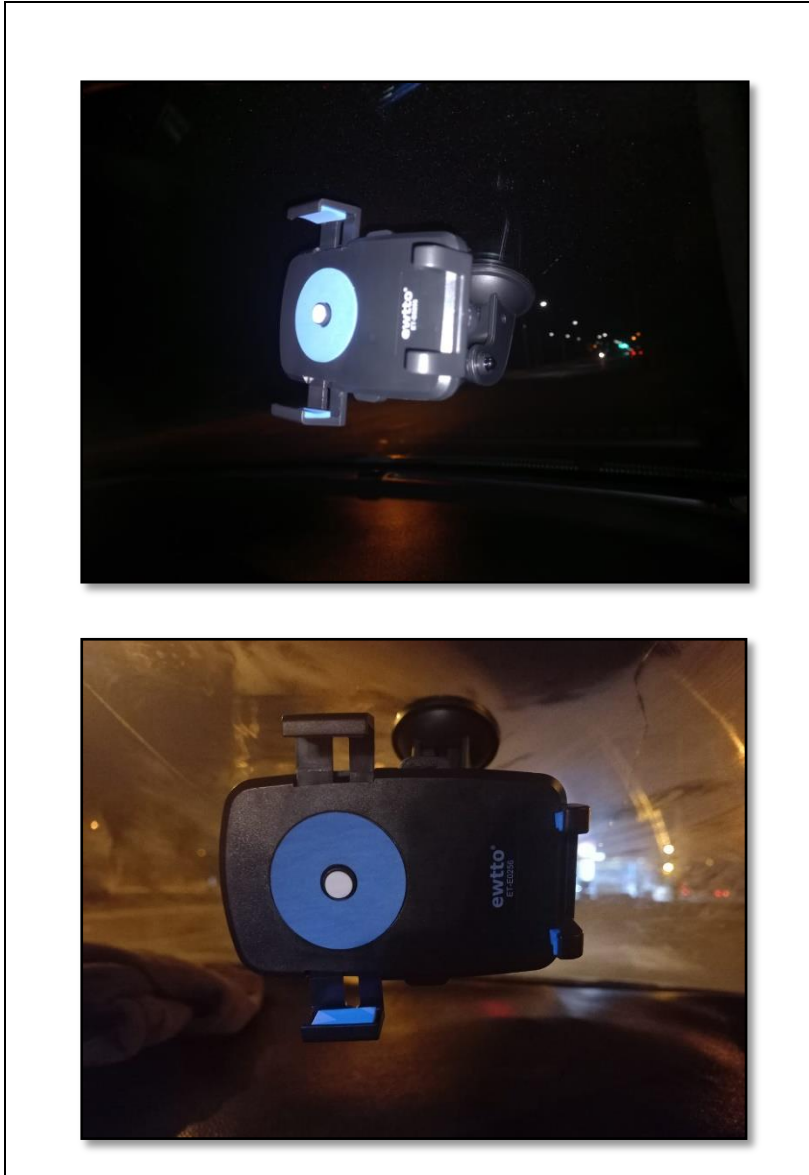
Figura 50. Instalación de sujetador en parabrisas del vehículo.
