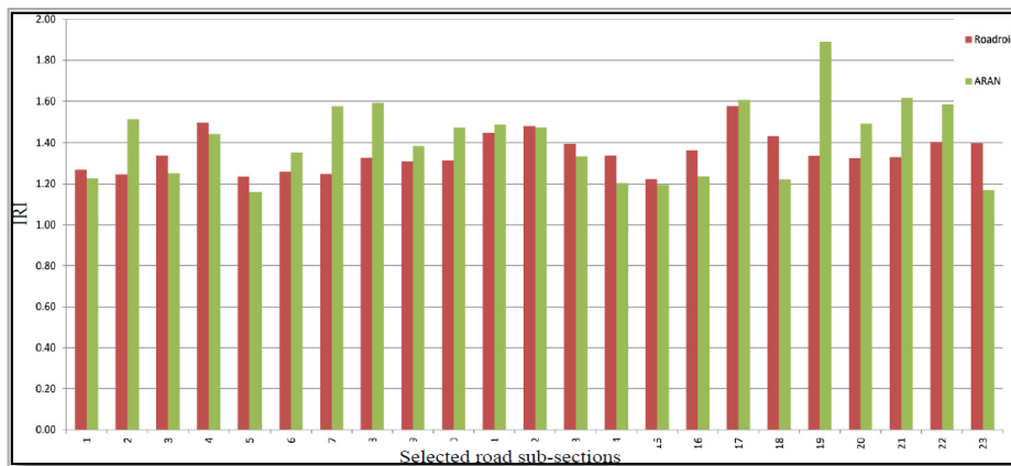
Figura 8. Comparación de perfiles de Roadroid con otra herramienta. Fuente: Latorre, 2018.
